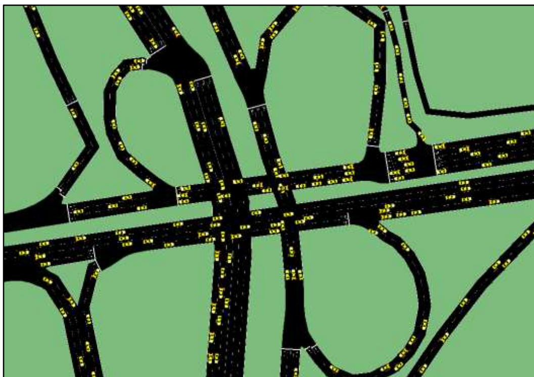
Figura N° 10: Extracto de simulación en SUMO. Elaboración propia.
