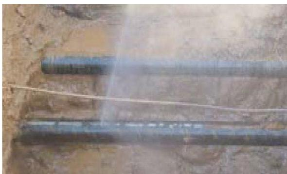
**Figura 78.** Fuga de combustible por falla, refinería en Estados Unidos.
