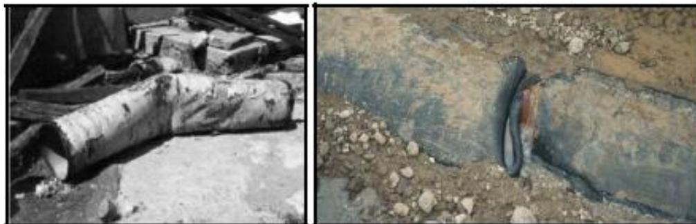
**Figura 76.** Fallas de líneas de conducción continuas en refinería Izmit.
