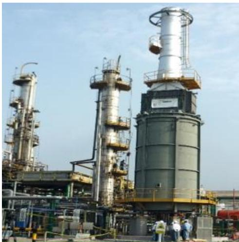
**Figura 22.** Horno de Unidad de Destilación Primaria.
