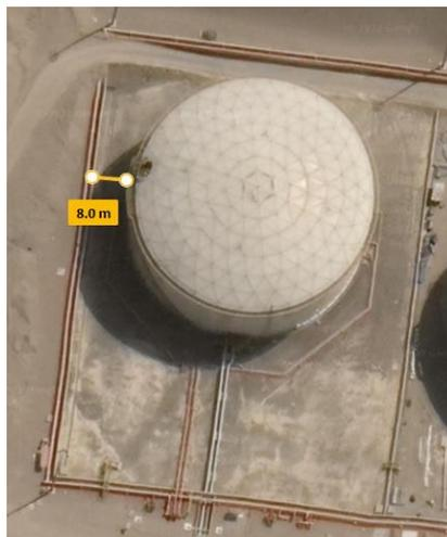
**Figura 74.** Distancia mínima entre tanque y muro de contención de zona estanca.
