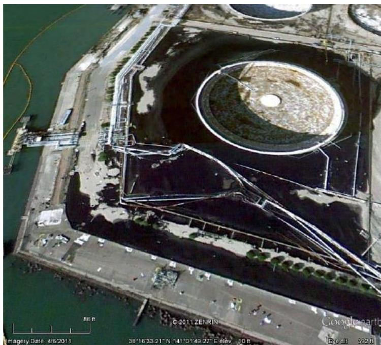
**Figura 95.** Derrame de crudo debido a tsunami en tanque dañado, refinería Sendai.
