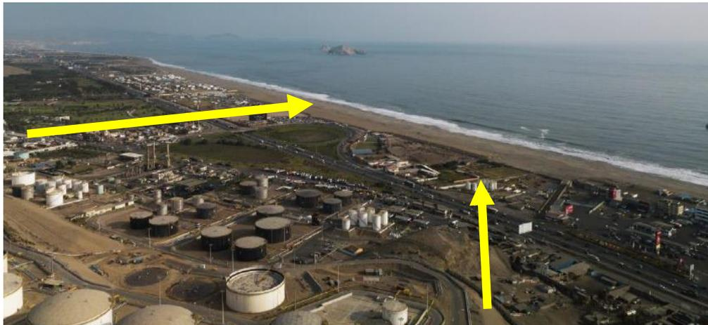
**Figura 107.** Sentido de derrame en caso de colapso de tanques.
