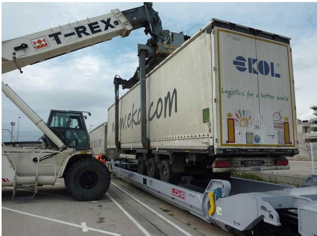
**Figura N° 10.** Compatibilidad con la carga/descarga vertical, Lohr industries, 2020
