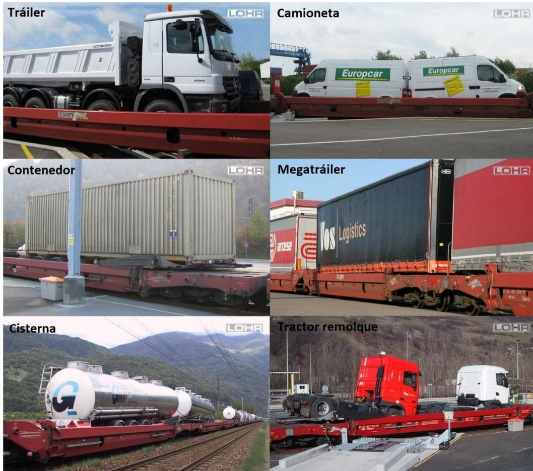
Figura N° 11. Tipos de carga con el sistema Modalohr, Lohr industries, 2020.
