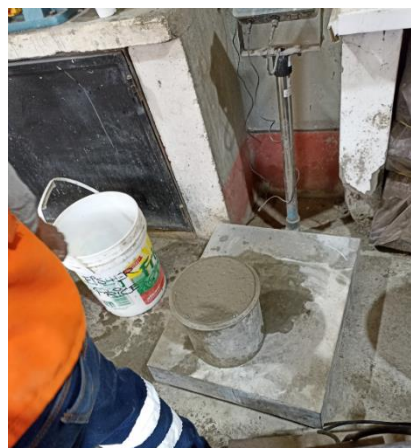
Figura 4.7 Realización del ensayo de peso volumétrico de la muestra de concreto
