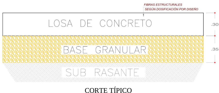
Figura 1.3: Detalles del corte de losa para las mezclas de concreto con fibras acero y de concreto con fibras macrosintéticas.
