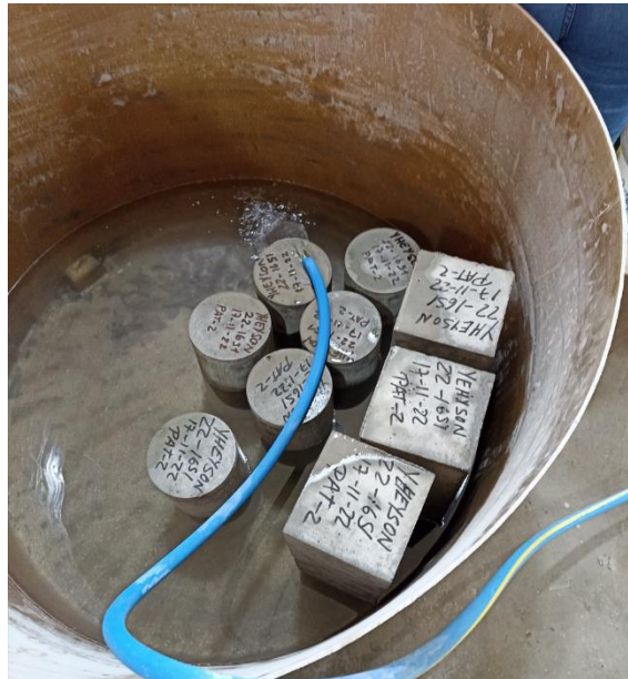
Figura 4.5 Colocación de las muestras de concreto en su proceso de curación
