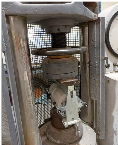
Figura 4.8 Realización del ensayo a compresión diametral a la muestra de concreto
