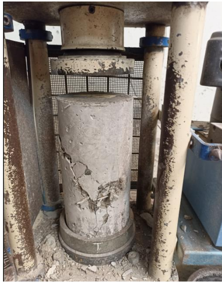
Figura 4.9 Realización del ensayo a compresión a la muestra de concreto
