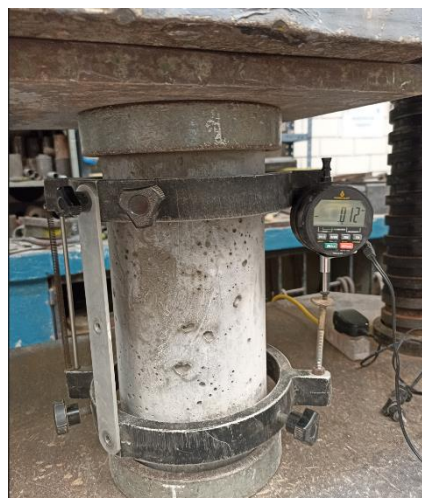
Figura 4.10 Realización del ensayo de módulo de elasticidad a la muestra de concreto
