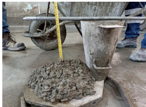
Figura 4.6 Realización del ensayo de trabajabilidad y consistencia por cono de Abrams
