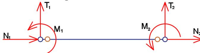
$$f_R^l = \begin{bmatrix} 0 \\ T_1 \\ M_1 \\ 0 \\ T_2 \\ M_2 \end{bmatrix} = - \begin{bmatrix} 0 & 0 \\ \frac{6EI}{L^2} & \frac{6EI}{L^2} \\ \frac{4EI}{L} & \frac{2EI}{L} \\ 0 & 0 \\ \frac{6EI}{L^2} & \frac{6EI}{L^2} \\ -\frac{2EI}{L} & \frac{4EI}{L} \end{bmatrix} \begin{bmatrix} \theta''_1 \\ \theta''_2 \end{bmatrix}$$
