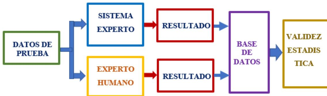
**Figura 4.18** Diagrama de Validación del funcionamiento del Sistema Experto
