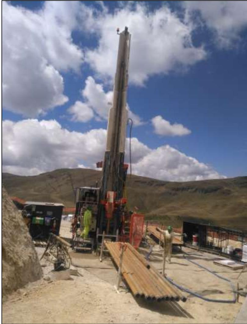
Figura 2.9 Plataforma y tubos de perforación diamantina
