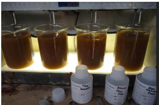
Foto N°5: Muestras de agua mina a diferentes determinando los floculantes adecuados
