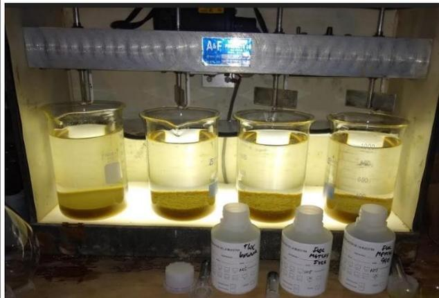
Foto N°4: Muestras de agua de mina tratada sedimentada con diferentes floculantes
