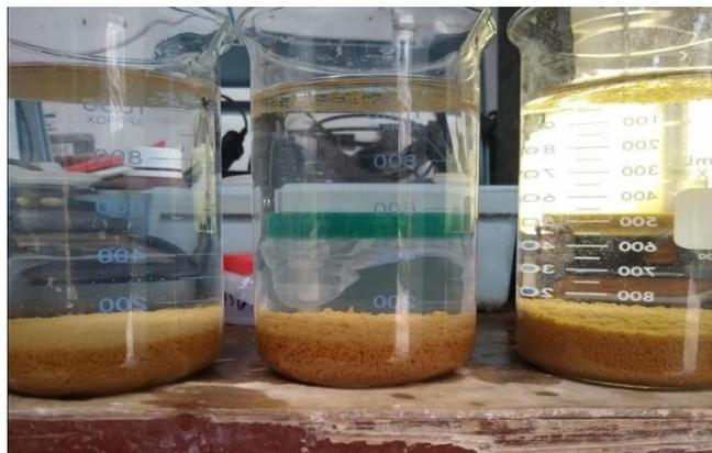
Foto N°6: De izquierda a derecha: Superfloc (actual), Arenas AR 1032 y Arenas 5240, después de la dosificación de floculantes y sedimentación, se aprecia mejor compactación y mayor tamaño de flocs del floculante AR 1032.
