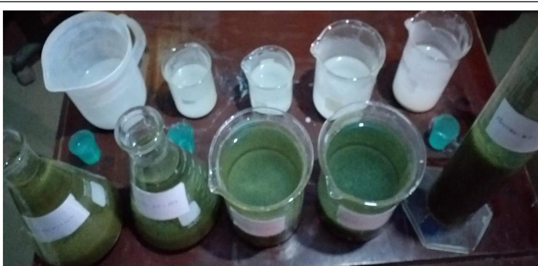
Fotografía 2. Lodos generados en las pruebas N°01, 02, 03, 04 y 05 a diferentes puridades de hidróxido de calcio  $\text{Ca}(\text{OH})_2$
