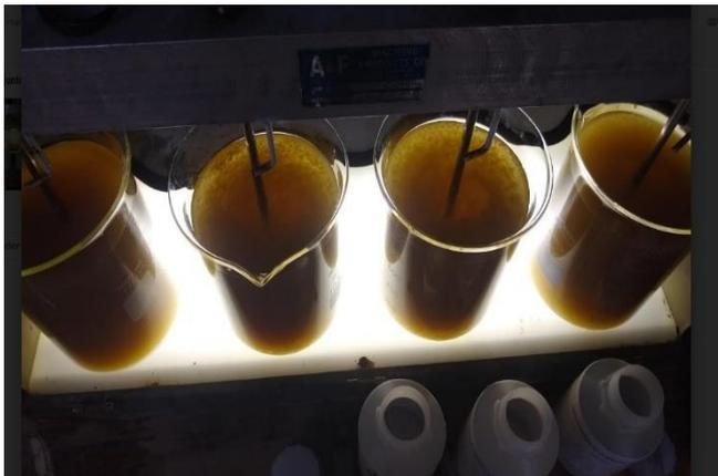
Foto N°3: Muestras de agua de mina con diferentes floculantes en formación de flocs.
