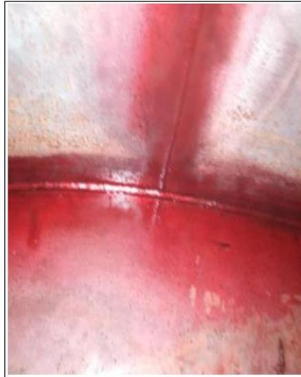
Se realizó la aplicación de liquido penetrante a cordón de soldadura entre shell y fondo del tanque parte interna.
