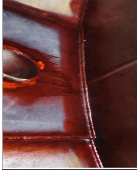
Se realizó la aplicación de liquido penetrante al cordón de soldadura entre shell y fondo del tanque parte interna.
