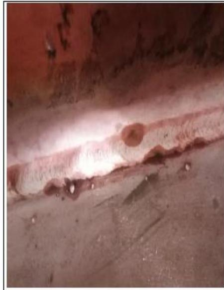
Se evidencia socavaciones en zonas puntuales y salpicaduras de soldadura.
