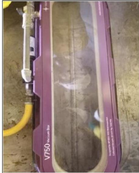
Se realizó la prueba de vacío al cordón #3 en el fondo del tanque, no se evidencia indicaciones relevantes
