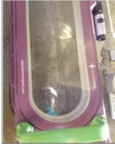
Se realizó la prueba de vacío al cordón #3 en el fondo del tanque
