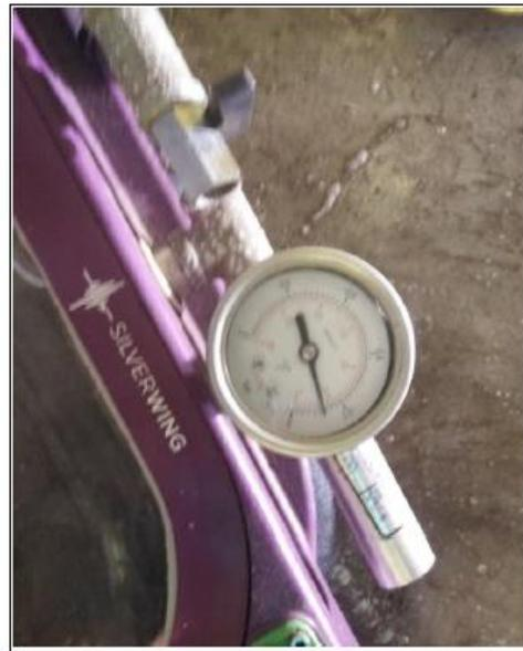
Se realizó la prueba de vacío al cordón #1 en el fondo del tanque, no se evidencia indicaciones relevantes
