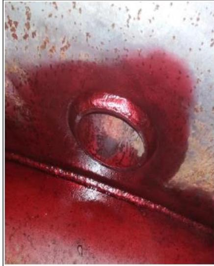
Se realizó la aplicación de liquido penetrante al cordón de soldadura del man hole y tubería de descarga en la parte interna del tanque.
