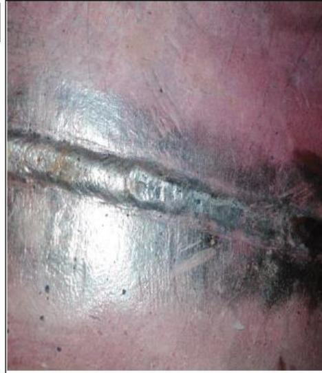
Se observa mal procedimiento de soldadura en el cordón central del fondo del tanque parte interna reportándose para su inmediata reparación.
