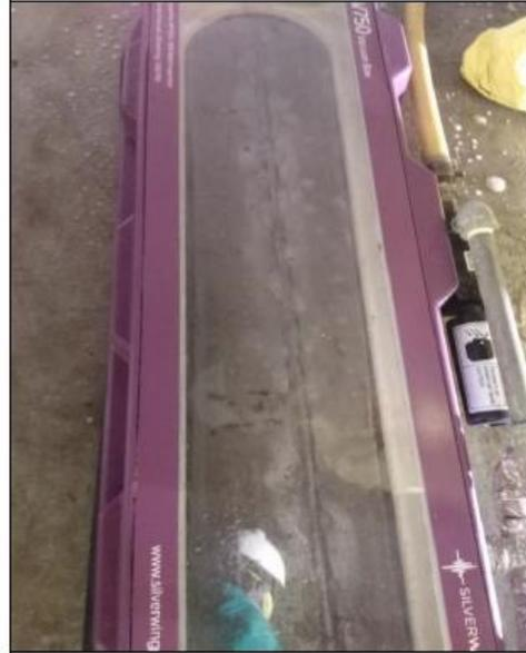
Se realizó la prueba de vacío al cordón #1 en el fondo del tanque
