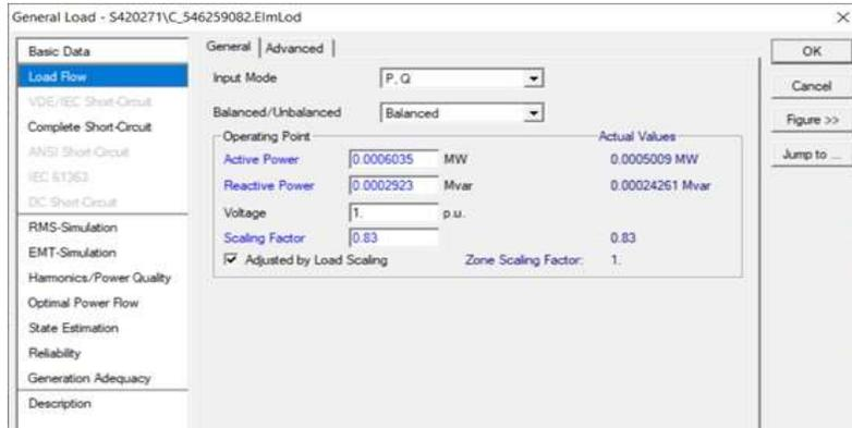
Figura 62. Características de la carga uniformemente distribuida en la red de BT.
