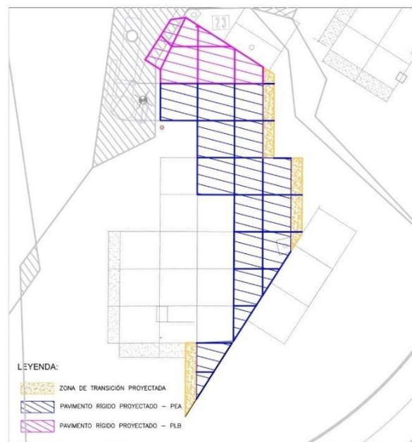
Figura N° 10: Sectores del pavimento a reparar en el PEA – 23.
