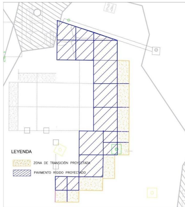
Figura N° 11: Sectores del pavimento a reparar en el PEA – 24.
