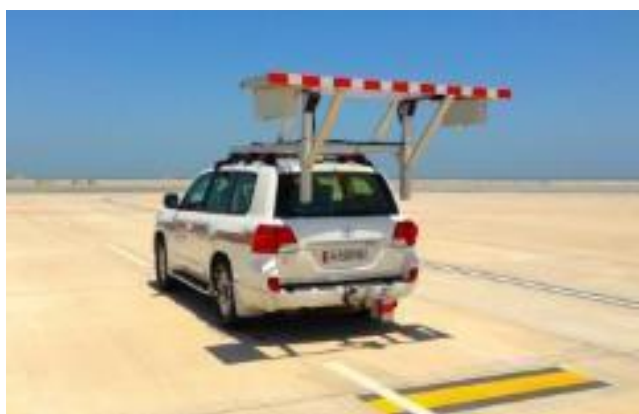
Medición de PCI
