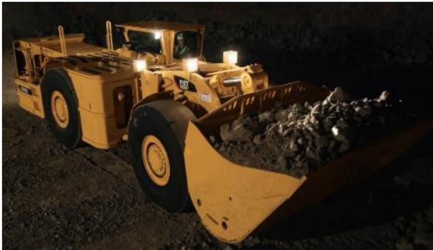
**Figura 3.1. Cargador de Bajo perfil R1600G**
