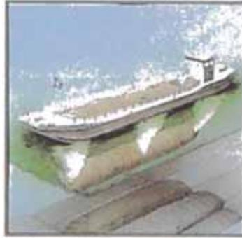
**Figura N° 3.5.- Esquema de un geocontenedor. Fuente Manual de Ten Gate**
