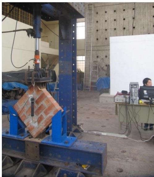
Figura 18. Ensayo de tracción diagonal
