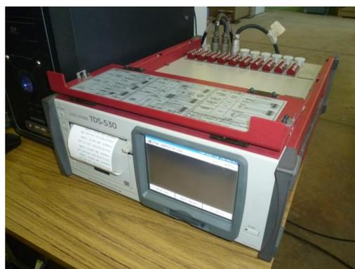
Sistema de adquisición de datos
