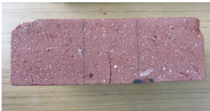
Figura 14 Fisura en ladrillo
