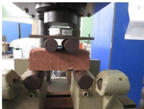
Figura 13 Esquema del ensayo de flexión
