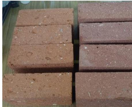
Figura 12 Unidades para ensayo de flexión
