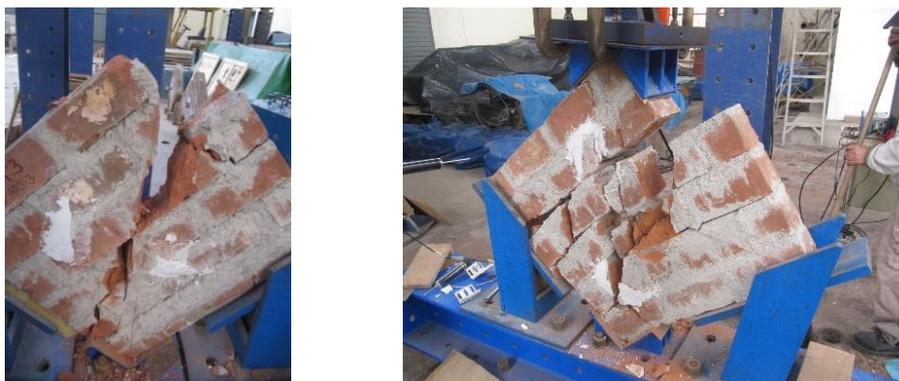
Fallas en muretes: (a) por tracción diagonal y (b) tracción diagonal y escalonada.
