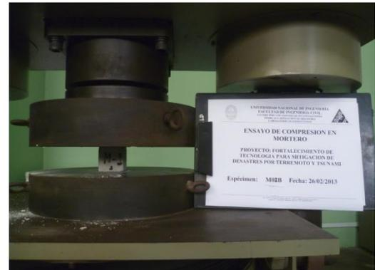
Ensayo de compresión en cubos de mortero
