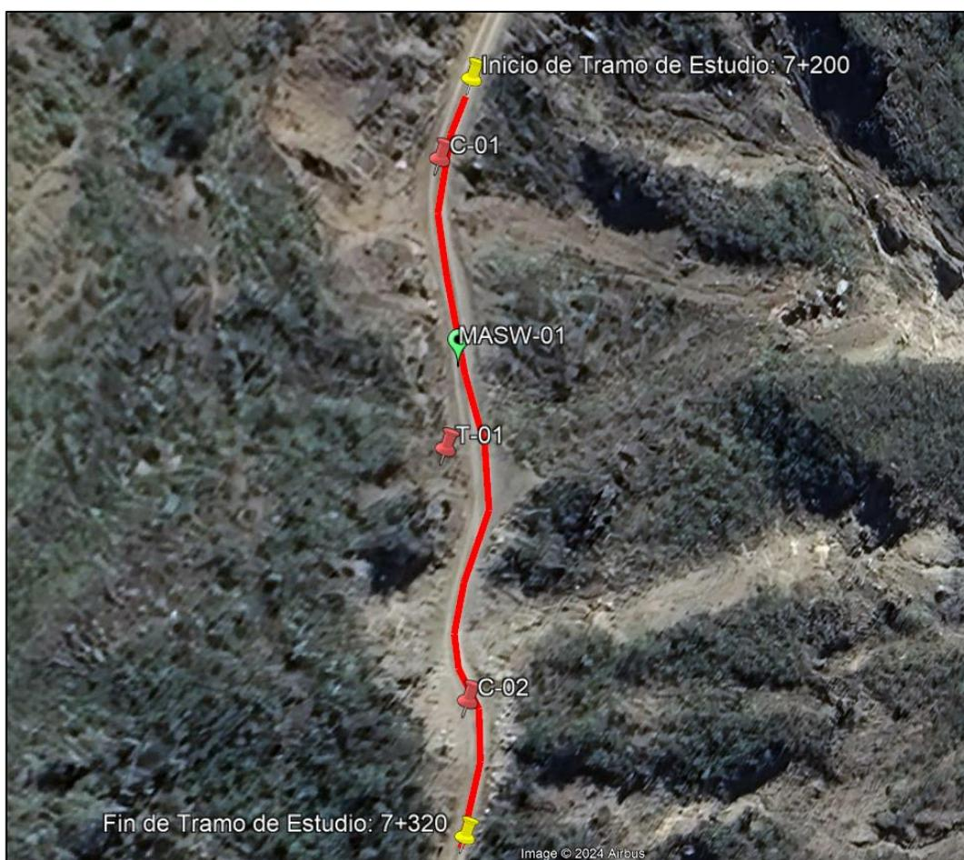
Figura N°4. Investigaciones geotécnicas proyectadas
