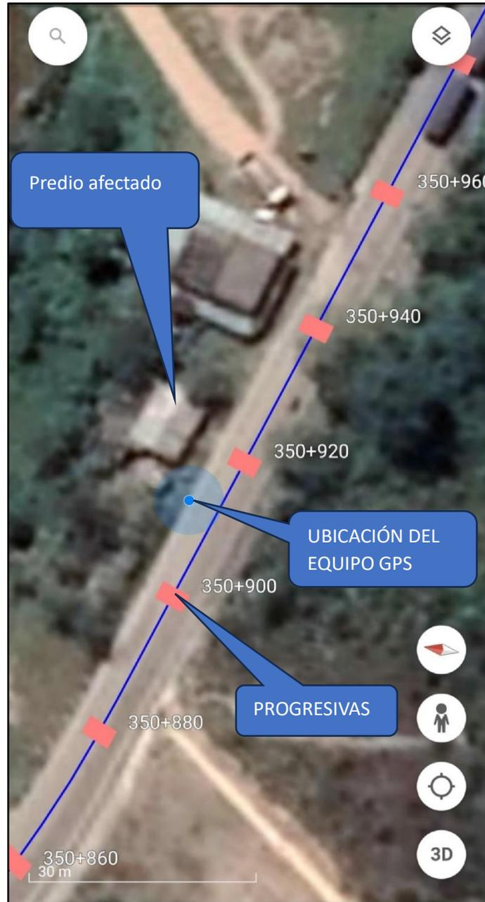
Figura N° 4: Imagen de la visualización de la pantalla del equipo GPS submétrico donde se visualiza la posición del equipo con respecto de las progresivas.
