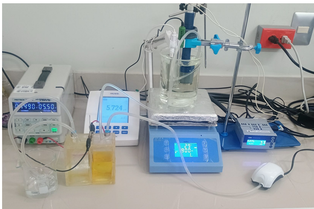
Figura XXV: Implementación del sistema de producción de ClO 2 (a escala de laboratorio).
