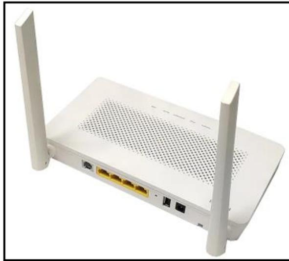
*Nota:* Figura muestra la ONT, este se ubica dentro de los domicilios de los abonados y hace función de un router. Fuente: tomado de Alibaba (2020)
