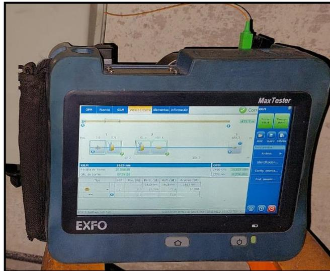
*Nota:* se muestra la medición reflectométrica con el OTDR de una red óptica.
