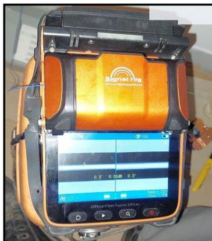
*Nota:* se muestra la fusión de dos hilos de fibra óptica.
