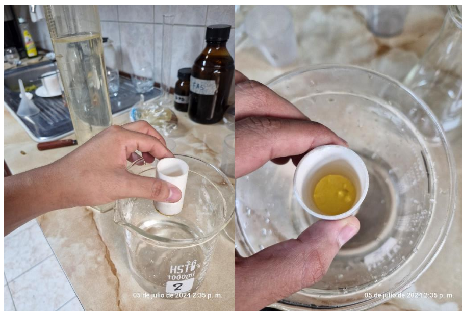
FIGURA XXVI. Filtración de muestra para posterior conteo de algas.
