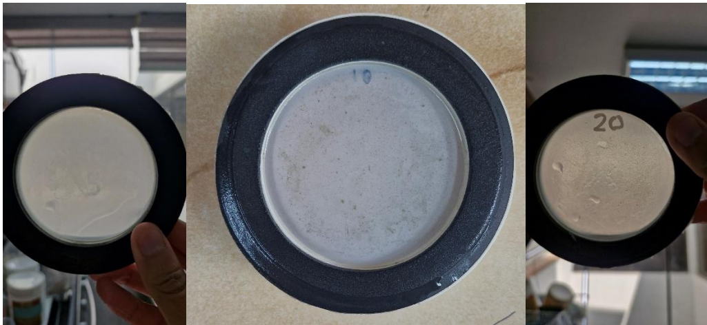
FIGURA XXVIII. Microtamices 5,10 y 20 posterior a filtración.
