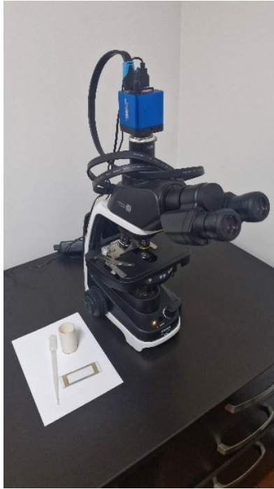
FIGURA XXIX. Microscopio vertical (cámara incluida) y kit para conteo de algas.
