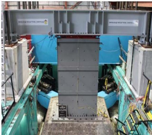
Figura N° 13 Ensayo a escala real de un Muro de fluido viscoso (Fuente: DIS)
