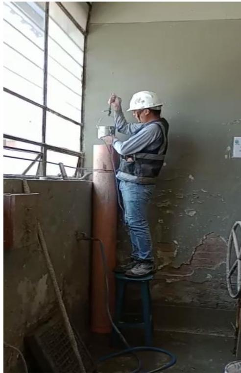
**Figura A5. 5:** Ensayo para determinar la resistencia del concreto recién mezclado al lavado con agua.
