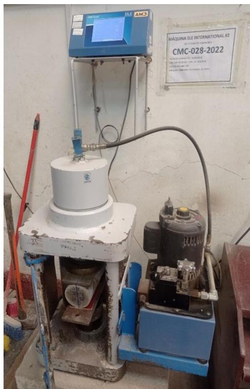
**Figura A5. 13:** Ensayos de resistencia a la tracción diametral.
