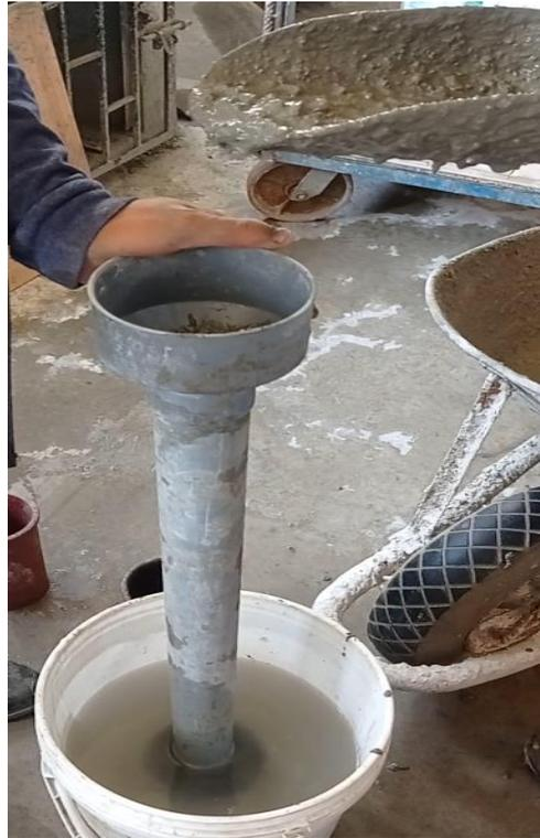
**Figura A5. 7:** Vaciado de concreto bajo el agua mediante el método tremie.
