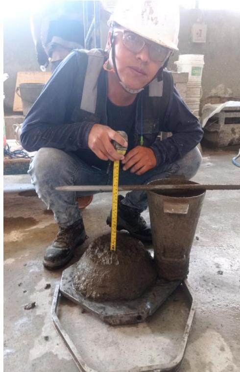
Figura A5. 1: Asentamiento del concreto patrón.
