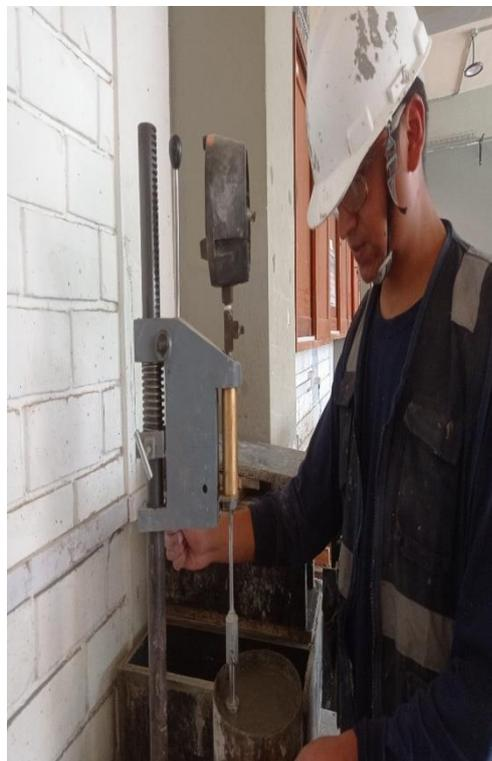
**Figura A5. 6:** Ensayo de tiempo de fragua por medio de la resistencia de penetración.
