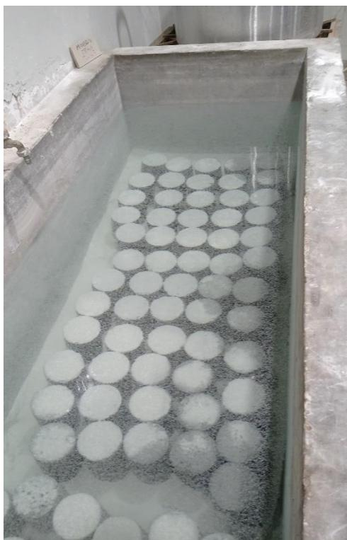
**Figura A5. 10:** Muestras en la poza de curado para su posterior ensayo de resistencia a la compresión y tracción diametral.
