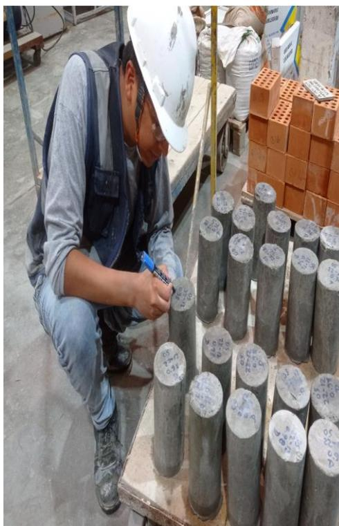
**Figura A5. 9:** Marcado de muestras para ensayos de resistencia a la compresión axial y tracción diametral.
