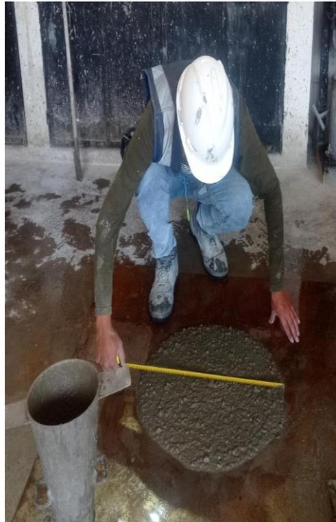
**Figura A5. 3:** Medición del diámetro del ensayo de fluidez de asentamiento.
