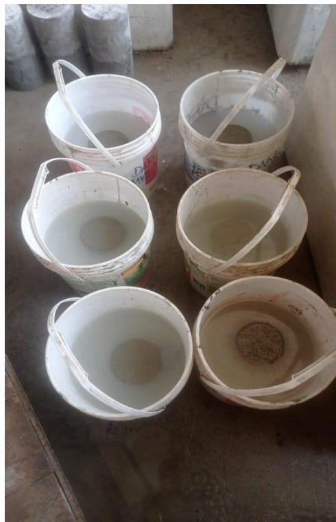
**Figura A5. 8:** Probetas de concreto con aditivo vaciadas bajo agua.
