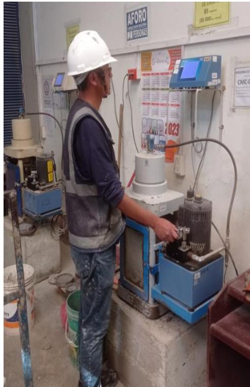
**Figura A5. 12:** Ensayos de resistencia a la compresión axial.
