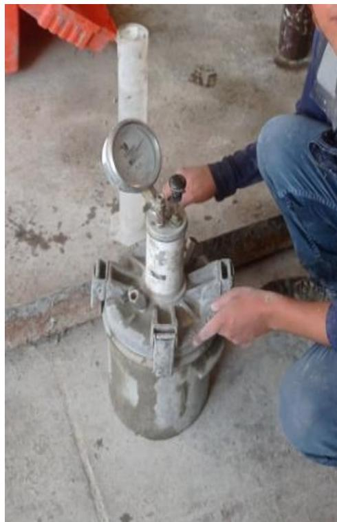
**Figura A5. 4:** Ensayo de contenido de aire.
