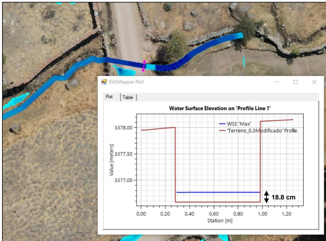
Figura 61: Tirantes de calibración en la alcantarilla de referencia
