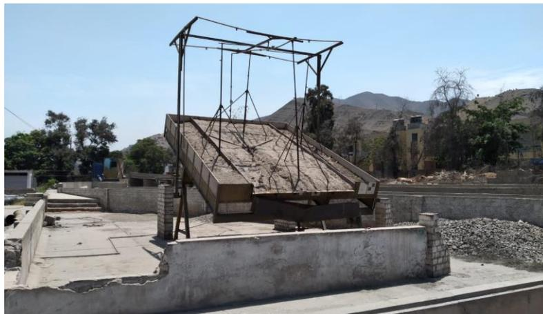
Figura 24: Modelo de simulador de lluvia del LNH
