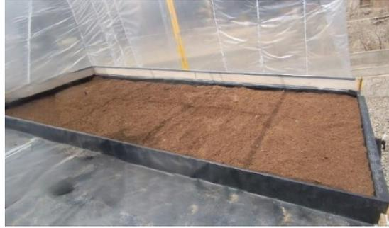
Figura 30: Sustrato de crecimiento de techo verde extensivo.
