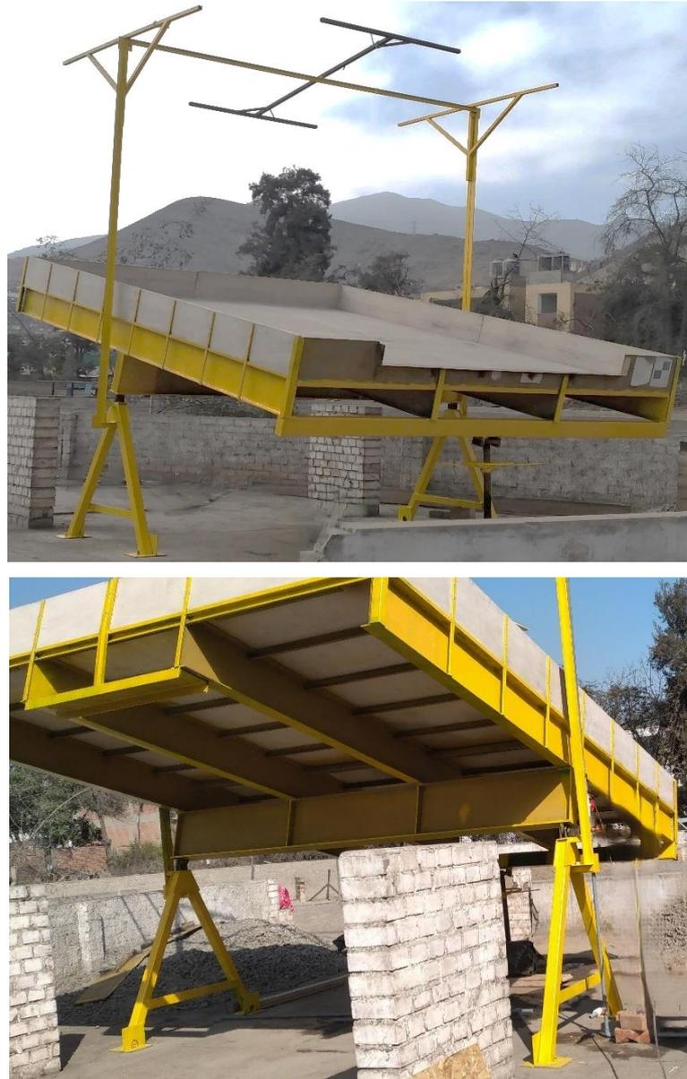
Figura 26: Soporte estructural del modelo experimental.
