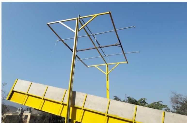
Figura 41: Distribución de boquillas de aspersion
