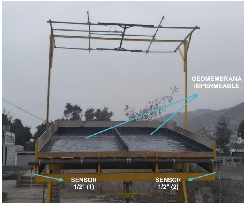
Figura 47: Configuración de plataforma para calibrar la intensidad
