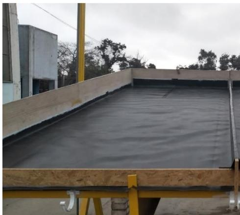
Figura 38: Capa impermeable, Membrana de HDPE de 1 mm.
