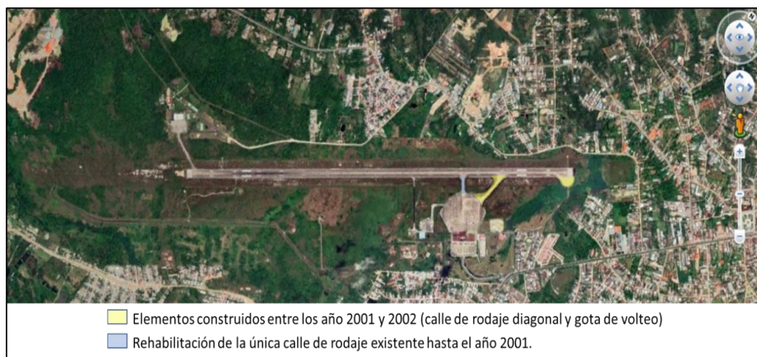
Figura N° 1. Elementos que fueron rehabilitados y construidos durante los años 2001-2003 en el Aeropuerto de Iquitos.
