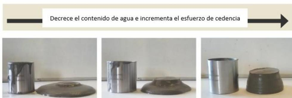
Figura N°11: Comportamiento del flujo con respecto al contenido de agua
