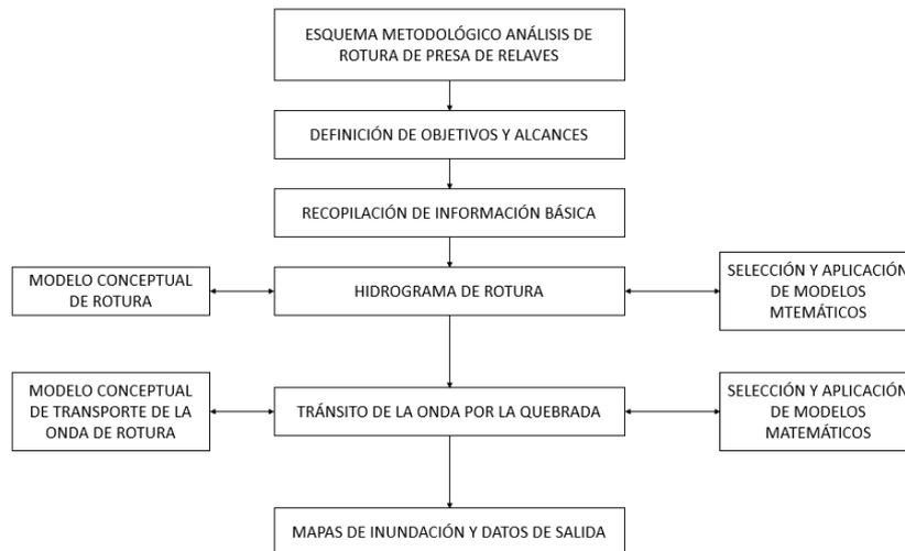
Figura N°12: Esquema metodológico para el análisis de rotura de presas utilizado por Quisca y adoptado por la COPEGP en 2018
