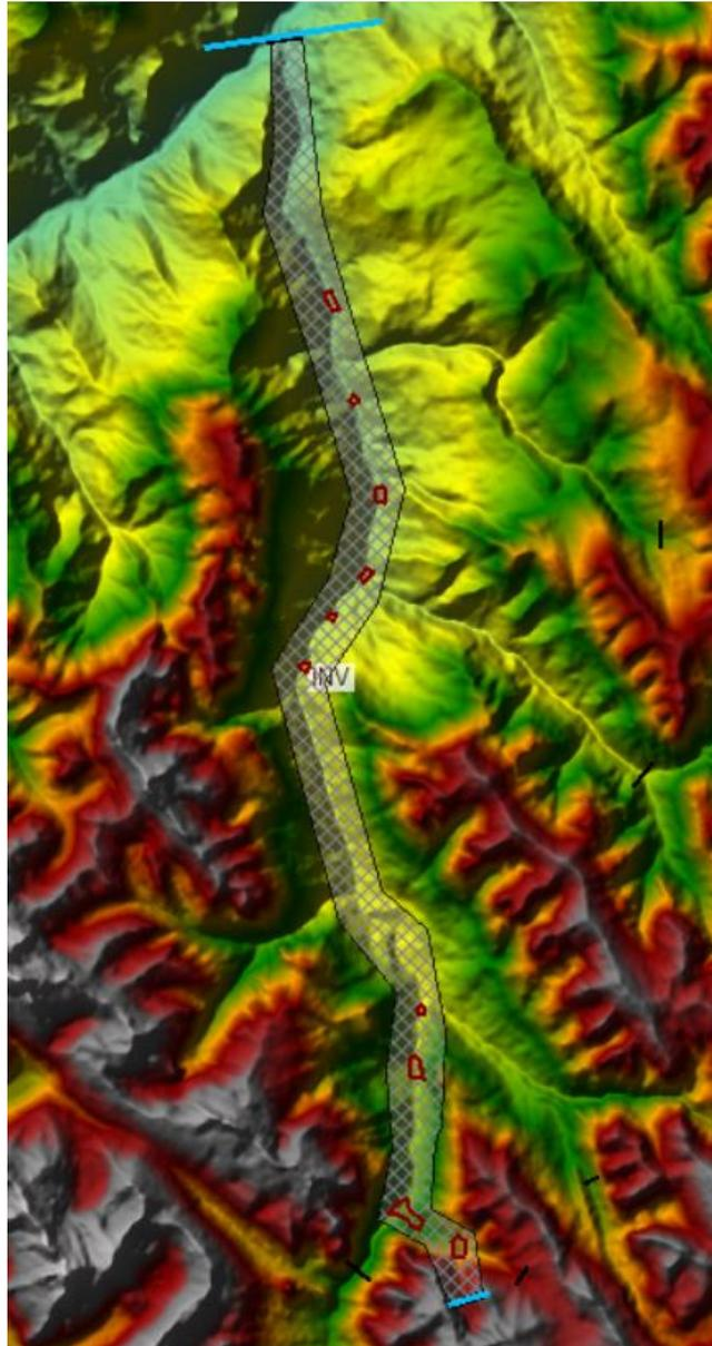
Figura N°28: Modelo HEC-RAS de análisis de rotura de presa de relaves
