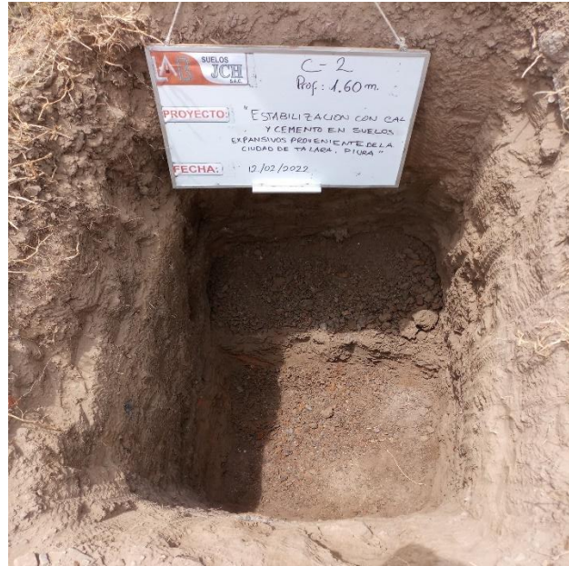
Figura N°8: Vista de perfil de la C-2. Se encontró material arcilloso Fuente: Elaboración Propia
