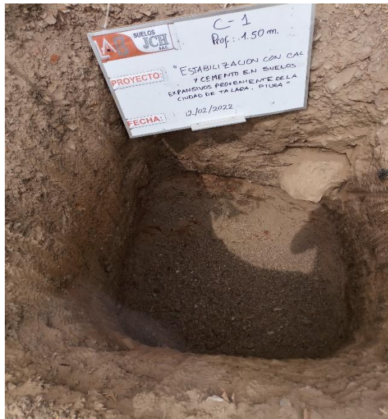
Figura N°6: Vista de perfil de la C-1. Se encontró material arcilloso Fuente: Elaboración Propia
