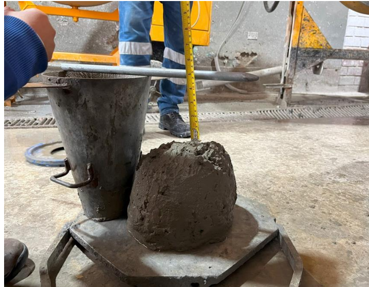
Figura N°19: Asentamiento del concreto
