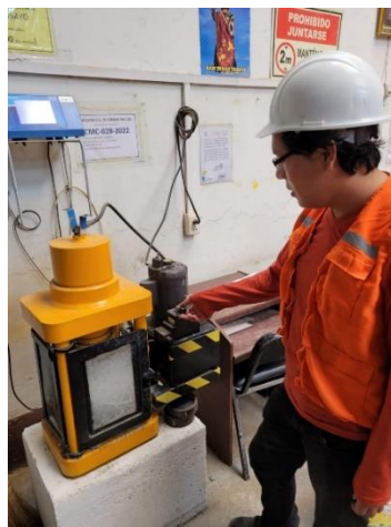
Figura N°22: Ensayo de compresión del concreto
