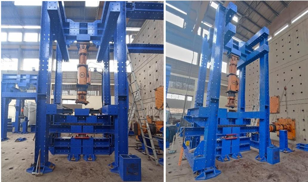
Figura N° 4.7 Ensamble del Mecano de Ensayo Cuasi-Estático del Aislador
