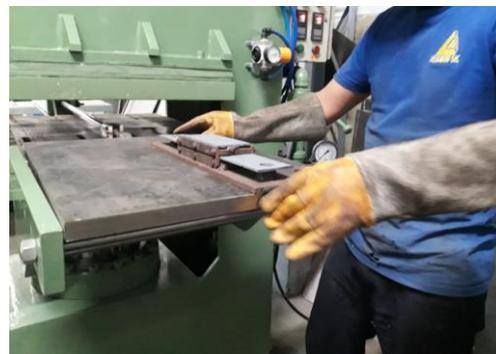
Figura N° A.7 Colocado de las placas rígidas a la matriz de vulcanizado
