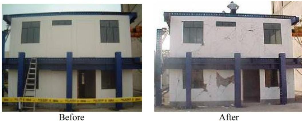
Figura N° 3.11 Ensayo cíclico unidireccional de una vivienda representativa de albañilería informal
