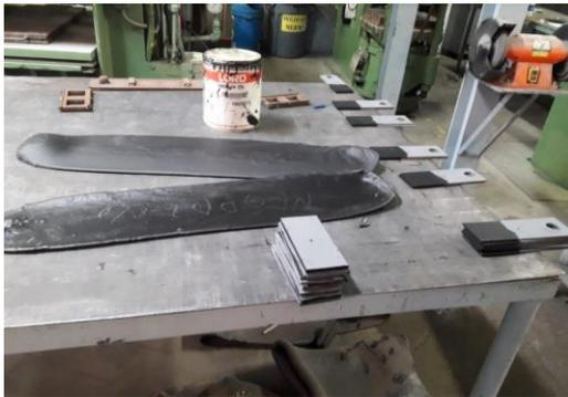
Figura N° A.4 Planchas de material elastómero
