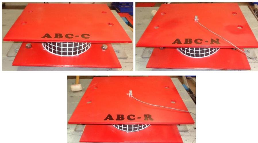
Figura N° 4.5 Prototipos de Aislamiento Sísmico de Bajo Costo
