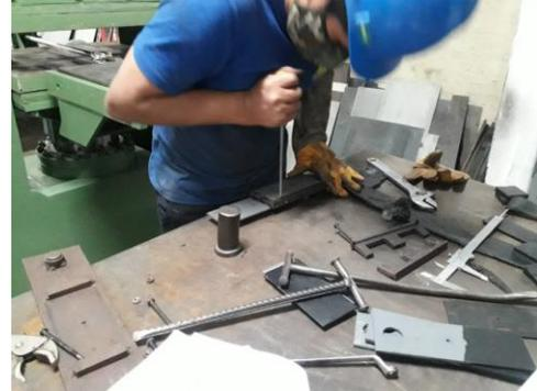
Figura N° A.9 Desmoldaje de la matriz de vulcanizado
