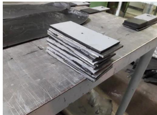
Figura N° A.2 Cubierta de adhesivo “Chemlok220”
