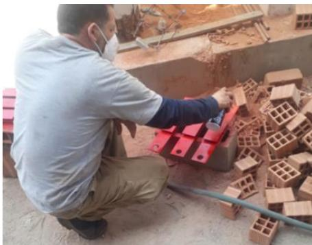
Figura N° A.12 Pintado de especímenes de módulo de corte.
