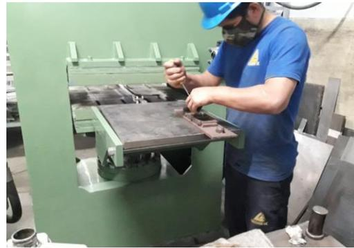
Figura N° A.5 Recorte y cubierta de la primera capa de material elastómero
