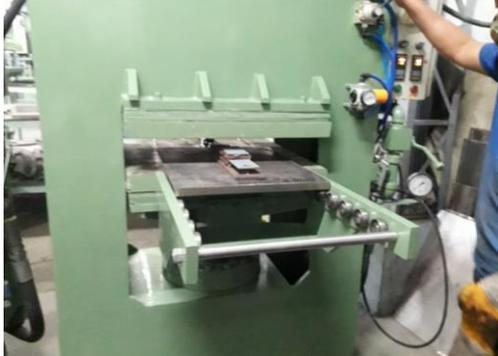
Figura N° A.8 Vulcanizado de espécimen de módulo de corte
