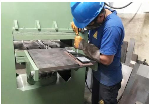
Figura N° A.6 Colocado de la segunda capa de material elastómero
