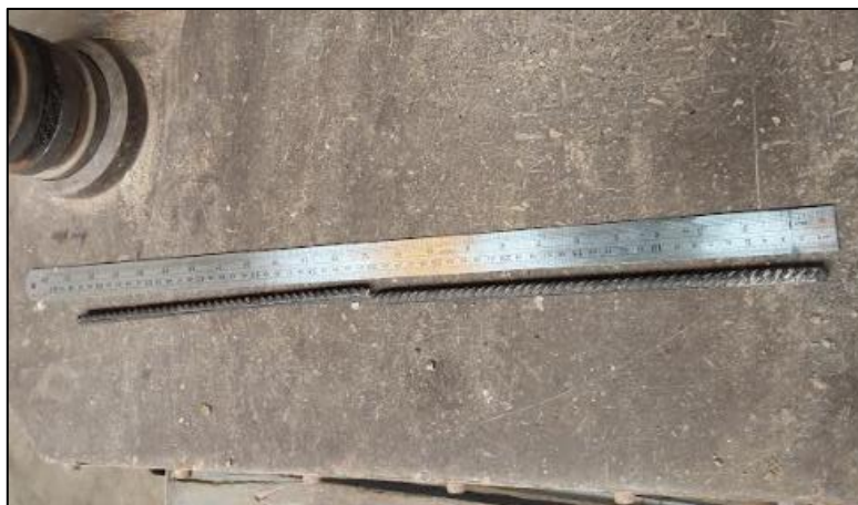
Fotografía N° 1 Muestra de acero de 3/8" no acondicionada ensayada a tracción
