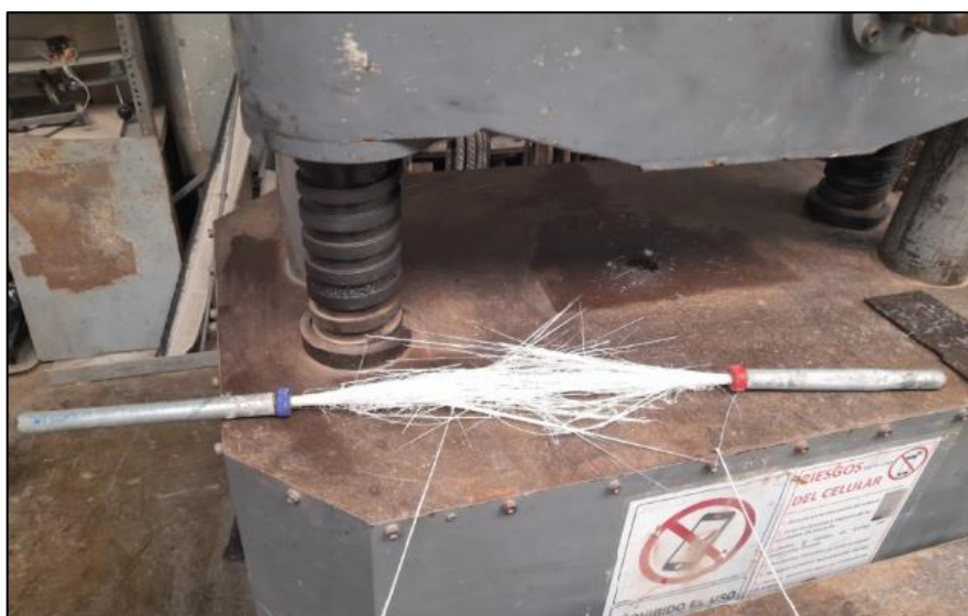
Fotografía N° 5 Muestra ensayada a tracción de la varilla de polímero reforzada con fibra de vidrio (PRFV)
