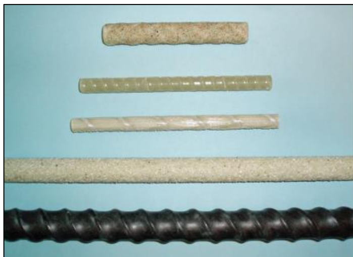
Figura N° 8: Tipos de varillas de refuerzo de PRF. Fuente. ACI 440.1R (2015)
