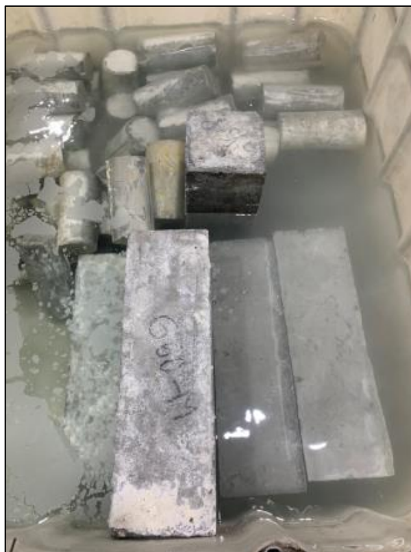
Fotografía N° 6 Probetas y vigas durante el periodo de curado húmedo
