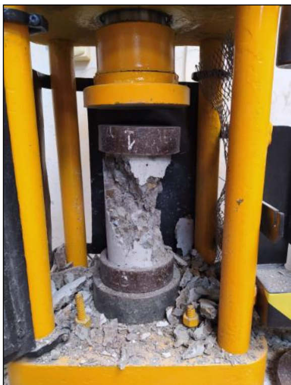
Fotografía N° 7 Ensayo a la compresión de las probetas del concreto con agua de mar.
