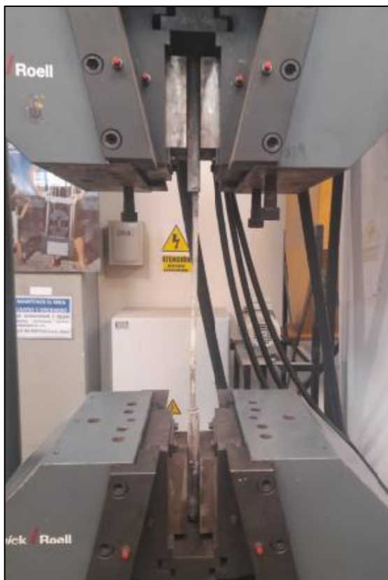
Fotografía N° 4 Ensayo a la tracción de las varillas de polímero reforzadas con fibra de vidrio (PRFV)
