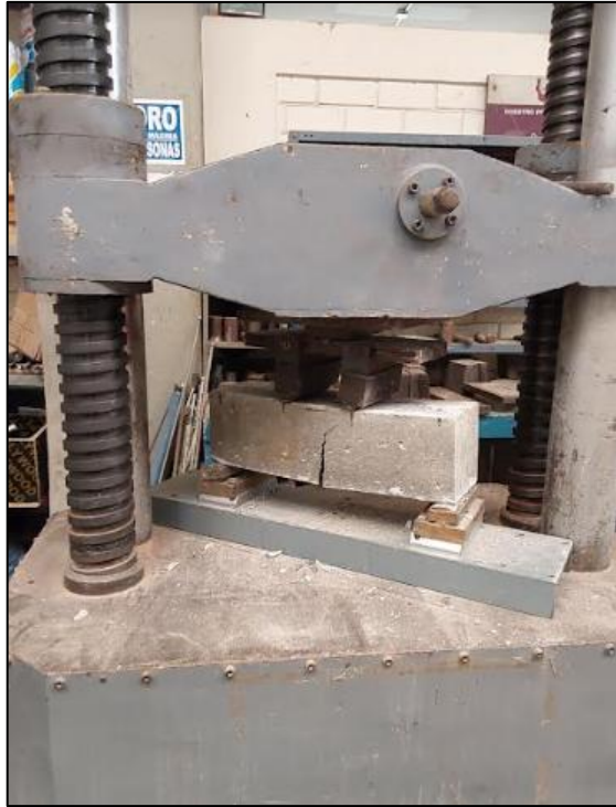
Fotografía N° 8 Ensayo a flexión de las vigas
