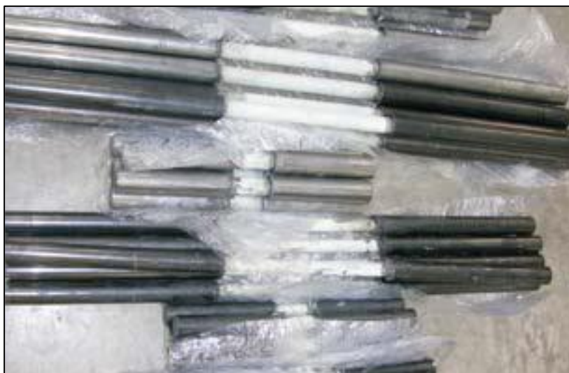
Figura N° 18: Muestras elaboradas de PRFV para el ensayo a tracción.
