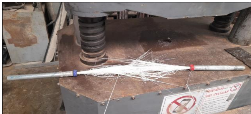
Figura N° 40: Modo de falla de las varillas de polímero reforzados con fibra de vidrio (PRFV)
