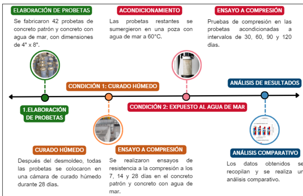
Figura N° 26: Metodología del análisis de las propiedades de resistencia a la compresión del concreto
