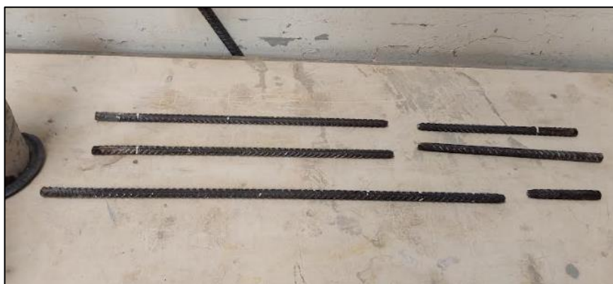
Fotografía N° 2 Muestras de acero de 3/8" ensayadas a tracción luego de un periodo de 30 días bajo acondicionamiento acelerado
