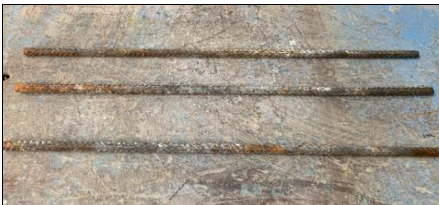
Fotografía N° 3 Muestras de acero luego del periodo de 120 días de acondicionamiento acelerado
