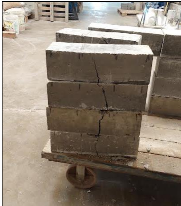
Fotografía N° 9 Muestras de vigas ensayadas
