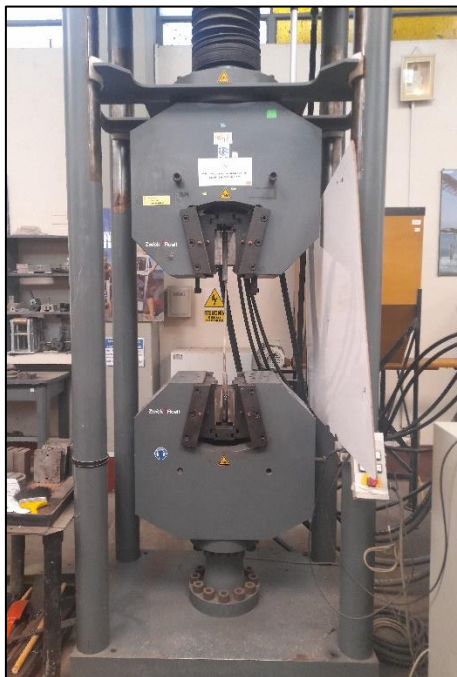
Figura N° 16: Máquina de ensayo universal para ensayo a tracción - LEM UNI.
