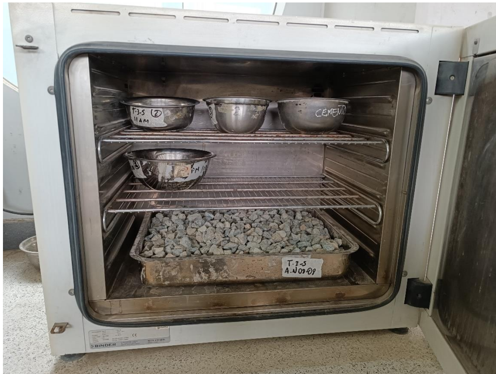
Figura C7: Muestras de agregado grueso y fino en el horno para ensayo de contenido de humedad Fuente: Elaboración propia
