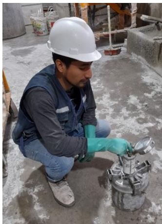
Figura N°17: Ensayo de contenido de aire en el concreto fresco
