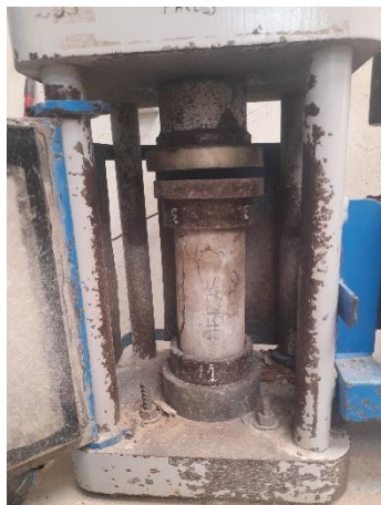
Figura N°20: Ensayo de resistencia a la compresión en el concreto endurecido
