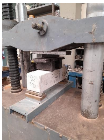
Figura N°22: Ensayo de resistencia a la flexión en el concreto endurecido
