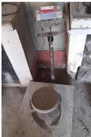
Figura N°16: Ensayo de peso unitario en el concreto fresco
