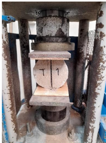
Figura N°21: Ensayo de resistencia a la tracción por compresión diametral en el concreto endurecido
