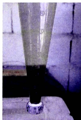
Fotografía N° 15 Sólidos Sedimentables de 1 semana en el sedimentador
