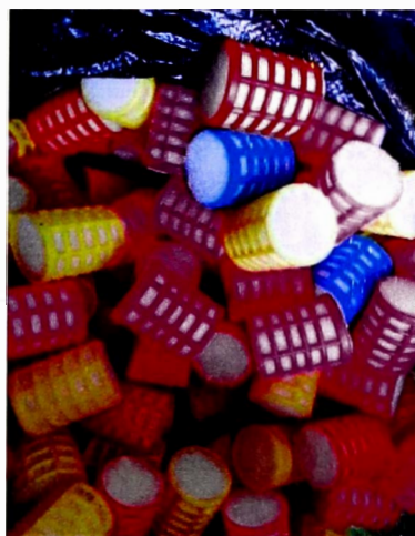
Fotografía N° 6 Esponjas de poliuretano en portador de PVC
