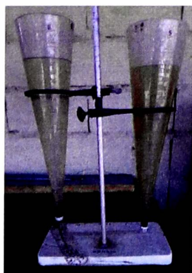
Fotografía N° 15 Sólidos Sedimentables de 1 semana en el sedimentador
