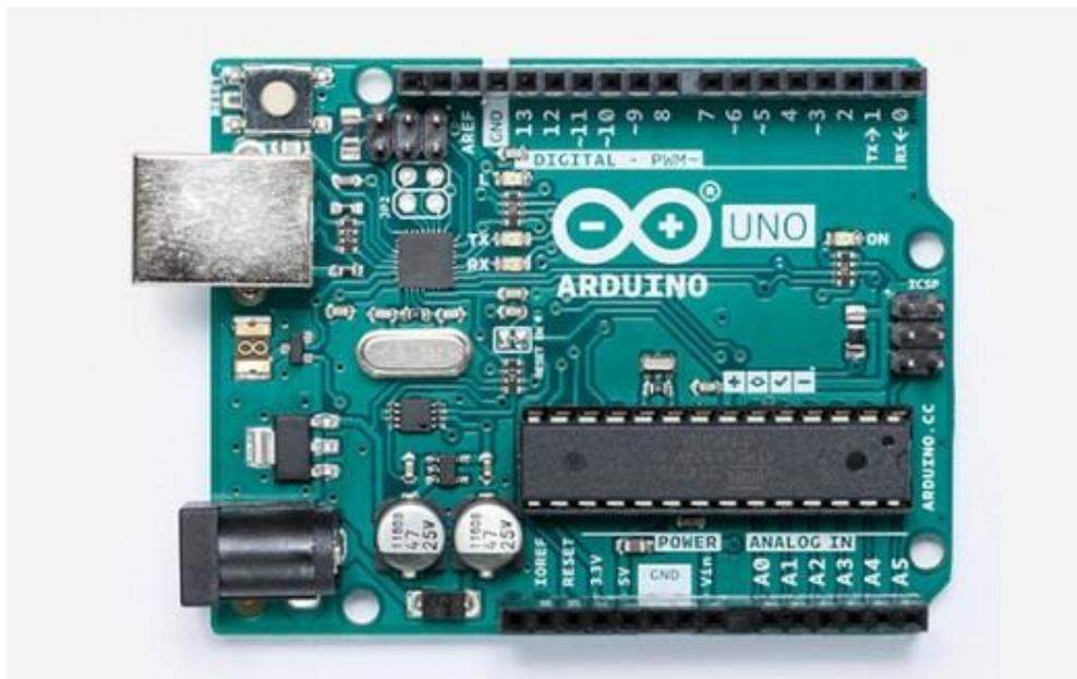
Figura N° 12. Arduino UNO.
