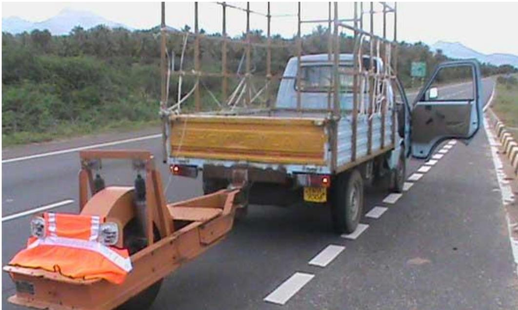
Figura N° 6. Bump Integrator colocado detrás de un vehículo.
