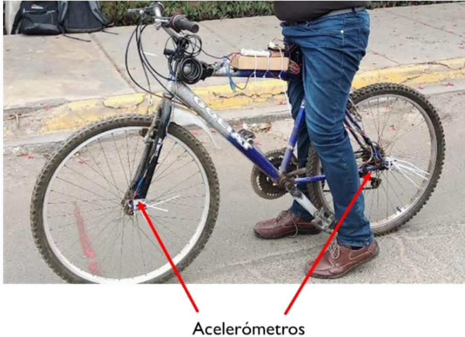
Figura N° 41. Ubicación de acelerómetros en la bicicleta.
