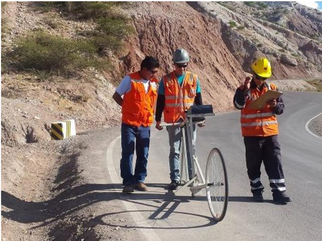
*Figura N° 5. Midiendo la rugosidad con el MERLIN.*
