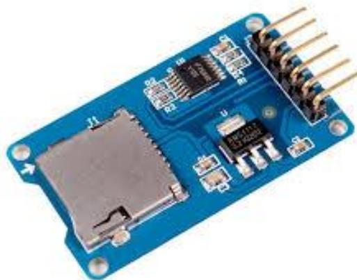
Figura N° 23. Módulo lector de micro SD.
