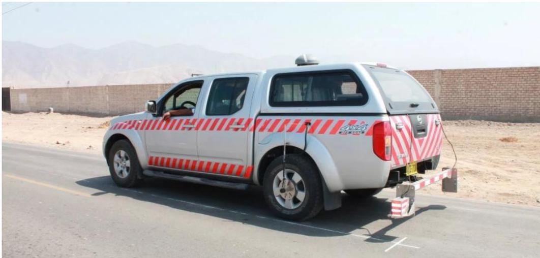
Figura N° 3. Perfilómetro Láser. Instrumento de Clase 1.
