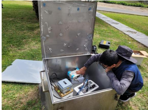
La **Figura 21** muestra la instalación final del equipo en la mayoría de las estaciones, donde los sensores se fijaron sobre una base rígida de concreto. Los acelerógrafos MITUTOYO fueron asegurados mediante un perno en la base, mientras que el sismógrafo SERCEL se fijó utilizando un adhesivo especial.
