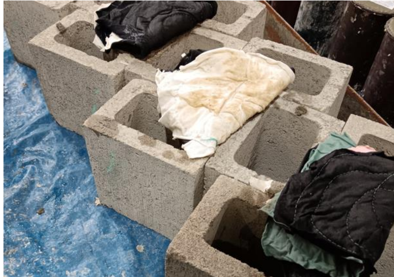
Figura N° 32: Testigo de grout cubierto con paños húmedos (Nota: Fotografía propia)
