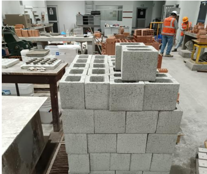
Figura N° 2: Bloques de concreto alveolares fabricados por UNICON utilizados en esta investigación (Nota: Fotografía propia)
