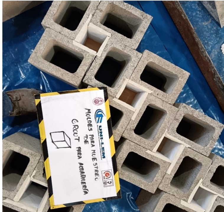
Imagen 9. Moldes absorbentes para muestreo de testigos de grout prismáticos (Nota: Fotografía propia)
