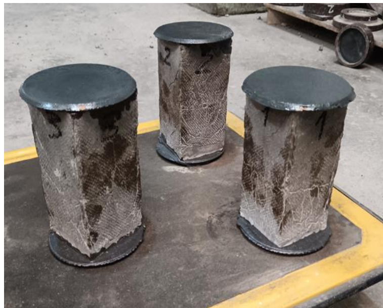
Imagen 16. Testigos prismáticos con capping previos al ensayo a compresión (Nota: Fotografía propia)
