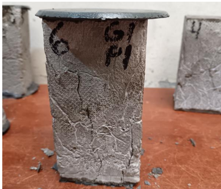
Figura N° 37: Testigo de grout GG1P1 posterior al ensayo de resistencia a la compresión (Nota: Fotografía propia)
