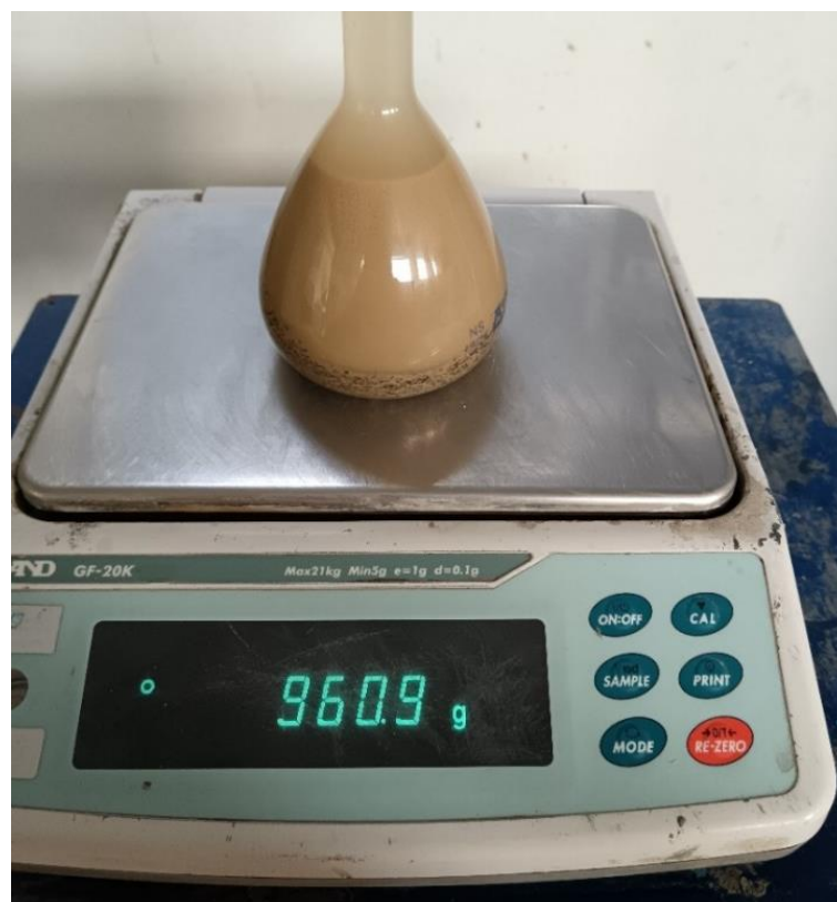
Imagen 4. Pesado de fiola con arena gruesa (Nota: Fotografía propia)
