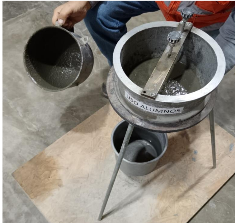
Imagen 5. Ensayo del flujo de tiempo en el cono Marsh (Nota: Fotografía propia)
