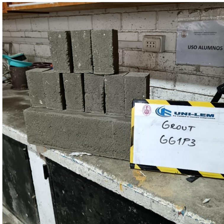
Imagen 12. Testigos prismáticos y testigos tipo viga de grout GG1P3 (Nota: Fotografía propia)
