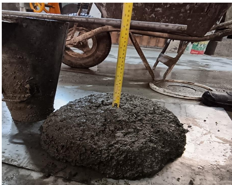
Figura N° 5: Ensayo de consistencia con el cono de Abrams al grout. (Nota: Fotografía propia)
