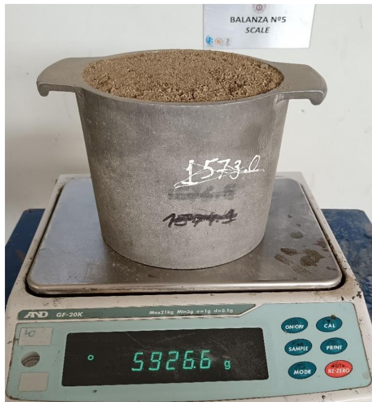
Imagen 2. Pesado de muestra compactada de arena gruesa (Nota: Fotografía propia)
