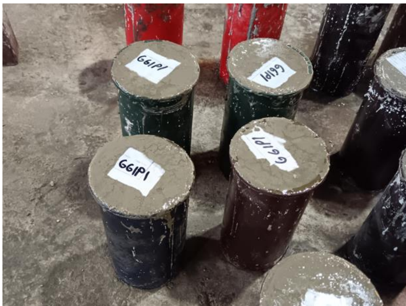
Figura N° 63: Toma de probetas con moldes no absorbentes (Nota: Fotografía propia)
