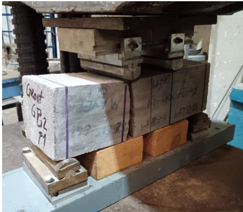
Figura N° 44: Ensayo a la flexión de viga de grout (Nota: Fotografía propia)
