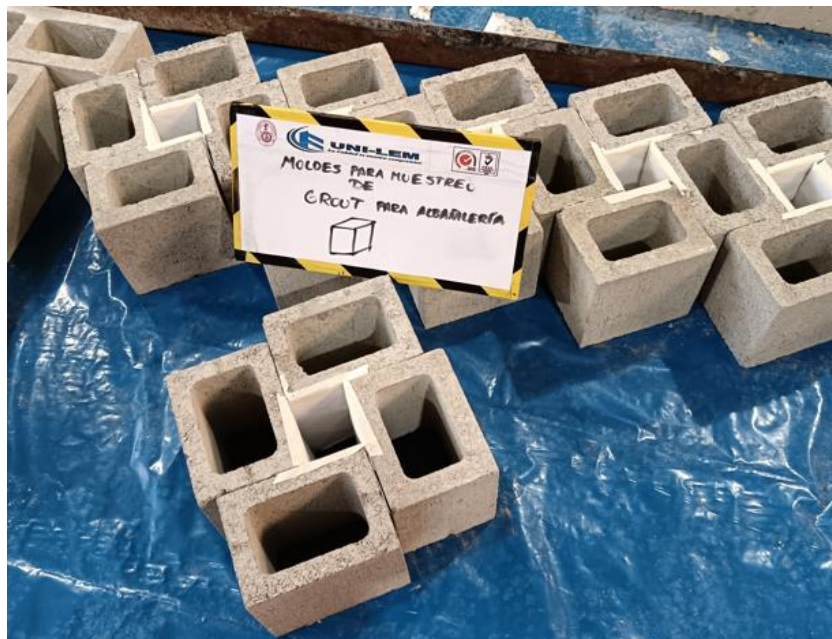
Figura N° 29: Moldes de testigos prismáticos conformados con bloquetas de concreto (Nota: Fotografía propia)
