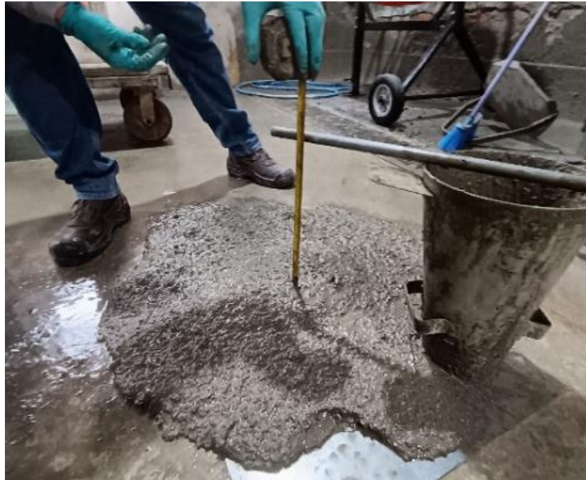
Figura N° 24: Mezcla patrón posterior al ensayo de consistencia (Nota: Fotografía propia)
