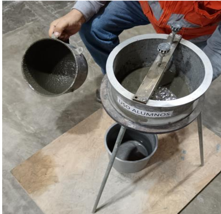
Figura N° 7: Ensayo del cono de Marsh (Nota: Fotografía propia)
