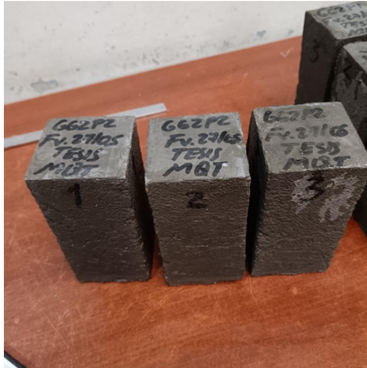
Imagen 13. Testigos prismáticos de grout de tipo GG2P2 (Nota: Fotografía propia)
