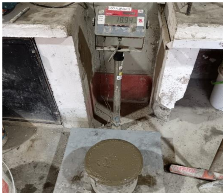
Figura N° 8: Ensayo de peso unitario de grout fresco (Nota: Fotografía propia)
