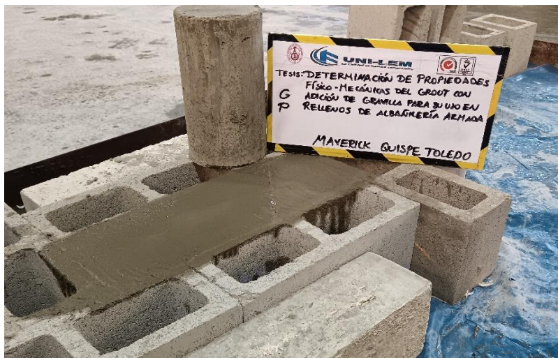
Figura N° 43: Viga de grout para ensayo a flexión (Nota: Fotografía propia)
