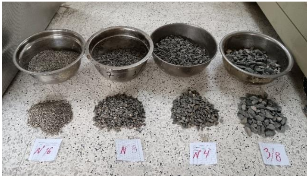
Figura N° 15: Partículas que componen las gravillas (Nota: Fotografía propia)
