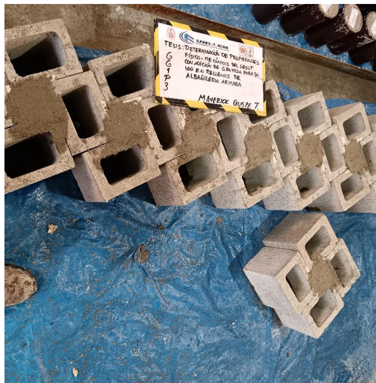
Imagen 10. Moldes de testigos prismáticos rellenos de grout (Nota: Fotografía propia)
