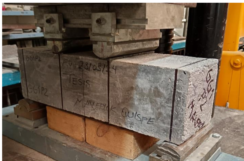
Figura N° 12: Viga de grout cargada a los dos tercios (Nota: Fotografía propia)
