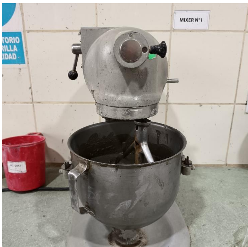
Figura N° 21: Mezcladora de morteros (Nota: Fotografía propia)
