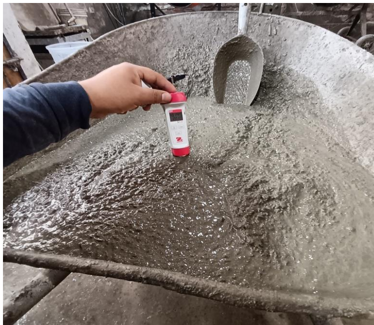
Imagen 8. Toma de temperatura y pH de mezcla de grout fresco (Nota: Fotografía propia)
