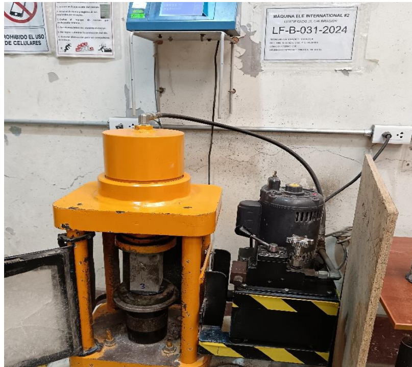
Figura N° 36: Resistencia a la compresión en testigo prismático de grout (Nota: Fotografía propia)
