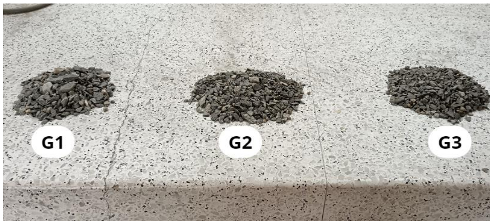
Figura N° 16: Gravilla G1, G2 y G3 conformadas para mezclas de grout (Nota: Fotografía propia)
