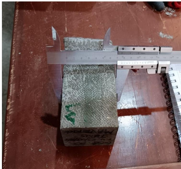
Imagen 14. Dimensionado de testigos prismáticos de grout (Nota: Fotografía propia)
