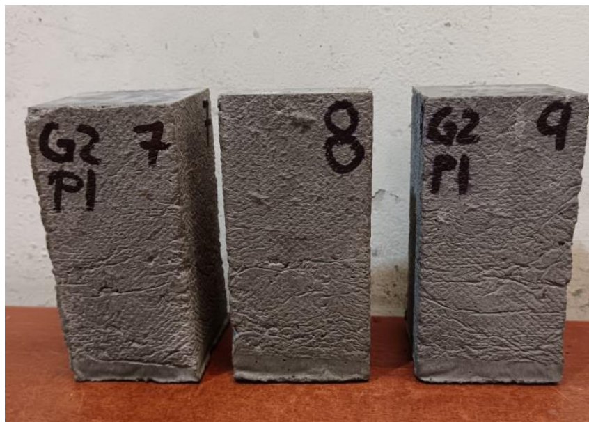
Figura N° 10: Testigos prismáticos de grout para ensayo a la compresión (Nota: Fotografía propia)
