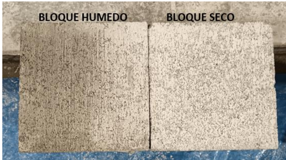
Figura N° 55: Bloque húmedo posterior al desmolde de testigos de grout (Nota: Fotografía propia)
