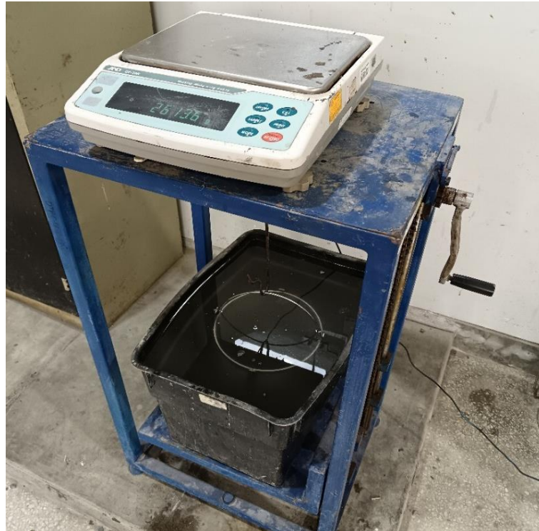
Imagen 3. Peso sumergido de gravilla (Nota: Fotografía propia)
