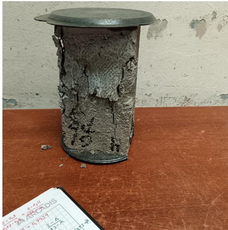
Imagen 17. Testigo prismático de grout ensayado a compresión (Nota: Fotografía propia)
