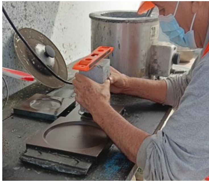
Figura N° 34: Refrendado de testigos de grout con mortero de bentonita y azufre (Nota: Fotografía propia)
