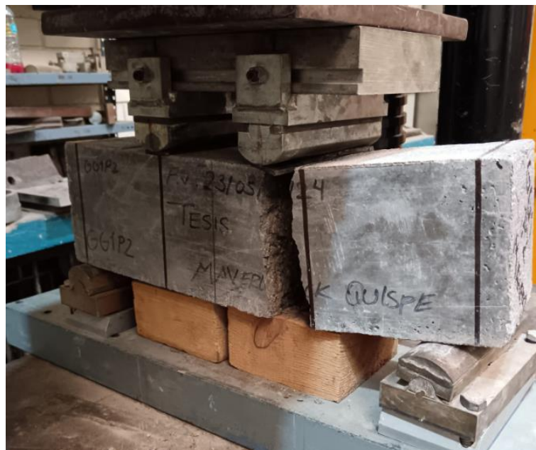
Imagen 19. Viga de grout posterior al ensayo a la flexión (Nota: Fotografía propia)
