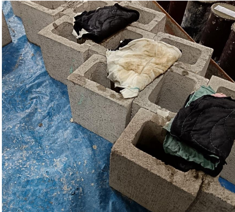
Imagen 11. Testigos prismáticos de grout cubierto con paños húmedos (Nota: Fotografía propia)
