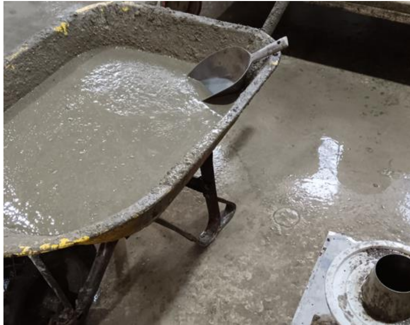
Figura N° 3: Grout fluido en estado fresco (Nota: Fotografía propia)
