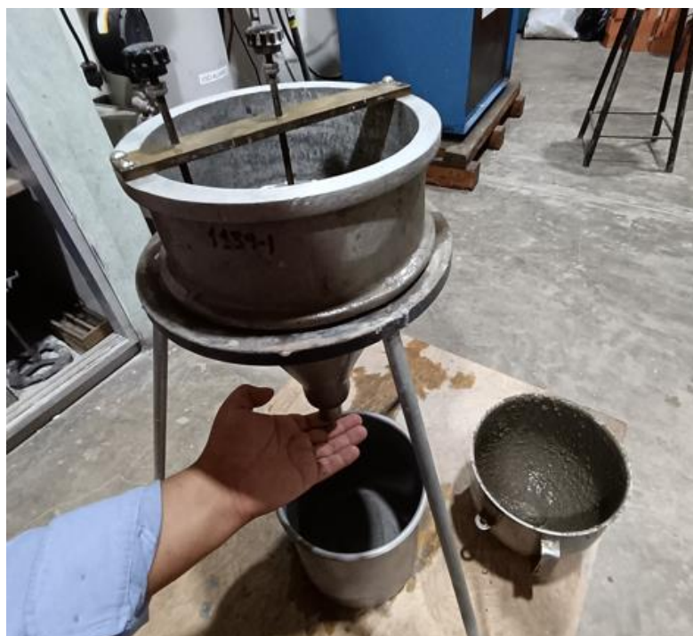
Figura N° 22: Equipo de ensayo cono Marsh para determinar el tiempo de flujo del grout (Nota: Fotografía propia)
