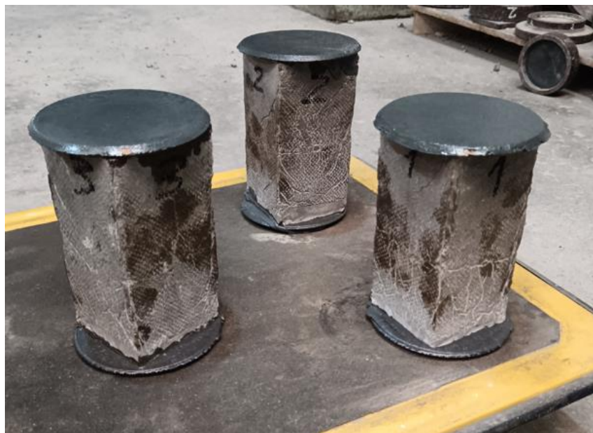
Figura N° 35: Testigos prismáticos de grout refrendados (Nota: Fotografía propia)
