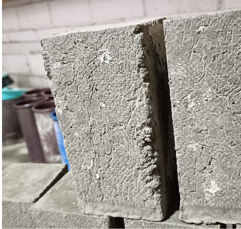
Figura N° 48: Testigo prismático de grout GG1P3 con deficiencia de consolidación (Nota: Fotografía propia)
