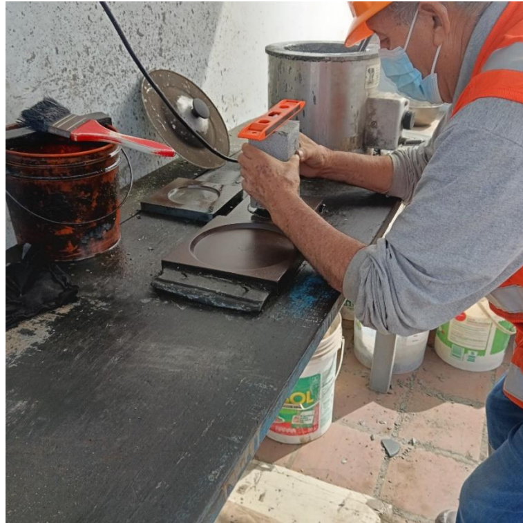
Imagen 15. Capping de testigos prismáticos de grout (Nota: Fotografía propia)
