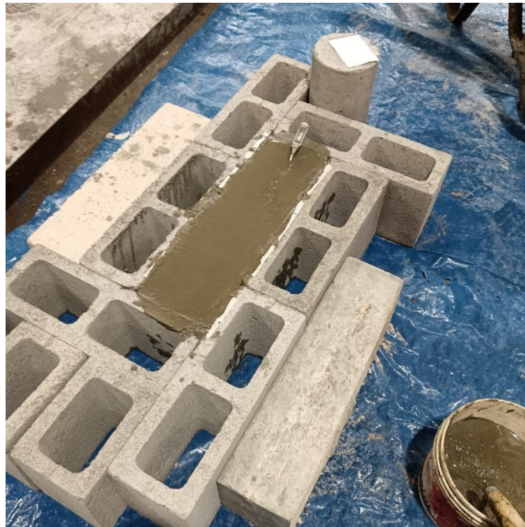
Imagen 18. Molde absorbente relleno de grout (Nota: Fotografía propia)
