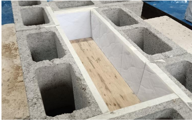
Figura N° 42: Molde absorbente conformado por bloques de concreto forrados con papel toalla (Nota: Fotografía propia)
