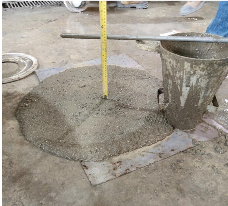
Imagen 7. Ensayo de asentamiento de mezcla de grout (Nota: Fotografía propia)
