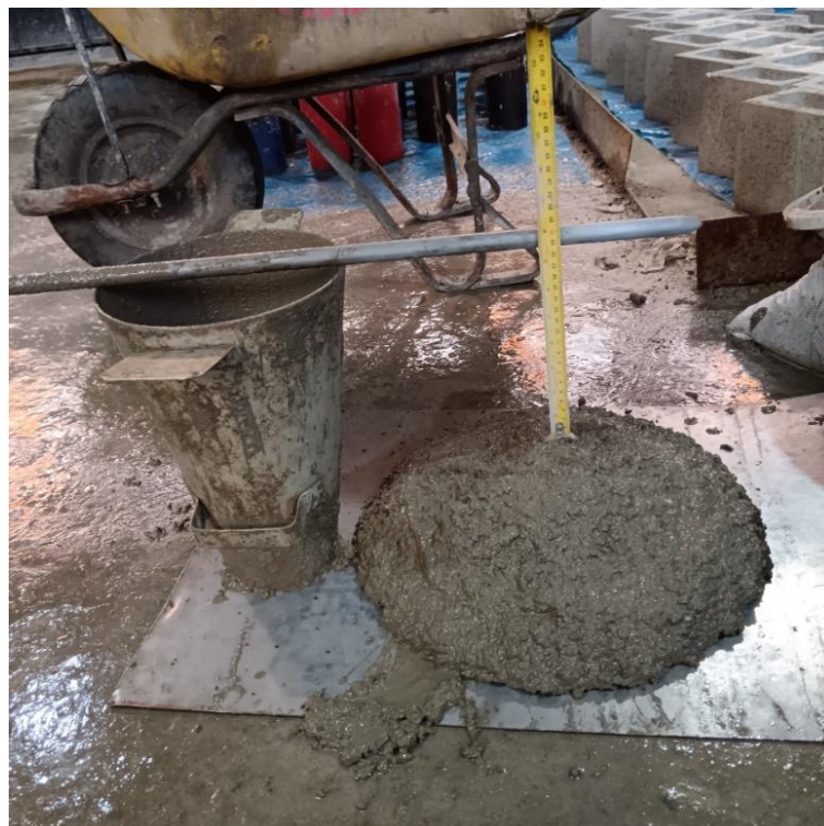
Imagen 6. Ensayo de asentamiento de mezcla de grout (Nota: Fotografía propia)
