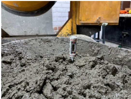
Figura N°2. Temperatura del concreto fresco.
