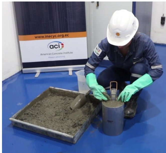
Figura N°10. Ensayo de temperatura en el concreto
