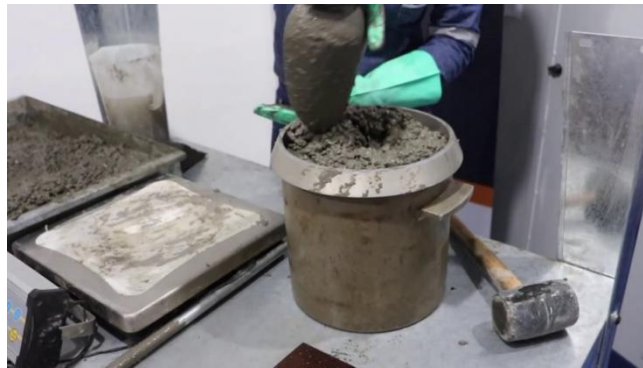
Figura N°3. Peso unitario del concreto fresco.
