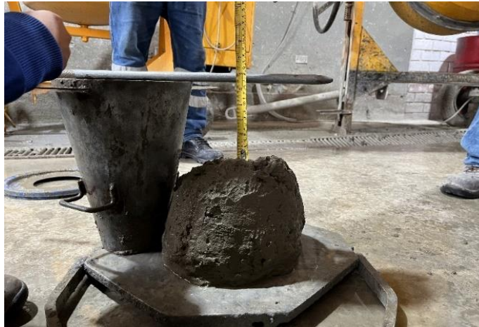
Figura N°1. Asentamiento mediante el cono de Abrams.
