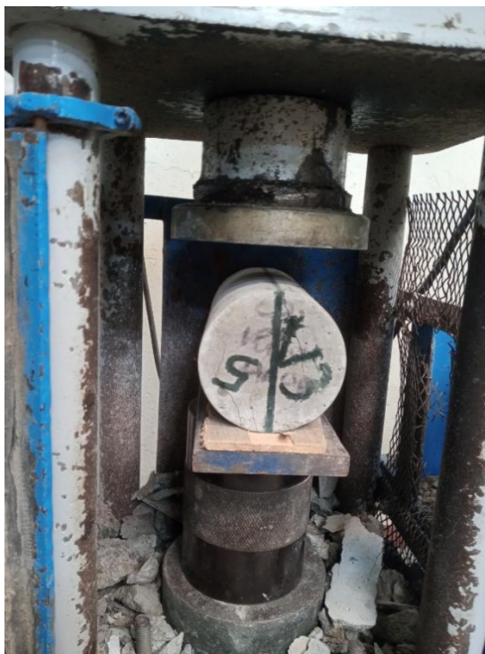
Figura N°5. Ensayo de tracción al concreto.
