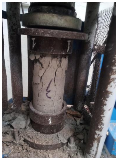
Figura N°12. Fracturas de una probeta de acuerdo con las cargas utilizadas.
