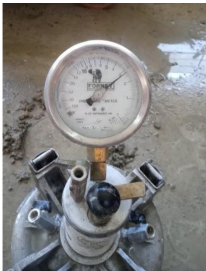
Figura N°9. Olla de Washington para el ensayo de contenido de aire.
