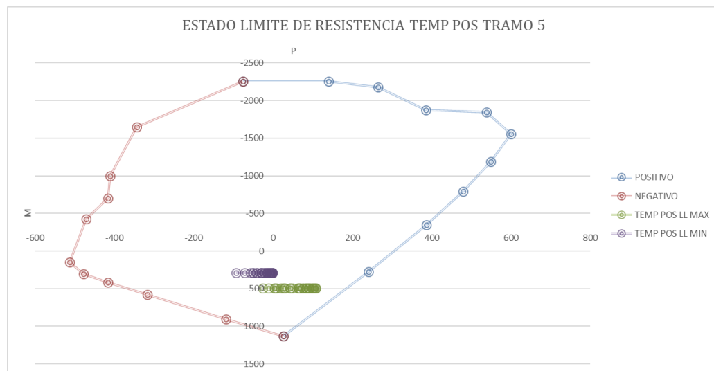
Figura 231: Diagrama de interacción para \Delta T > 0 de la sección correspondiente al tramo 5.
