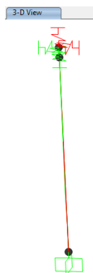
Figura 121: Restricción al desplazamiento.
