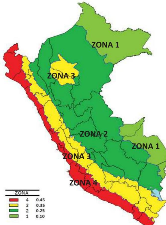
Figura 4.1: Zonas sísmicas según la Norma E.030
