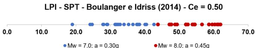
Figura 5.29: Valores de LPI empleando ensayos SPT para una  $C_E$  igual a 0.50
