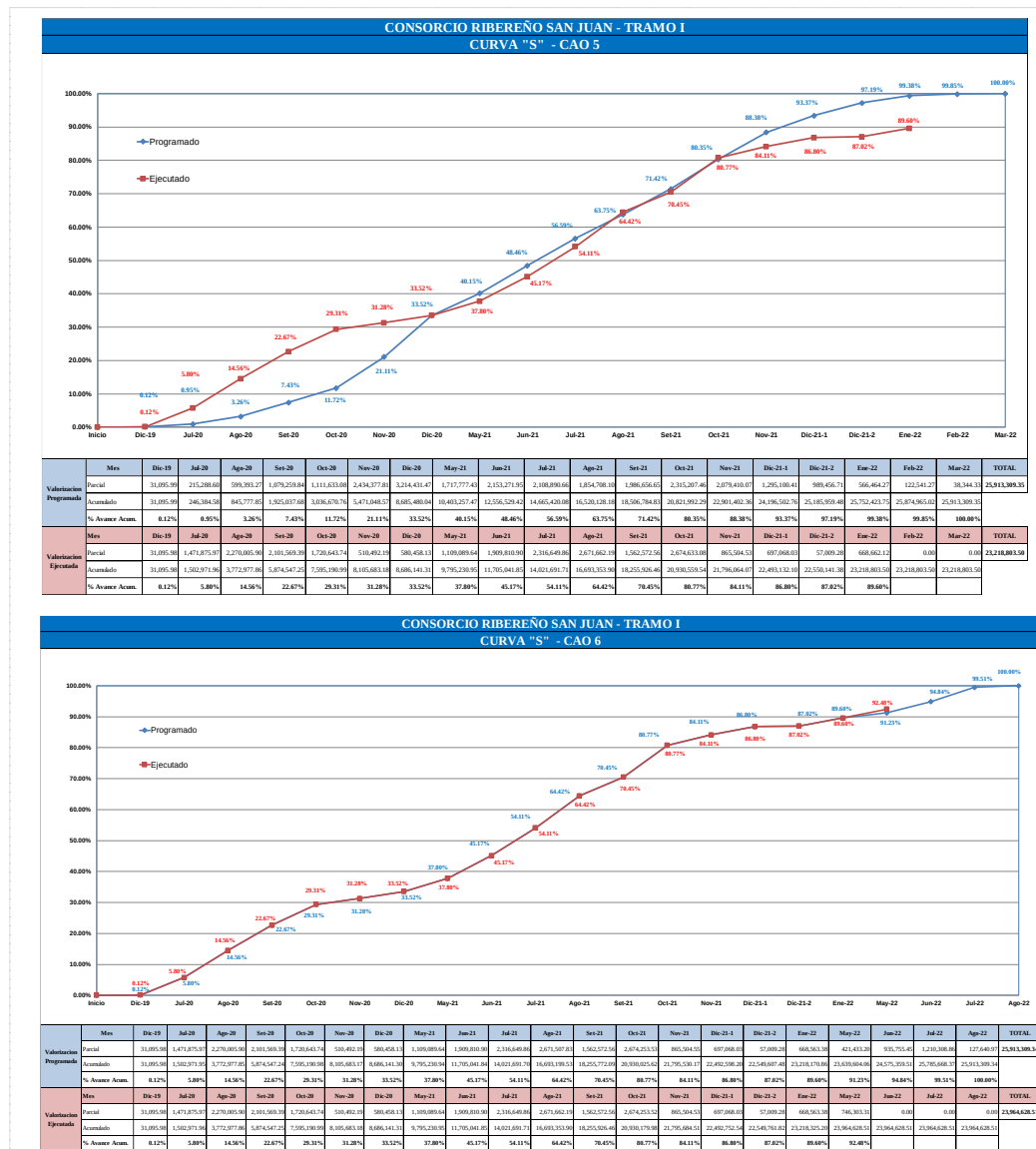
Figura N° 40: Actualización de la sección de curva S
