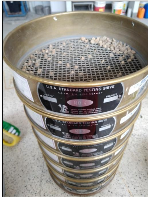
Fotografía 7: Ensayo de granulometría de agregado fino
