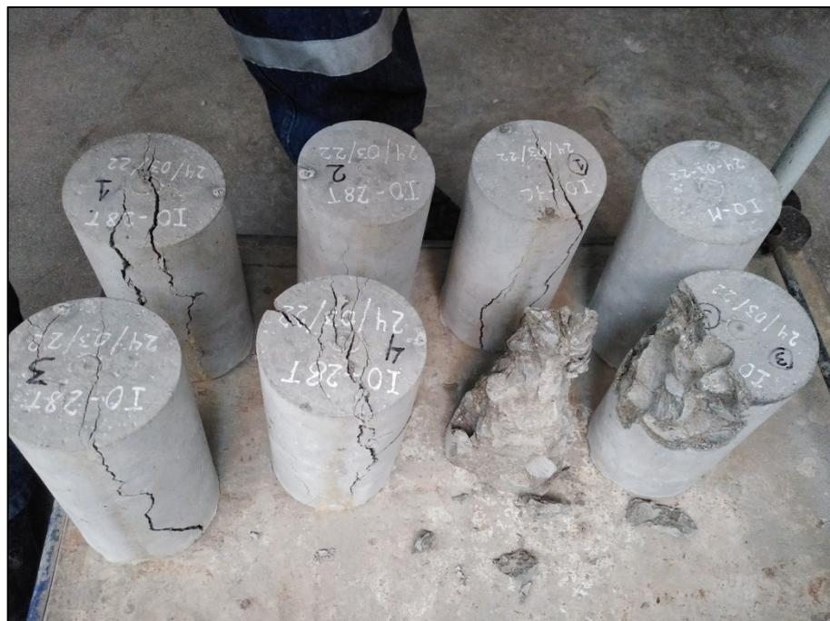
**Fotografía 20: Muestras de probetas ya ensayadas**
