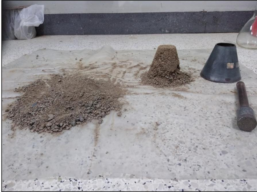
**Fotografía 9: Ensayo de peso específico de agregado fino**
