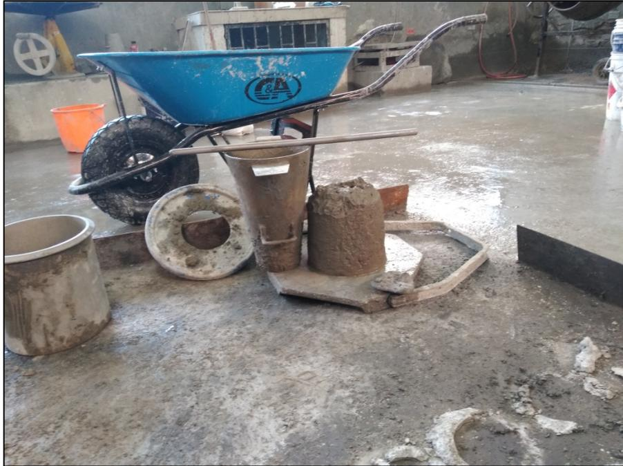
**Fotografía 11: Ensayo de asentamiento del concreto**
