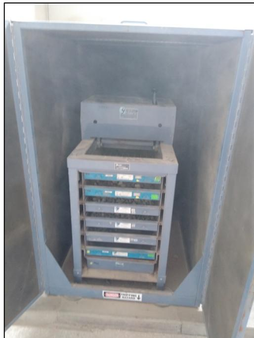
Fotografía 6: Ensayo de granulometría de agregado grueso
