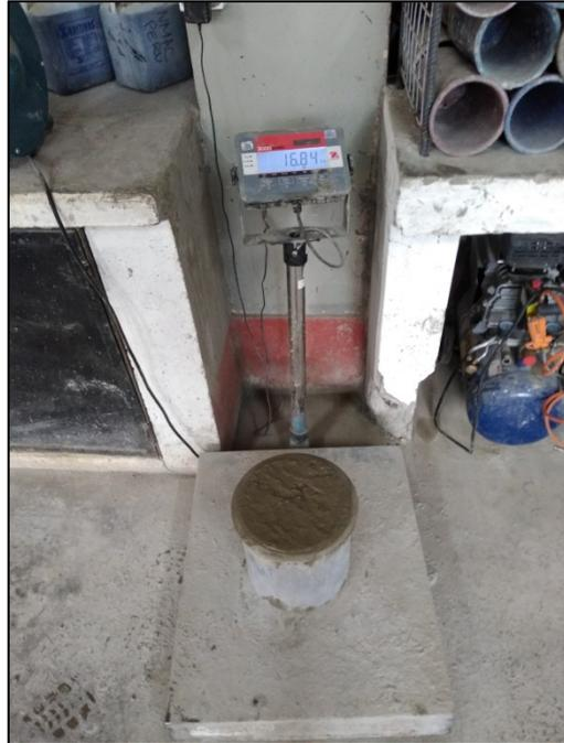
**Fotografía 13: Ensayo de peso unitario del concreto**
