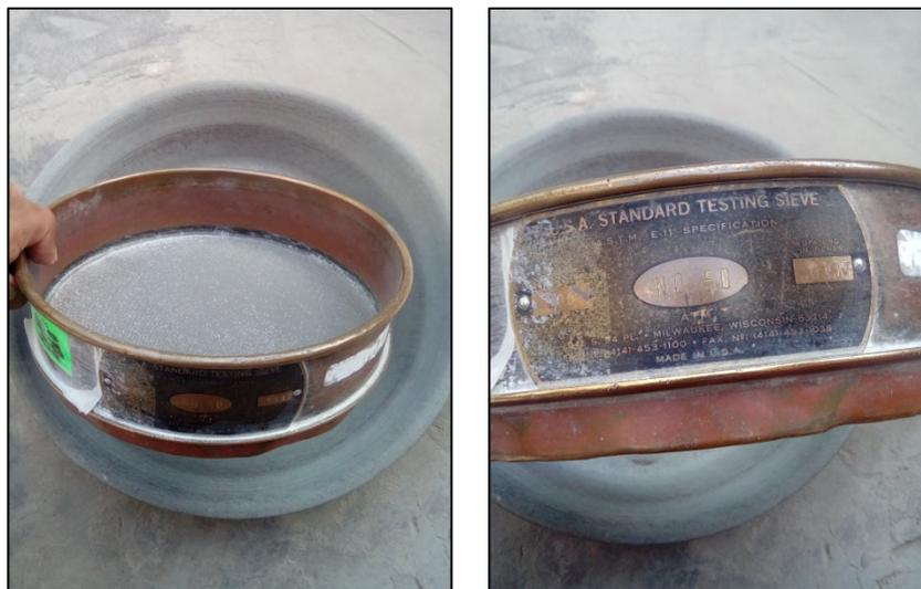
Figura N° 25: Tamiz utilizado para obtener el polvo de cáscara de huevo
