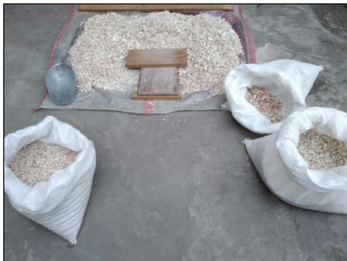
Figura N° 21: Trituración de la cáscara de huevo
