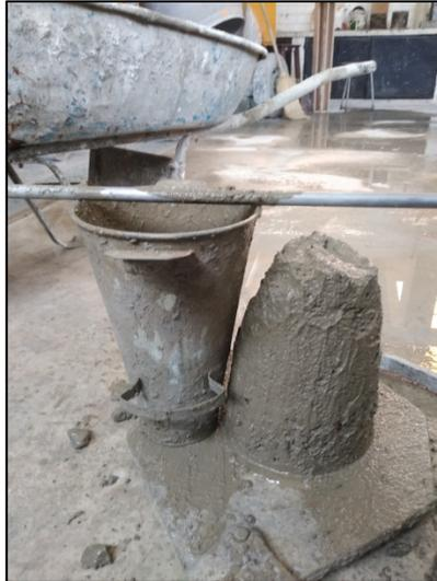
Figura N° 3: Ensayo de asentamiento del concreto
