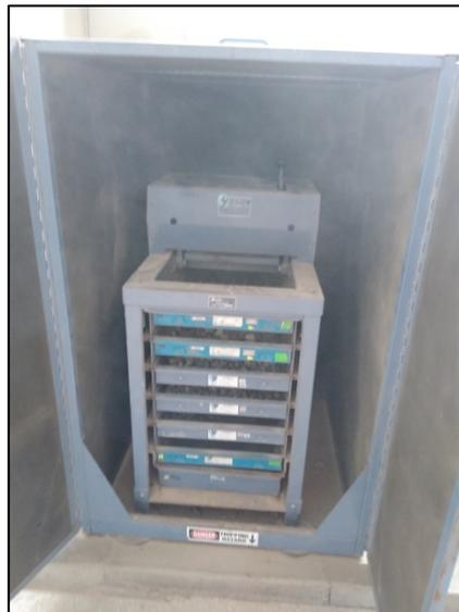
Figura N° 18: Equipo para ensayo de granulometría del agregado grueso
