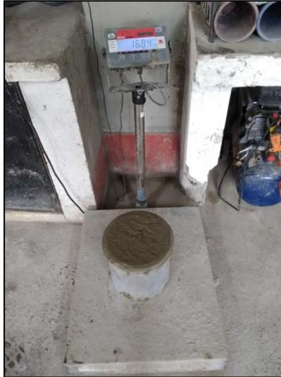
Figura N° 4: Ensayo de peso unitario del concreto
