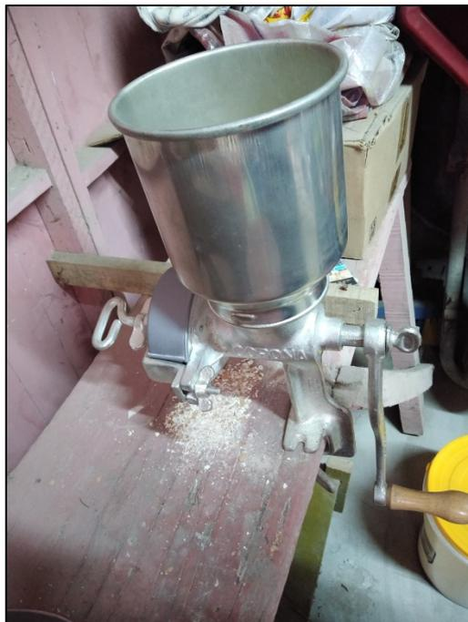
**Fotografía 4: Molino manual para obtener polvo de cáscara de huevo**
