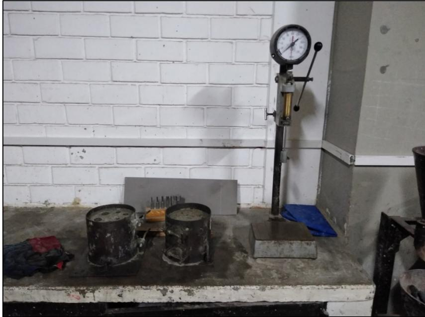
**Fotografía 15: Ensayo de tiempo de fragua**
