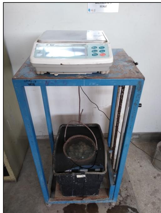
Fotografía 8: Ensayo de peso específico de agregado grueso
