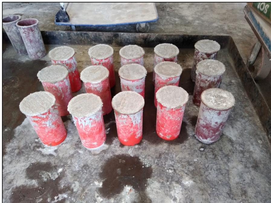
**Fotografía 16: Moldes de probetas de concreto**
