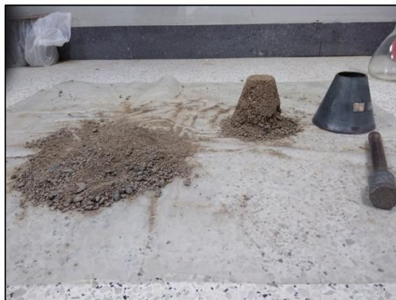
Figura N° 17: Ensayo de peso específico y absorción
