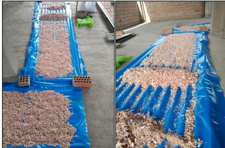
Figura N° 20: Secado de cáscara de huevo al aire libre
