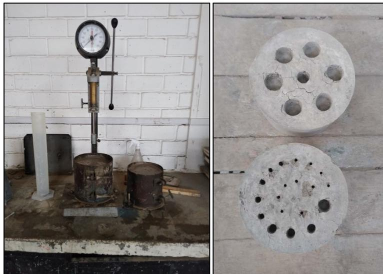
Figura N° 5: Ensayo de tiempo de fragua por método de resistencia a la penetración
