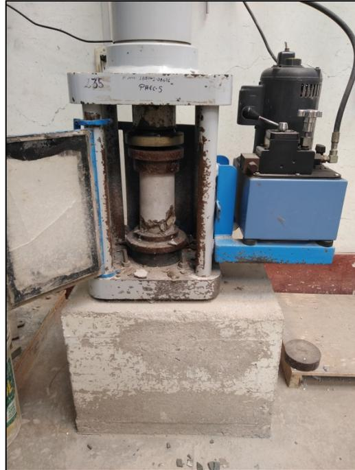
**Fotografía 19: Ensayo de resistencia a la compresión**
