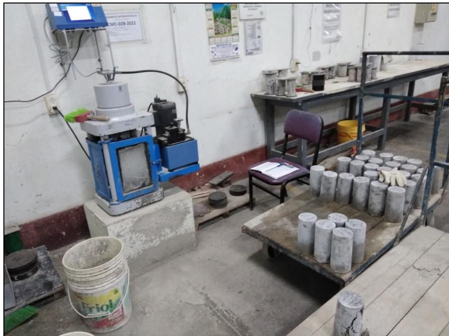
**Fotografía 18: Área de trabajo para ensayos de resistencia (LEM)**
