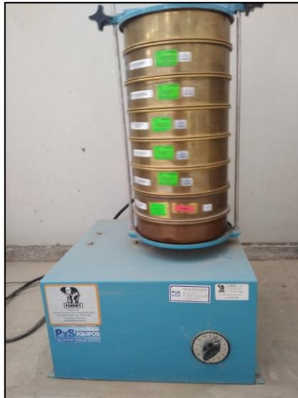
Figura N° 15: Equipo para ensayo de granulometría del agregado fino
