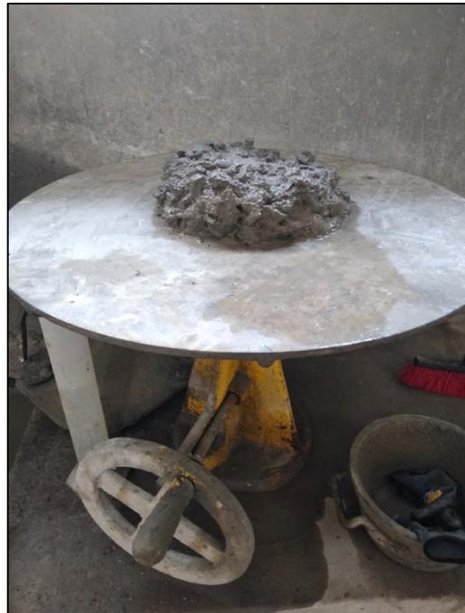
**Fotografía 12: Ensayo de consistencia del concreto**
