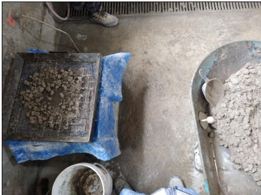
**Fotografía 14: Tamizado de concreto para ensayo de tiempo de fragua**
