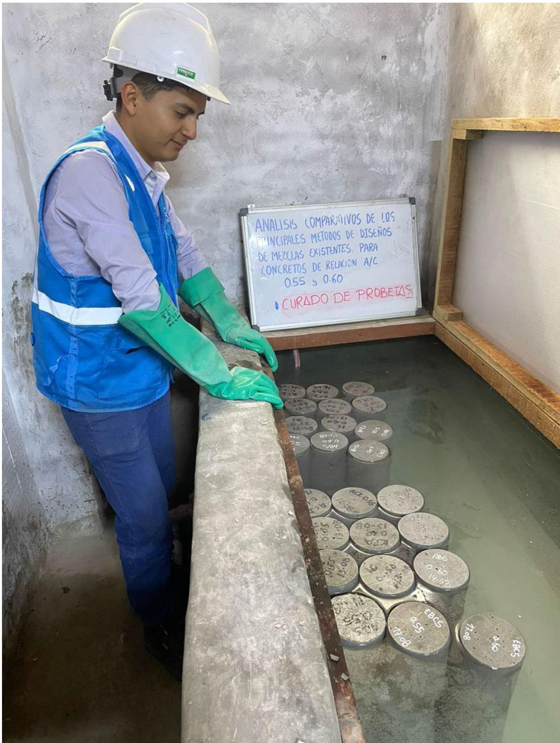
"ANÁLISIS COMPARATIVO DE LOS PRINCIPALES MÉTODOS DE DISEÑO DE MEZCLAS EXISTENTES, PARA CONCRETOS DE RELACIONES AGUA – CEMENTO 0.55 Y 0.60"
