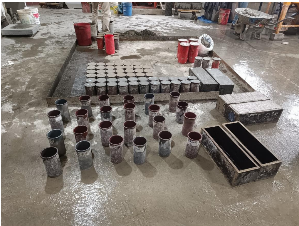
Figura E19 Moldes de probetas y vigas
