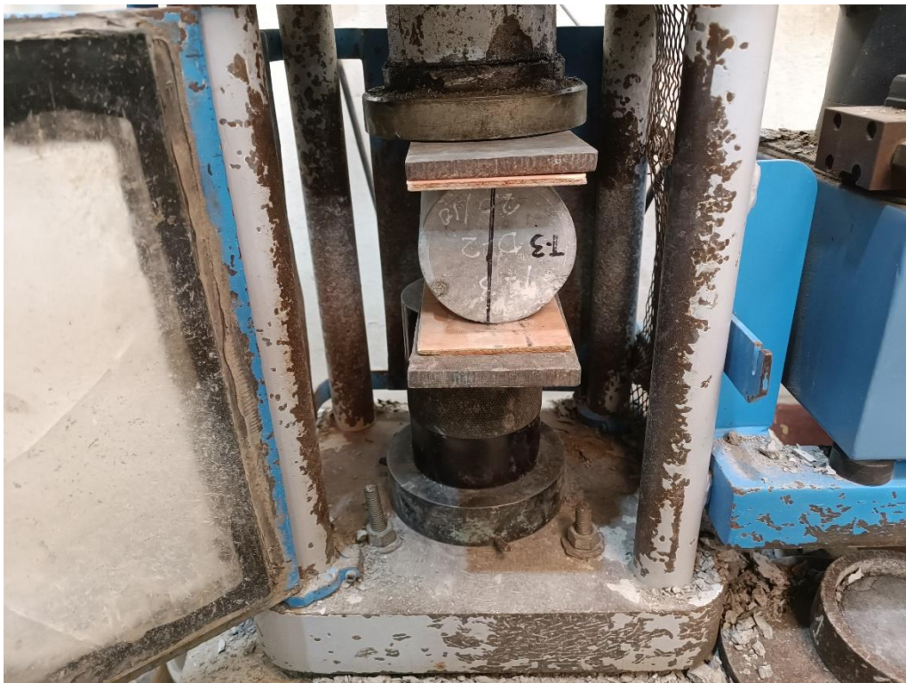
Figura E25 Ensayo de resistencia a la tracción
