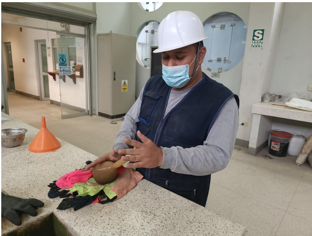
Figura E9 Ensayo de peso específico y absorción del agregado fino
