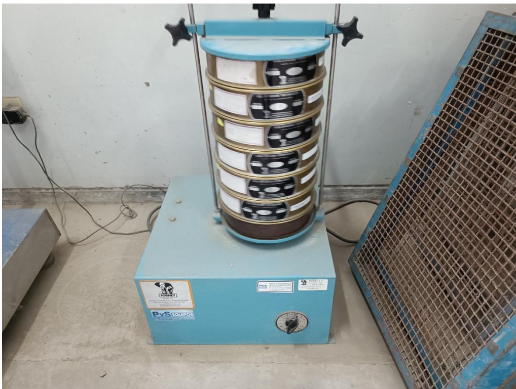
Figura E7 Tamizado del agregado fino
