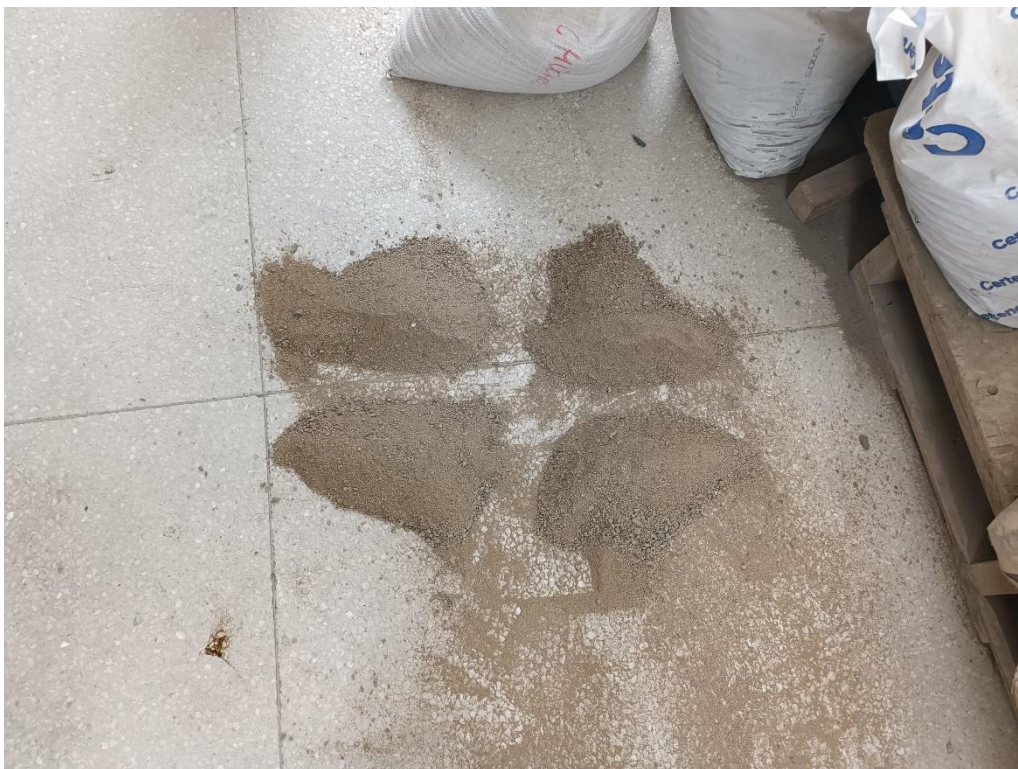
Figura E3 Cuarteo del agregado fino
