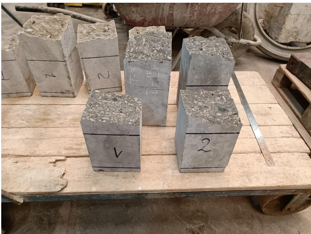
Figura E28 Vigas luego del ensayo de resistencia a la flexión
