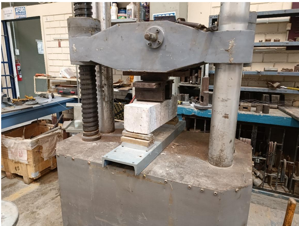
Figura E27 Ensayo de resistencia a la flexión
