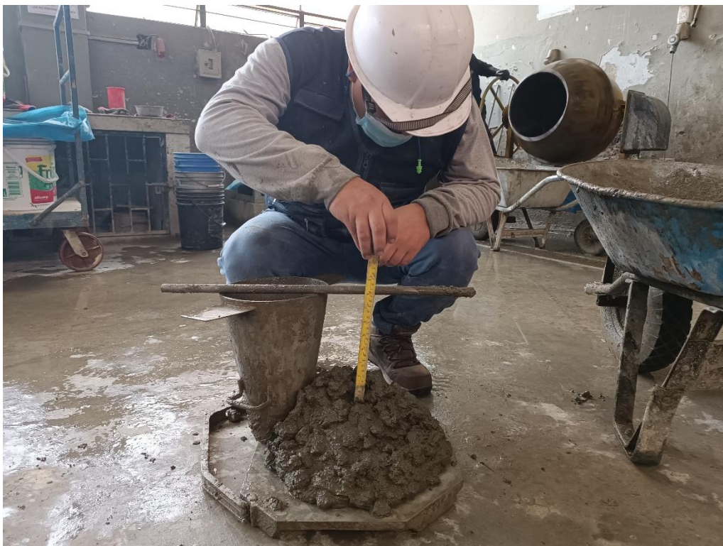
Figura E15 Ensayo de asentamiento o slump
