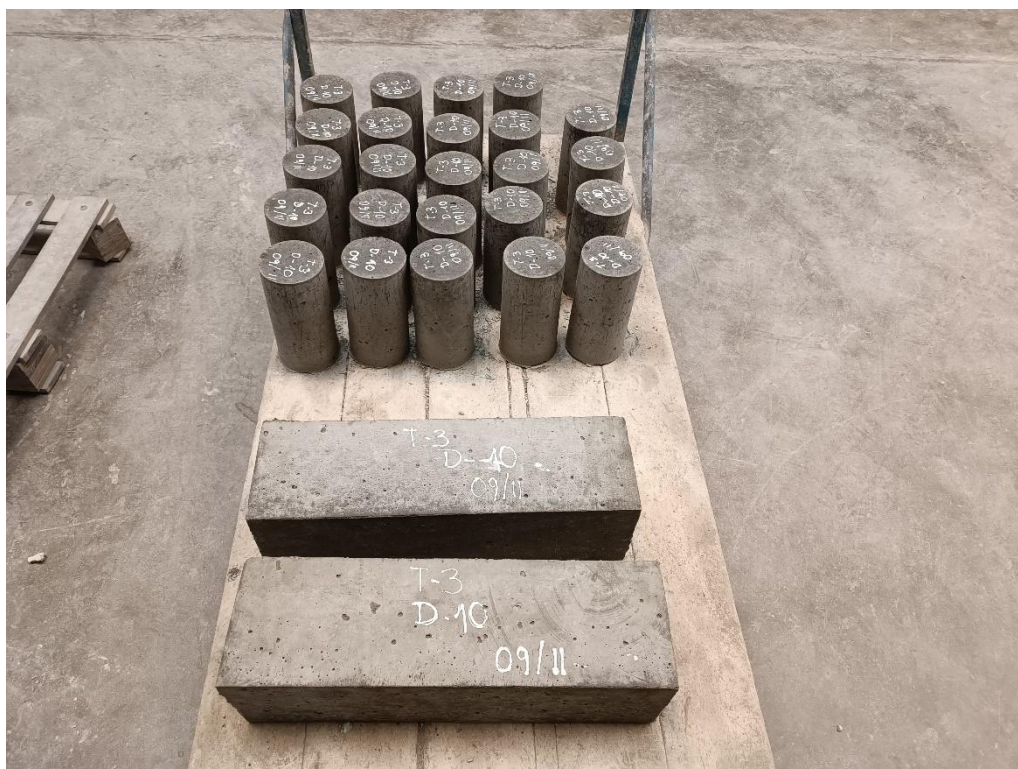
Figura E20 Probetas y vigas luego de ser desencofradas
