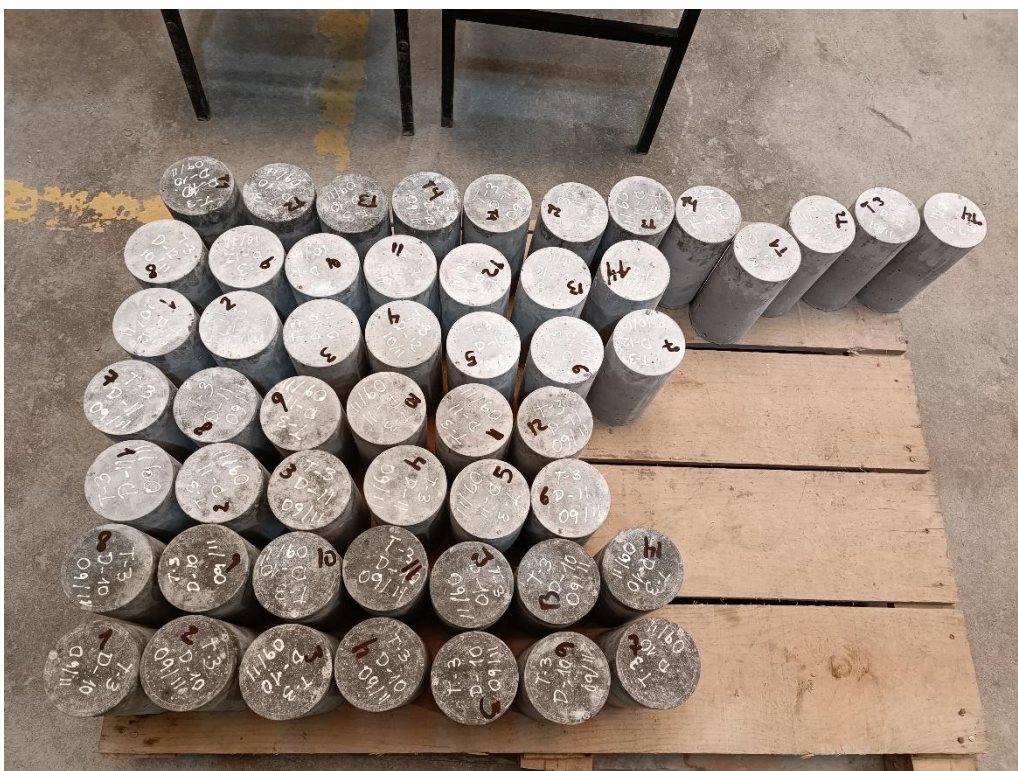
Figura E22 Probetas de concreto de 4" x 8"
