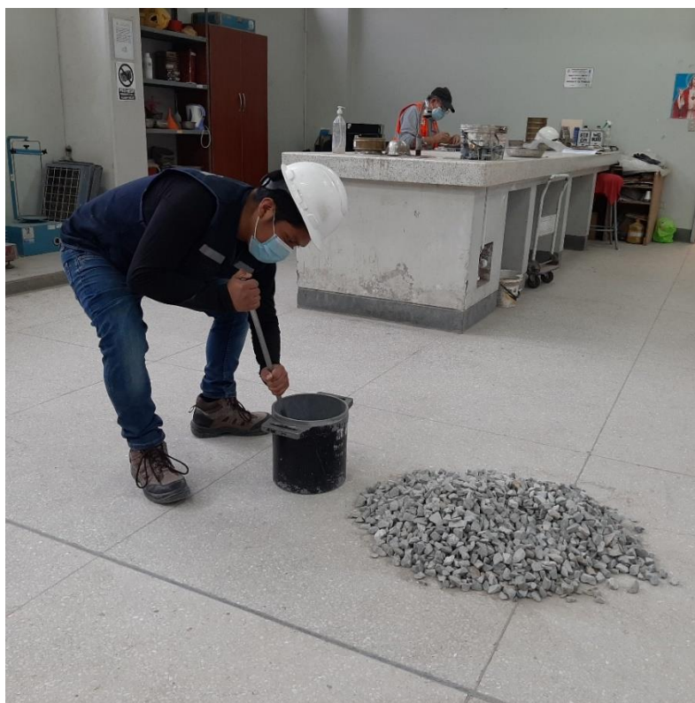
Figura A 39. Procedimiento de obtención de Peso Unitario Compactado del Agregado Fino Natural
