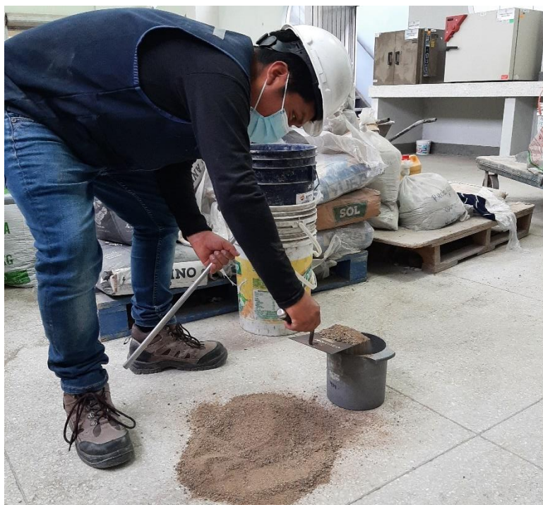
Figura A 39. Procedimiento de obtención de Peso Unitario Compactado del Agregado Fino Natural
