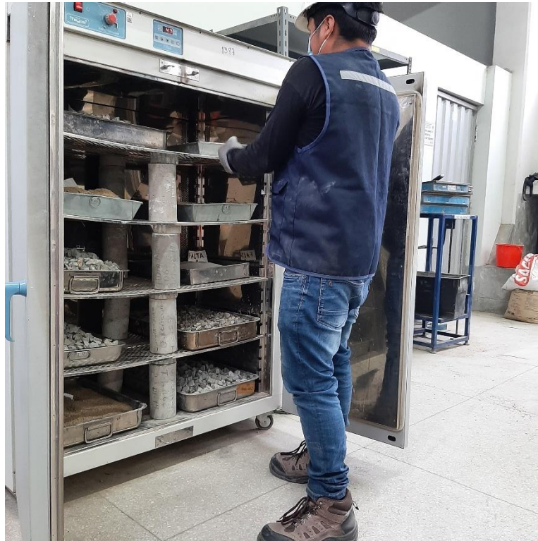
Figura A 40. Procedimiento de obtención del contenido de humedad de agregados
