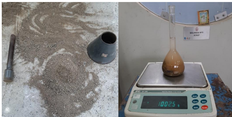
Figura A 42. Ensayo de Peso Específico y Porcentaje de Absorción del Agregado Fino
