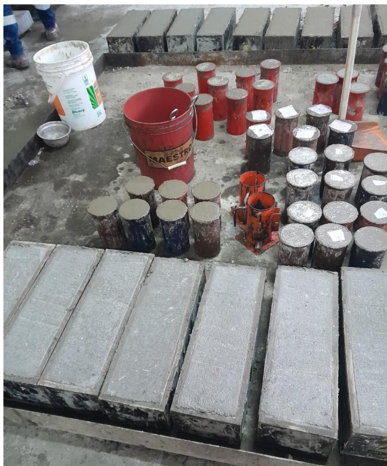
Figura A 49. Vaciado de probetas y vigas
