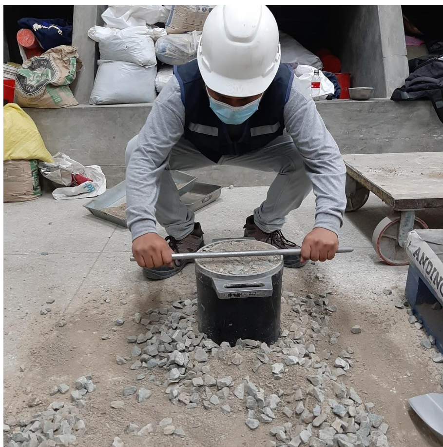
Figura A 43. Procedimiento para obtención de la Máxima Compacidad de la Combinación de Agregado Grueso Natural y Agregado Fino Reciclado Comercial
