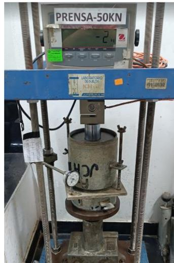
Figura 32. Corrido de los moldes tras 07 días de saturación.
