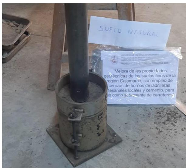
Figura 29. Compactación de mezcla para ensayo Proctor Modificado.
