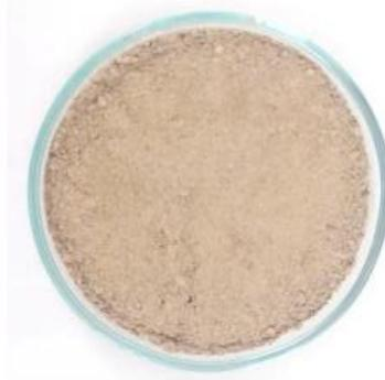
FIGURA N°1. Muestra de limo de alta plasticidad (CLASIFICACIÓN SUCS MH).
