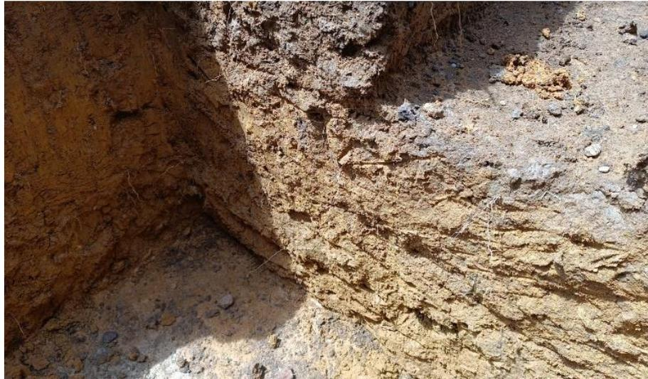
Figura 9. Calicata excavada para la extracción de la muestra 2, zona urbana.
