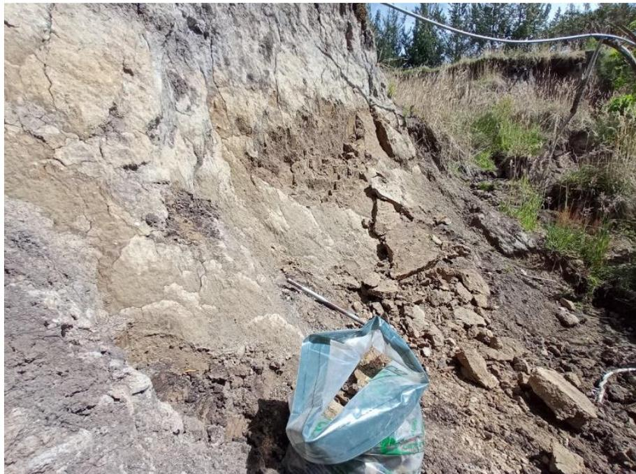
Figura 15. Extracción de muestra de suelo fino en talud de la trocha CA-1141.
