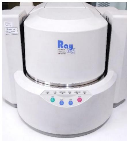
**FIGURA N°4.** Espectrómetro de fluorescencia de Rayos X de energía dispersiva (SHIMADZU, EDX-800HS).
