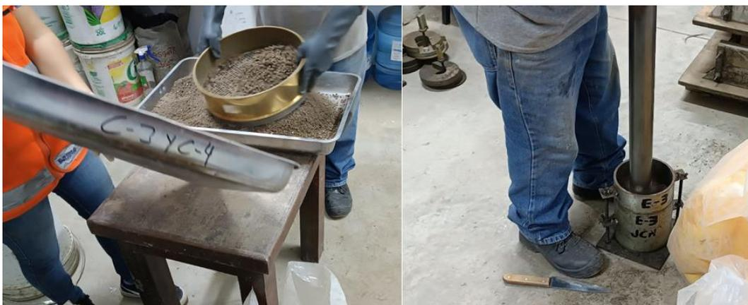
Figura 31. Preparación y compactación de mezclas en moldes para ensayo CBR.
