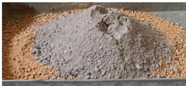
Figura 23. Muestras de suelo y ceniza listas para la mezcla.
