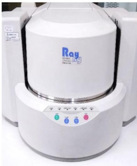
**FIGURA N°4.** Espectrómetro de fluorescencia de Rayos X de energía dispersiva (SHIMADZU, EDX-800HS).
