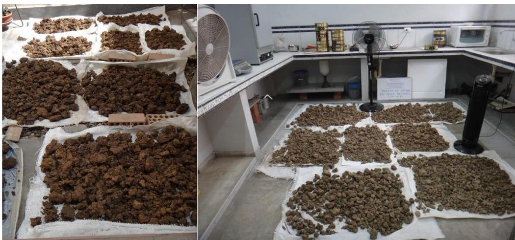
Figura 19. Secado de muestra de suelo fino en ambiente natural y con ventiladores.
