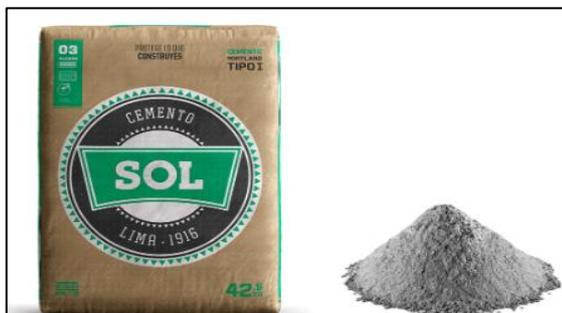
Figura 22. Cemento Portland Tipo I usado en la investigación.
