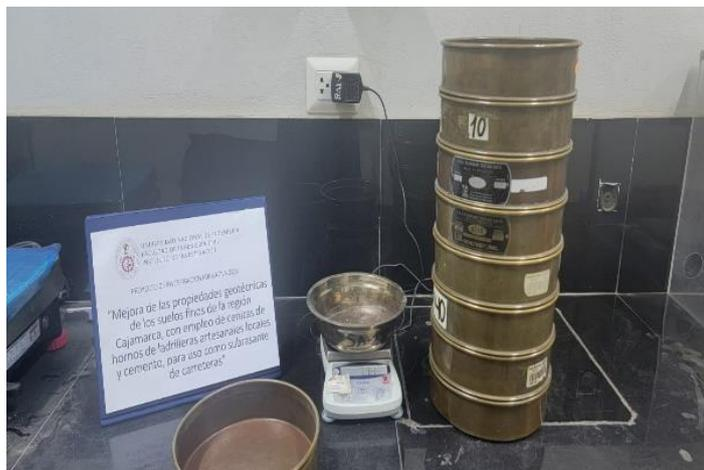
Figura 25. Ejecución de ensayo de análisis granulométrico.
