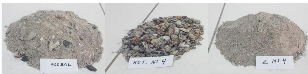
Figura 21. Ceniza de granulometría completa que generan las ladrilleras.
