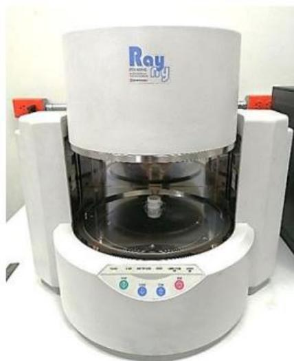
FIGURA N°3. Muestra en el equipo EDX para su análisis.
