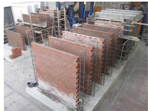
Foto 12. Muros completos de ladrillo sólido y ladrillo tubular.
