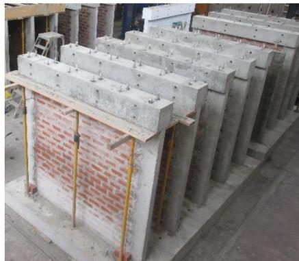
Foto 23. Seis muros de albañilería de ladrillo sólido artesanal y ladrillo tubular industrial.
