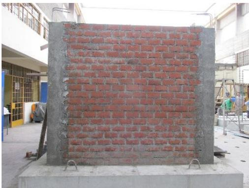
Foto 15. Desencofrado de la columna.
