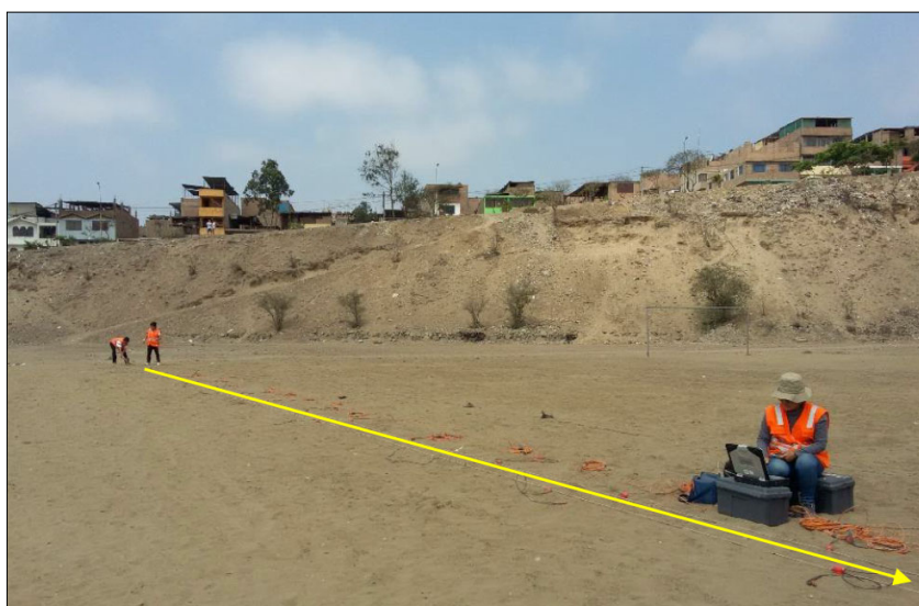
Figura N°52. Ensayo de Análisis multicanal de Ondas superficiales (MASW -09)
