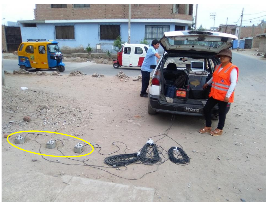
FOTO 50: M-50, se muestra el instante de la medición de microtremores, realizado a dos cuadras de la Av. Los Eucaliptos, en la calle Las Lagunas.
