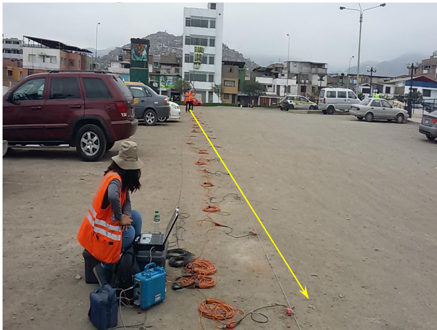
FOTO 01: MASW-01, se observa el registrando de las ondas con una computadora portátil en la ejecución del ensayo MASW. Este ensayo se realizó al costado de la Municipalidad de San Juan De Miraflores.
