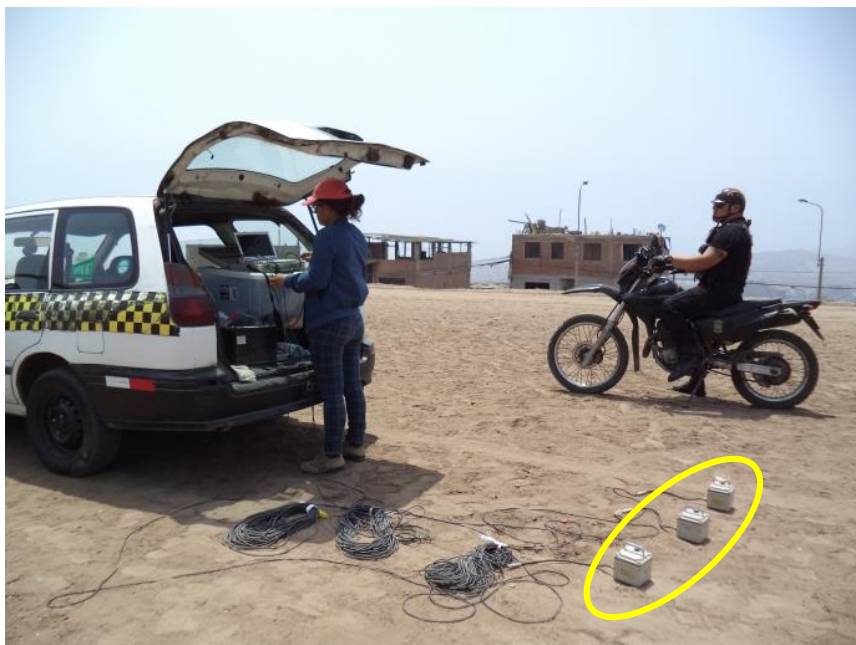
FOTO 16: M-16, se observa el instante de la toma de datos de los registros de microtemores captados mediante tres sensores ubicados al frente de la Iglesia Virgen Inmaculada, cerca de Manuel Scorza.
