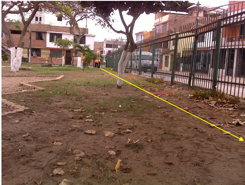
FOTO 07: MASW-07, se observa el tendido de cables y su conexión con los geófonos en la ejecución del ensayo MASW.
