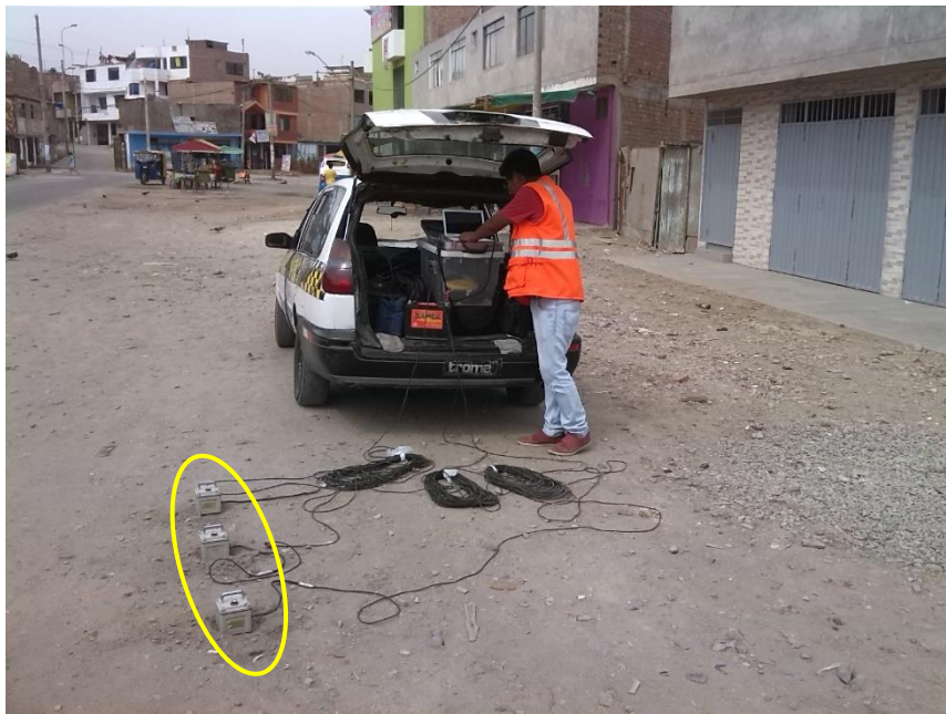
FOTO 51: M-51, se muestran los sensores, los cables y el equipo adquisidor de señales usado para la medición de microtemores, frente al Complejo Deportivo Cultural “1ro de Abril”.
