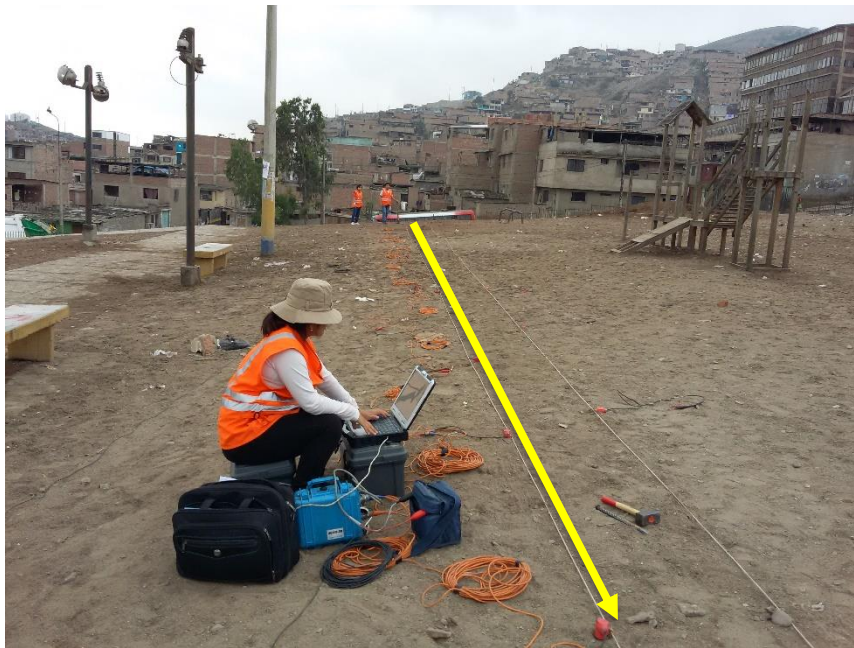
FOTO 03: MASW-03, se observa el tendido de cables y su conexión con los geófonos, además de la configuración del equipo en la ejecución del ensayo MASW. Este ensayo fue realizado en el parque Leoncio Prado ubicado en la intersección entre la Av. Edilberto Ramos y calle Centenario.
