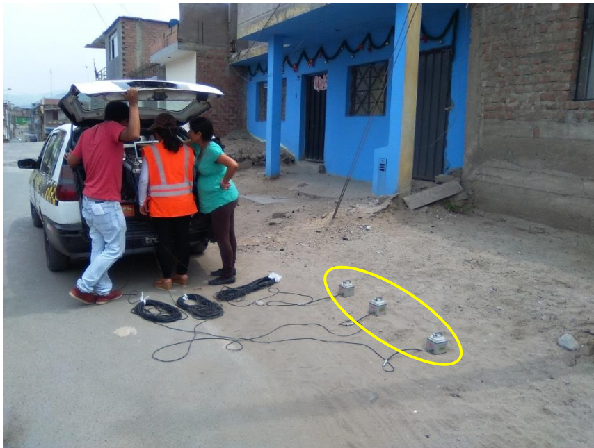
FOTO 47: M-47, se observa la disposición de los sensores para el ensayo de microtremores, realizado en el cruce de la calle Alemania y la Calle 12, a una cuadra de la Av. Miguel Iglesias
