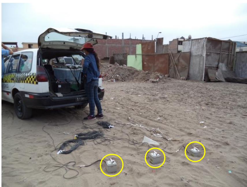
FOTO 30: M-30, se observa la ubicación de los sensores para el registro de microtemores, a pocos metros del cruce de Av. Central y Altiplano.
