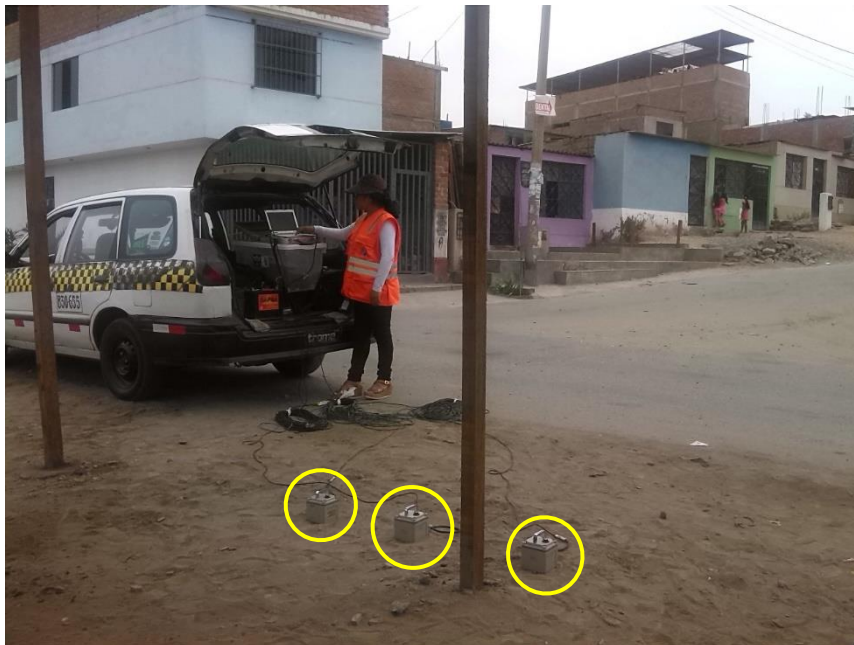
FOTO 55: M-55, se observa el instante de la toma de datos de los registros de microtemores captados mediante sensores, a una cuadra de la intersección de las calles Santa Teresa y Santa Rita, dirección Norte.
