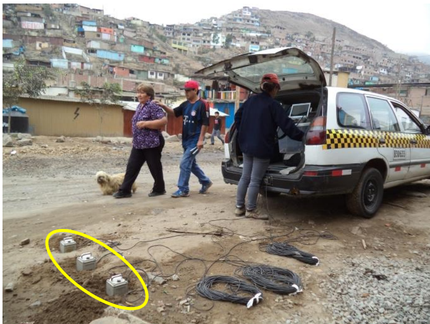
FOTO 34: M-34, se observa la ubicación de los sensores, para el registro de microtemores, a una cuadra del Mercado Arguedas, cruce de Av. Nazaret y Calle Ciro Alegría.
