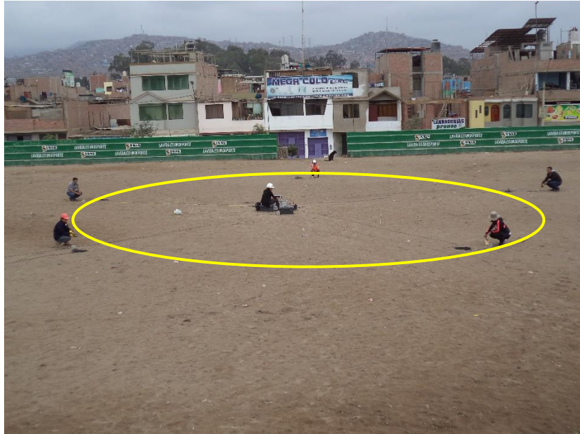
FOTO 01: A-04, se observa la disposición de sensores alrededor del arreglo circular de 10m de radio. Estos sensores se conectan mediante cables al equipo adquisidor de señales ubicado en el centro para el registro de la vibración ambiental.
