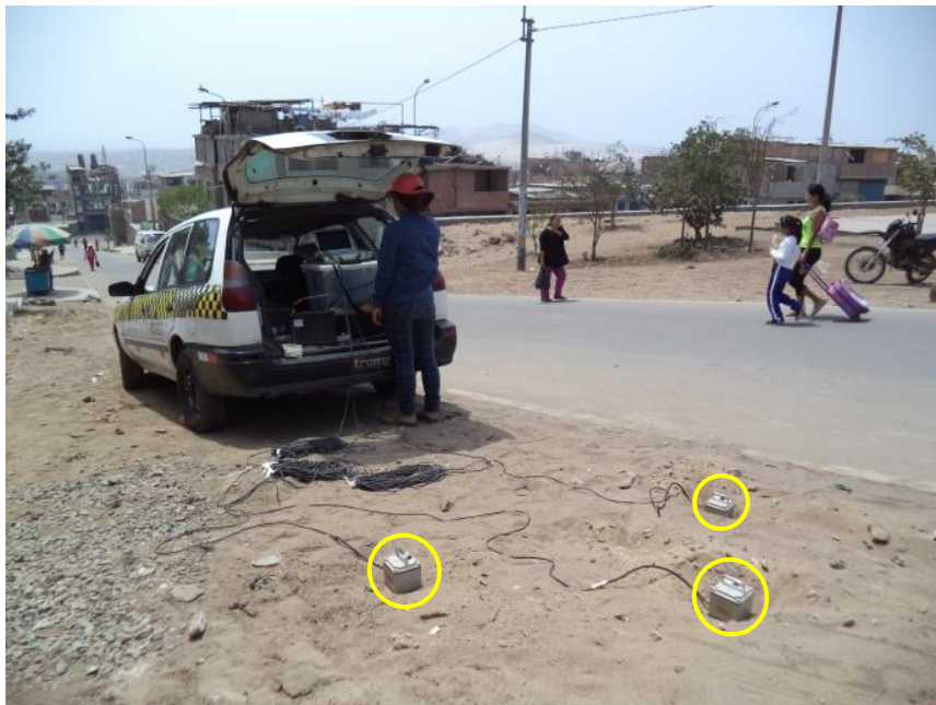
FOTO 17: M-17, se observa la ubicación de los sensores, para el registro de microtemores, a tres cuadras de la intersección de la Av. Miguel Iglesias y Calle 13.
