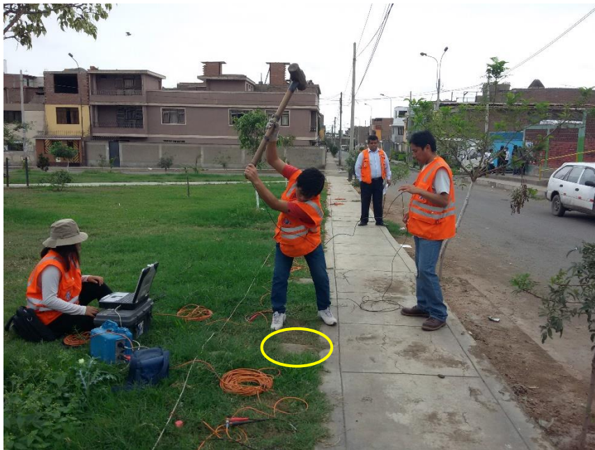
FOTO 06: LS-06, se observa el instante de la generación de ondas en la parte central del ensayo de refracción sísmica. Este ensayo de refracción sísmica fue realizado en el parque Arturo Armero ubicado en la intersección entre la Av. Cesar Canevaro y la calle Juan Guerra.
