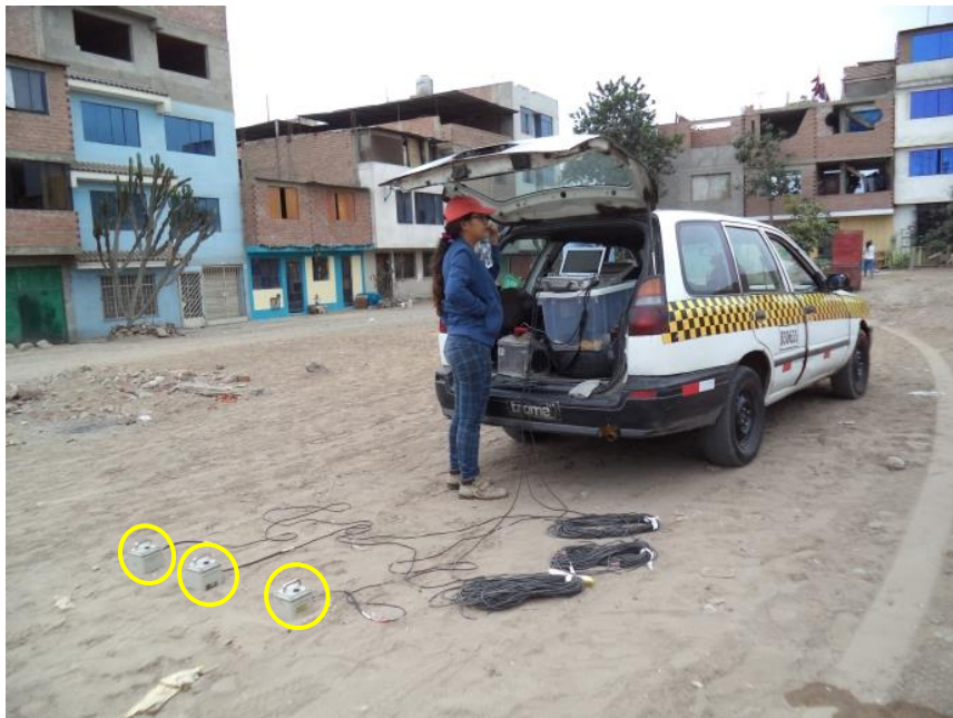
FOTO 08: M-08, se muestran los sensores y adquisidor de datos en el momento del registro de la vibración ambiental, realizado en el cruce de la Av. Luis Pardo y Grau.
