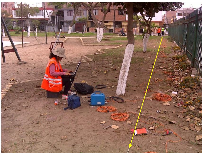
FOTO 14: MASW-14, se observa el instante de la configuración del equipo para la ejecución del ensayo MASW. Este ensayo se realizó en el parque Micaela Bastidas ubicado en la intersección entre la calle Oppenheimer y calle Velarde.
