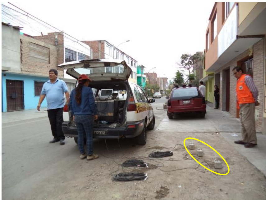
FOTO 02: M-02, se observa la disposición de los sensores para el ensayo de microtremores, realizado cerca del Parque Umamarca, en el cruce de Algarrobos y Cesar Vallejo.
