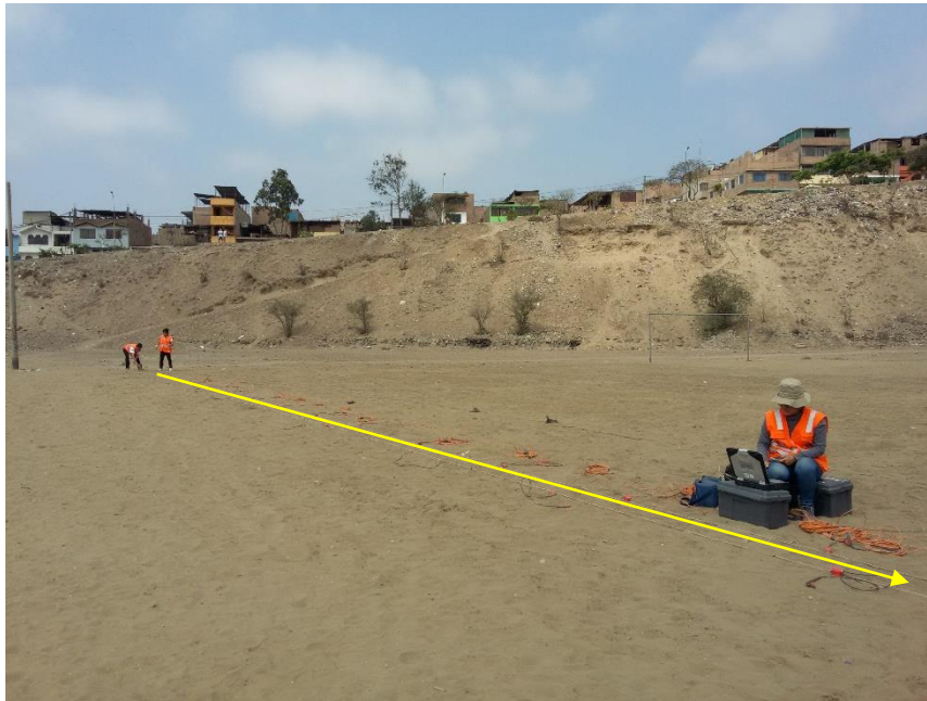
FOTO 09: MASW-09, se observa el instante de la generación de las ondas en un extremo del arreglo lineal de geófonos en el ensayo MASW. El ensayo fue realizado en un lugar ubicado entre la intersección de la calle Oropeza y calle Heraud.
