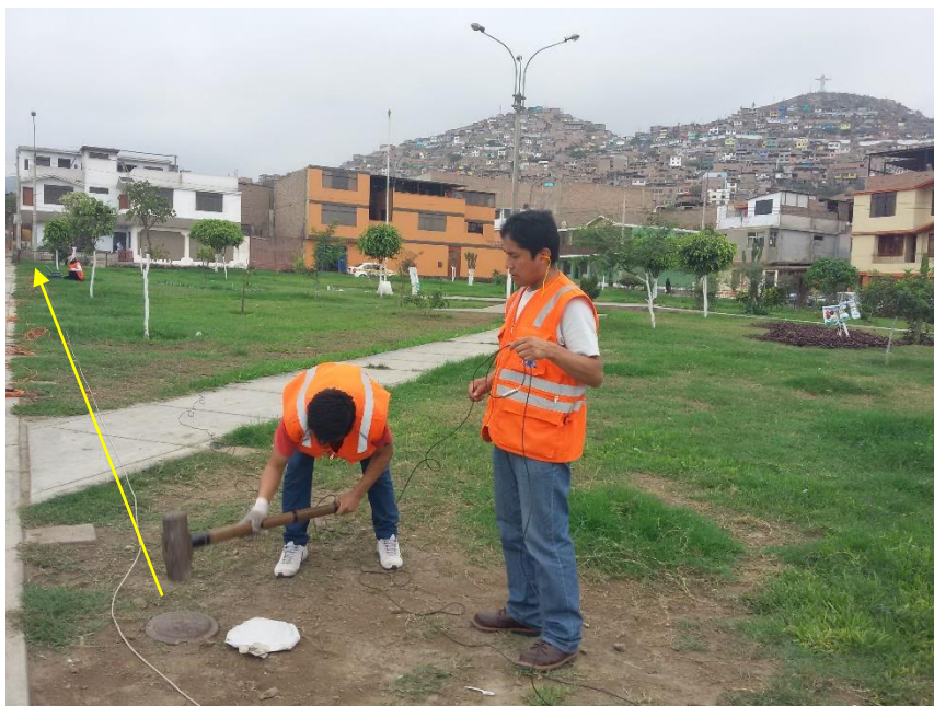
FOTO 06: MASW-06, se observa el instante de la generación de ondas superficiales mediante el golpe de un martillo sobre un plato de acero en la ejecución del ensayo MASW. Este ensayo fue realizado en el parque Arturo Armero ubicado en la intersección entre la Av. Cesar Canevaro y la calle Juan Guerra.
