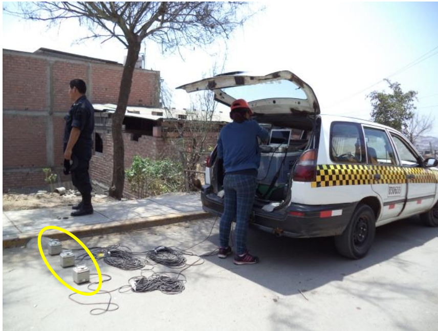
FOTO 25: M-25, se observa el instante de la toma de datos de los registros de microtemores captados mediante tres sensores ubicados cerca del cruce de la Av. Los Libertadores y San Genaro.
