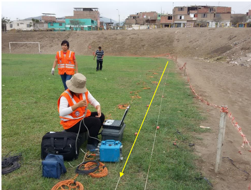
FOTO 05: MASW-05, se observa el instante de la conexión del adquisidor de datos con una computadora portátil en la ejecución del ensayo MASW llevado a cabo en una cancha de fútbol ubicado cerca a la intersección entre la Av. Edilberto Ramos y la calle Alfonso Ugarte.
