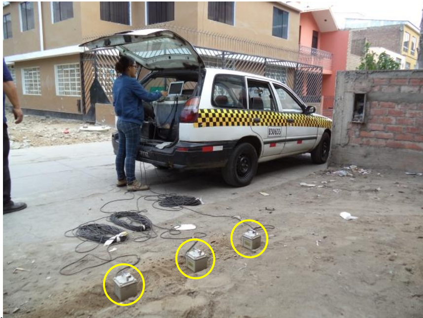
FOTO 21: M-21, se observa la ubicación de los sensores, para el registro de microtemores, a la espalda del parque Héroes de San Juan, cerca de Guillermo Billinghurst.
