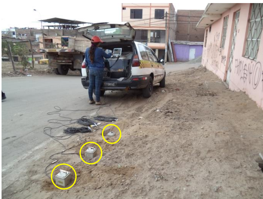
FOTO 10: M-10, se observa el instante de la toma de datos de los registros de microtemores captados mediante sensores, a una cuadra de la intersección de la Av. Micaela Bastidas y Las retamas.
