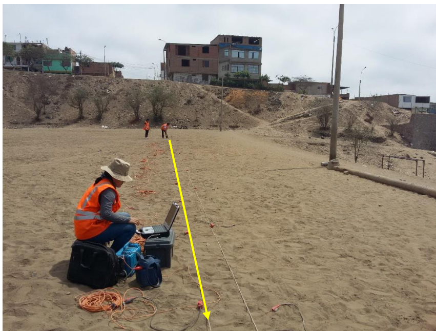
FOTO 09: LS-09, se observa el registro de datos mediante una computadora portátil y un adquisidor de datos en la ejecución del ensayo de refracción sísmica. Este ensayo fue realizado en un lugar ubicado entre la intersección de la calle Oropeza y calle Heraud.
