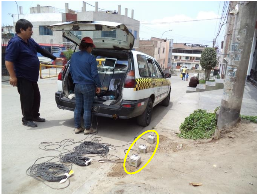
FOTO 13: M-13, se muestra la disposición de los sensores para la medición de microtemores realizado a una cuadra del cruce entre La Av. Víctor Castro Iglesias y la Av. Miguel Iglesias.
