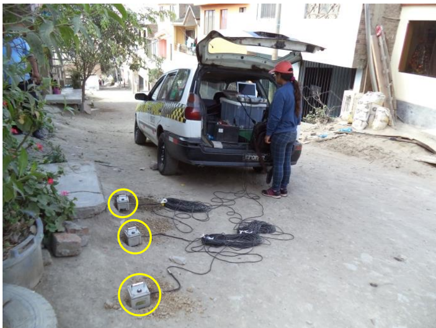
FOTO 28: M-28, se observa la ubicación de los sensores, para el registro de microtemores, a dos cuadras de la intersección de Simón Bolívar y Mariátegui.
