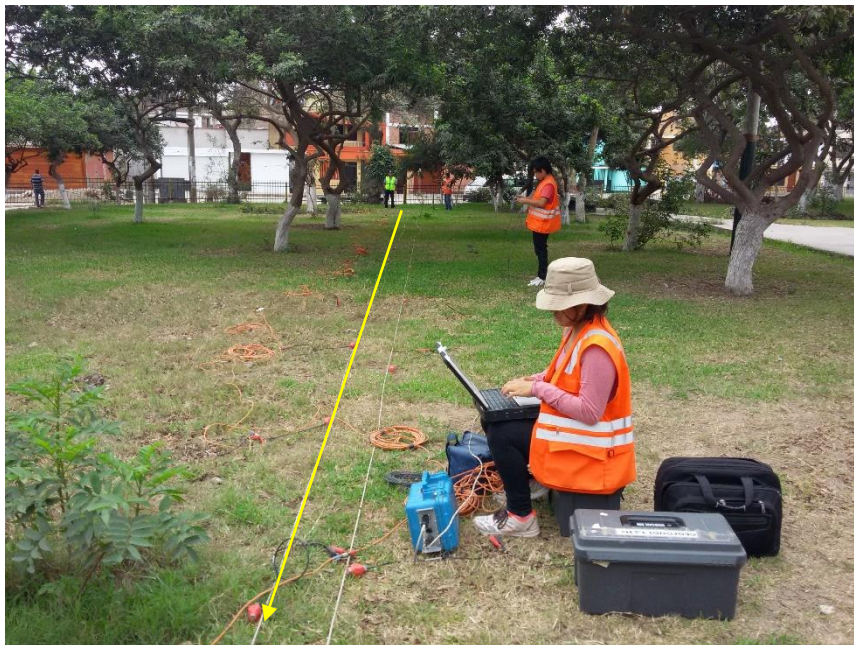
FOTO 12: MASW-12, se observa el instante previo a la generación de ondas superficiales para la ejecución del ensayo MASW. Este ensayo se realizó en el parque María Auxiliadora ubicado en la intersección entre la Av. Pedro José Miota y la calle Carrión.
