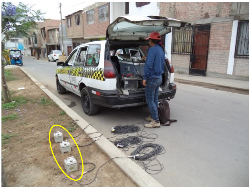
FOTO 06: M-06, se muestran los sensores, los cables y el equipo adquisidor de señales usado para la medición de microtemores, cerca de la Av. El Triunfo, a cuatro cuadras del cruce de 6 de Agosto y Las Brisas.
