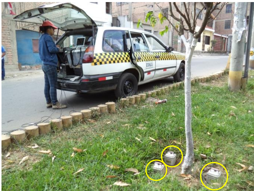
FOTO 20: M-20, se observa el instante de la toma de datos de los registros de microtemores captados mediante tres sensores ubicados al frente del parque Héroes de San Juan.
