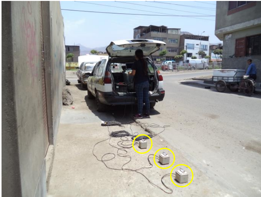
FOTO 23: M-23, se observa el instante de la toma de datos de los registros de microtemores captados mediante tres sensores ubicados en la intersección de la Av. Salvador Allende y Ferre.
