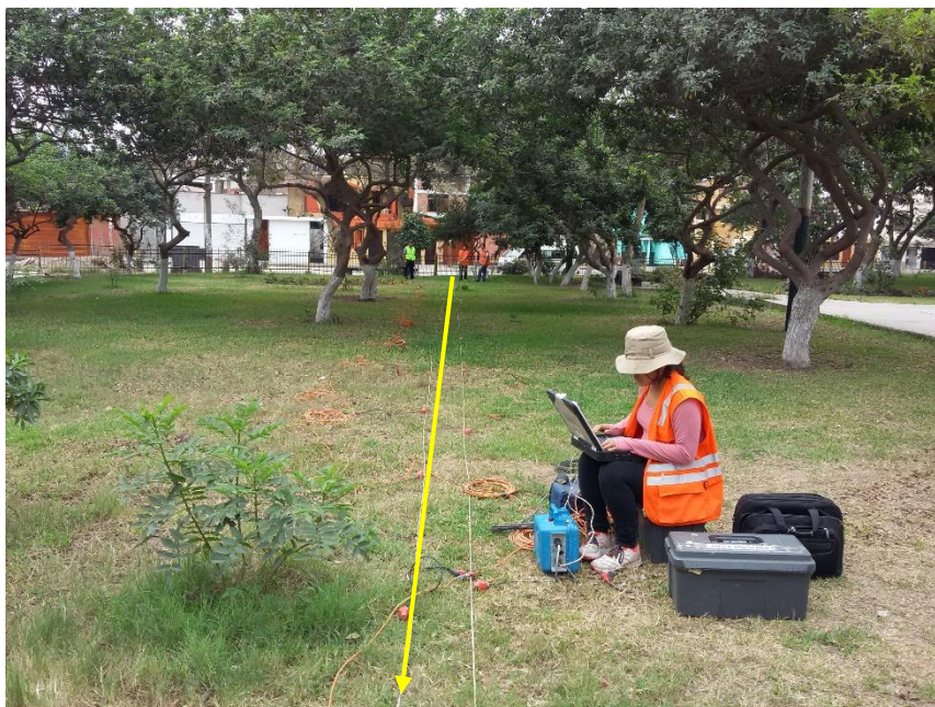
FOTO 12: LS-12, se observa el tendido de cables, conexión de geófonos y la configuración del equipo para la ejecución del ensayo de refracción sísmica. Este ensayo fue realizado en el parque María Auxiliadora ubicado en la intersección entre la Av. Pedro José Miota y la calle Carrión.
