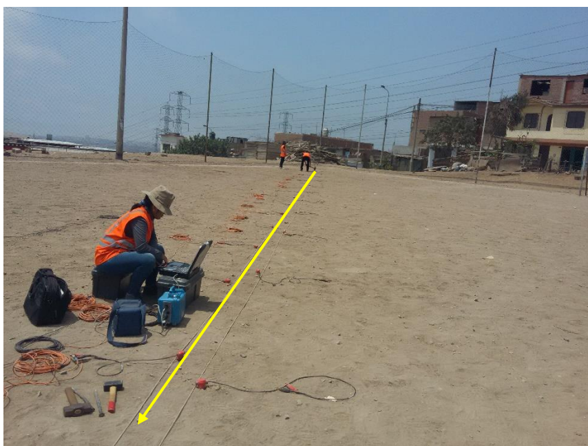
FOTO 08: LS-08, se observa el tendido de cables, conexión de geófonos y la configuración del equipo en la ejecución del ensayo de refracción sísmica. Este ensayo fue realizado cerca a la intersección entre la calle 3 y calle 4.
