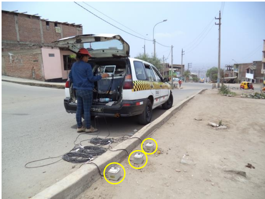
FOTO-14: M-14, se observa el instante de la toma de datos de los registros de microtemores captados mediante tres sensores, cerca de la intersección de la Av. Perimétrica y Héroes del Pacífico.
