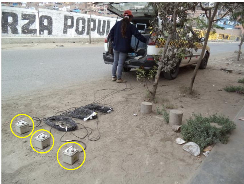
FOTO 42: M-42, se observa la disposición de los sensores para el ensayo de microtemores, realizado al costado del Complejo Deportivo De La Universidad Ricardo Palma, cerca de la Carretera Pan. Sur.
