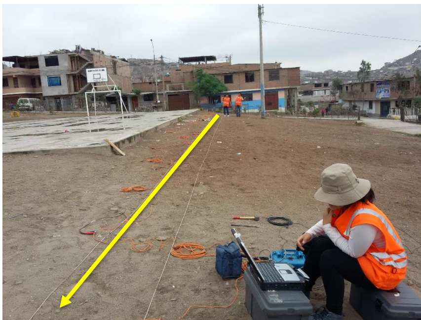
FOTO 03: LS-03, se observa el arreglo lineal de geófonos para el ensayo de refracción sísmica. Este ensayo fue realizado en el parque Leoncio Prado ubicado en la intersección entre la Av. Edilberto Ramos y calle Centenario.
