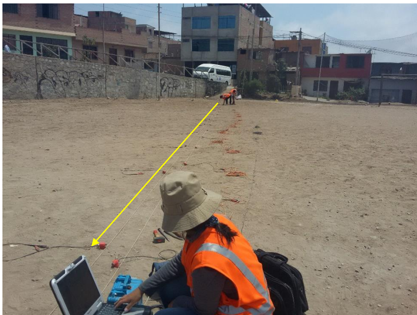
FOTO 08: MASW-08, se observa la configuración del equipo y el registro de ondas superficiales en la ejecución del ensayo MASW. Este ensayo fue realizado cerca a la intersección entre la calle 3 y calle 4.
