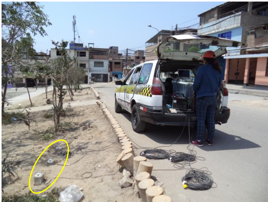
FOTO 26: M-26, se observa la ubicación de los sensores, para el registro de microtemores, frente a Pasaje. 59, en zona cercana al cruce de Av. San Juan y Los Corales.
