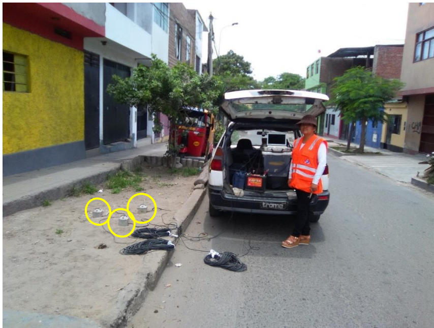
FOTO 53: M-53, se muestran los sensores y adquisidor de datos en el momento del registro de la vibración ambiental, realizado en el cruce de la calle Juan Guerra con el Jirón Julio Rodríguez.
