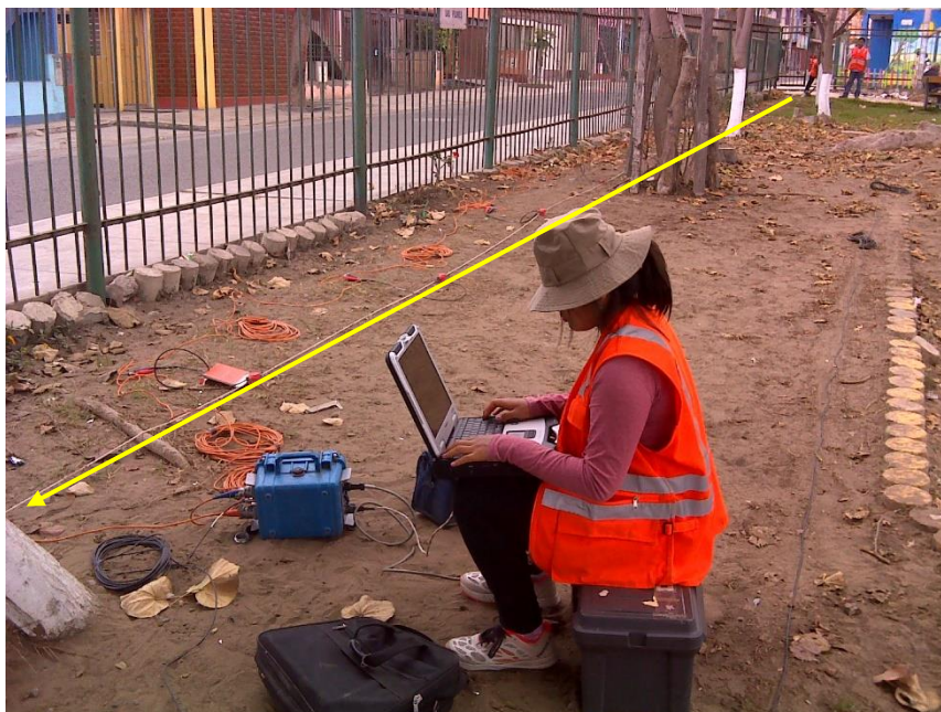
FOTO 14: LS-14, se observa el tendido de cables, conexión de geófonos y la configuración del equipo en la ejecución del ensayo de refracción sísmica. Este ensayo fue realizado en el parque Micaela Bastidas ubicado en la intersección entre la calle Oppenheimer y calle Velarde.
