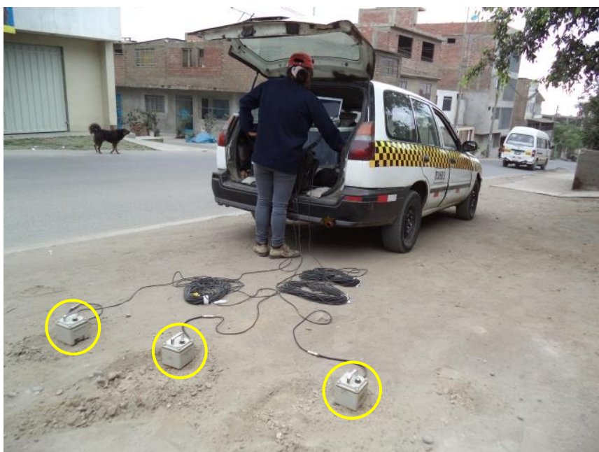
FOTO 36: M-36, se observa la ubicación de los sensores para el registro de microtemores, en el cruce de Solidaridad Abancay y Principal.
