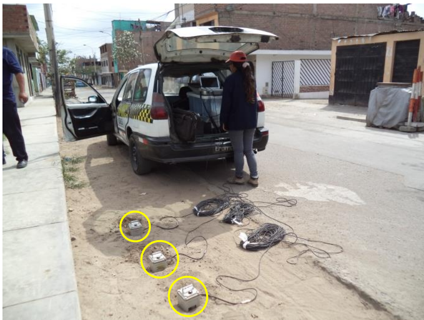
FOTO 40: M-40, se observa la ubicación de los sensores para el registro de microtemores, en la intersección de la Av. Antonio Bukingham y Manuel V. Arias.
