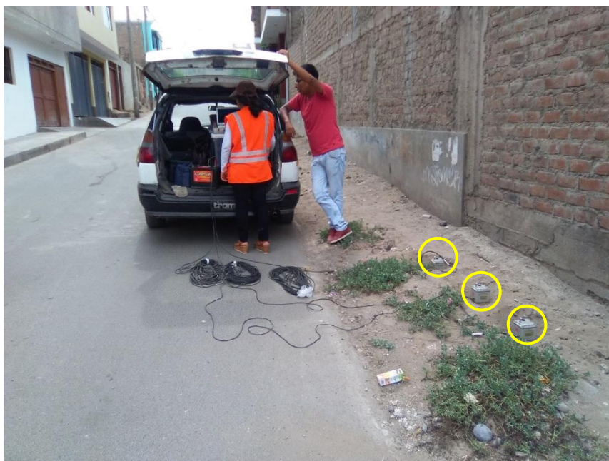
FOTO 49: M-49, se muestran los sensores del equipo de microtremores, en el cruce de las calles Los Andes y El Pueblo, a una cuadra de la Av. Los Eucaliptos.
