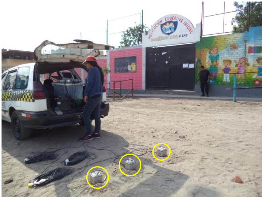
FOTO 29: M-29, se observa la ubicación de los sensores, para el registro de microtemores, frente a la I.E.I. Angelitos de Jesús N°640.
