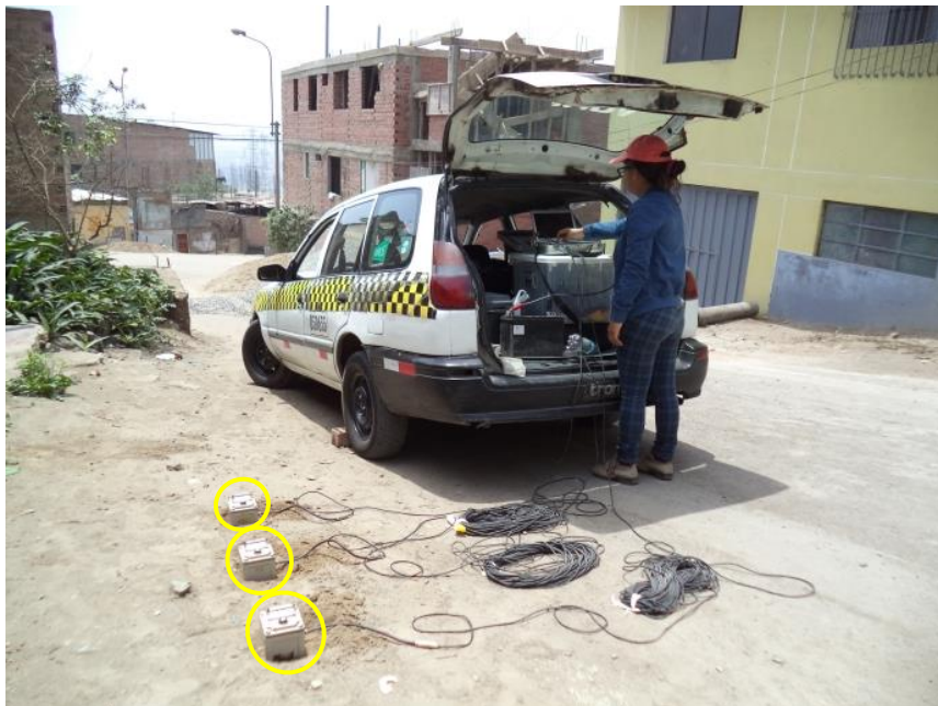
FOTO 15: M-15, se muestran los sensores en el momento del registro de la vibración ambiental, ubicado en el cruce de la Calle 14 y Reyes Velásquez Víctor Manuel.
