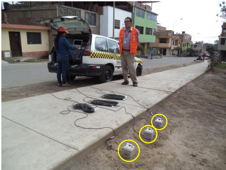
FOTO 09: M-09, se observa momento de medición de la vibración ambiental, a una cuadra de la Av. Mariano Pastor Sevilla, cruce de la Calle 5 y Calle 7.
