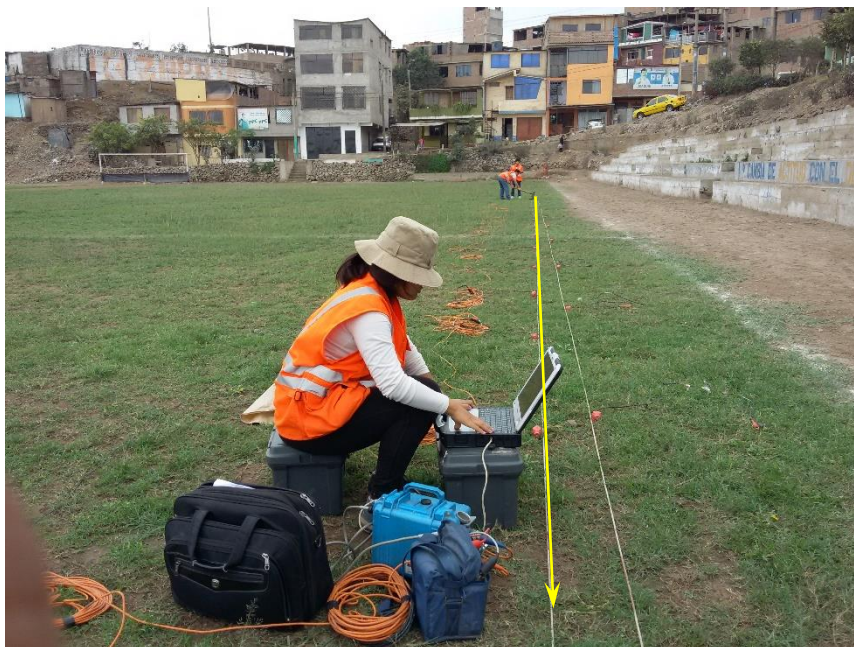
FOTO 04: MASW-04, se observa el instante del registro de las ondas producidas por el golpe de un martillo sobre un plato de acero en la ejecución del ensayo MASW. Este ensayo se realizó cerca al Puesto de Salud Virgen del Buen Paso.
