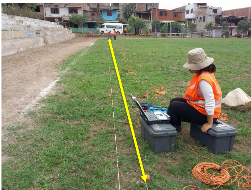
FOTO 04: LS-04, se observa el arreglo lineal de geófonos para el ensayo de refracción sísmica. Este ensayo fue realizado cerca al Puesto de Salud Virgen del Buen Paso.
