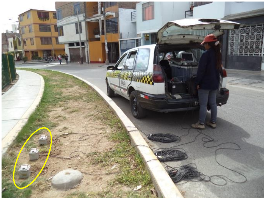
FOTO 41: M-41, se observa la toma de datos con el GEODAS y tres sensores para la medición de microtemores, realizado en el perímetro del Parque Confraternidad.
