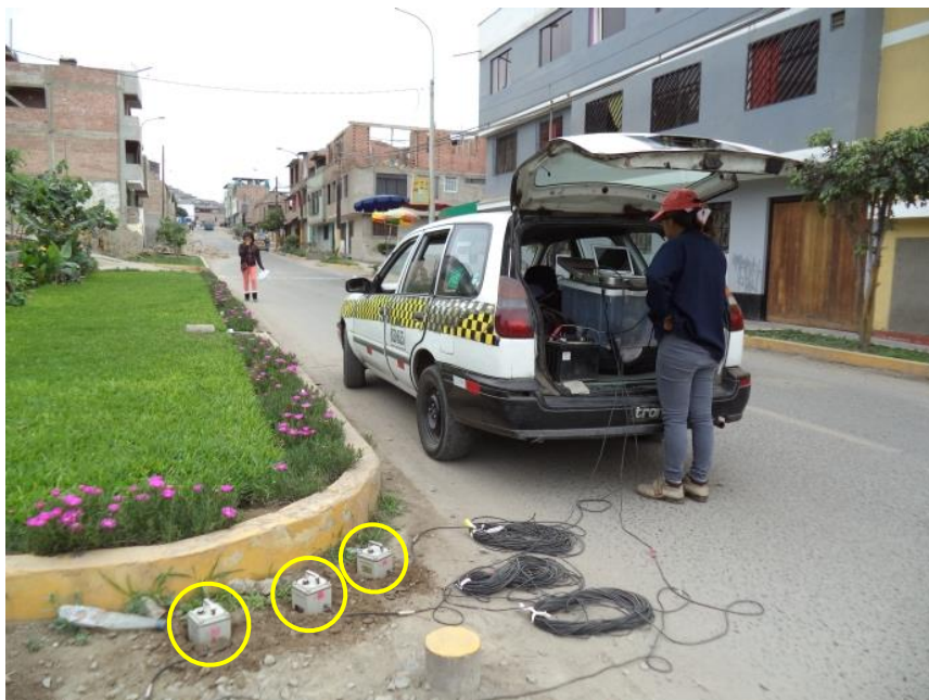
FOTO 38: M-38, se observa la ubicación de los sensores para el registro de microtemores, en el perímetro del Parque El Brillante.
