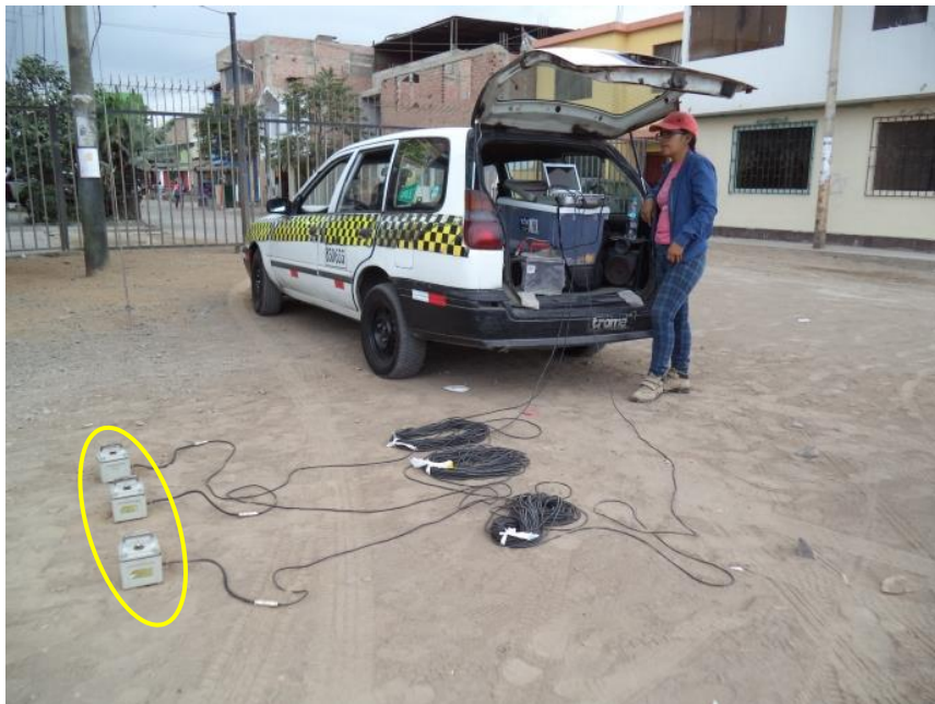
FOTO 03: M-03, se muestra la disposición del equipo de medición de microtemores (tres sensores, cables, adquisidor de datos), a una cuadra del cruce de la Calle C y Calle M, en zona aledaña al Parque América.
