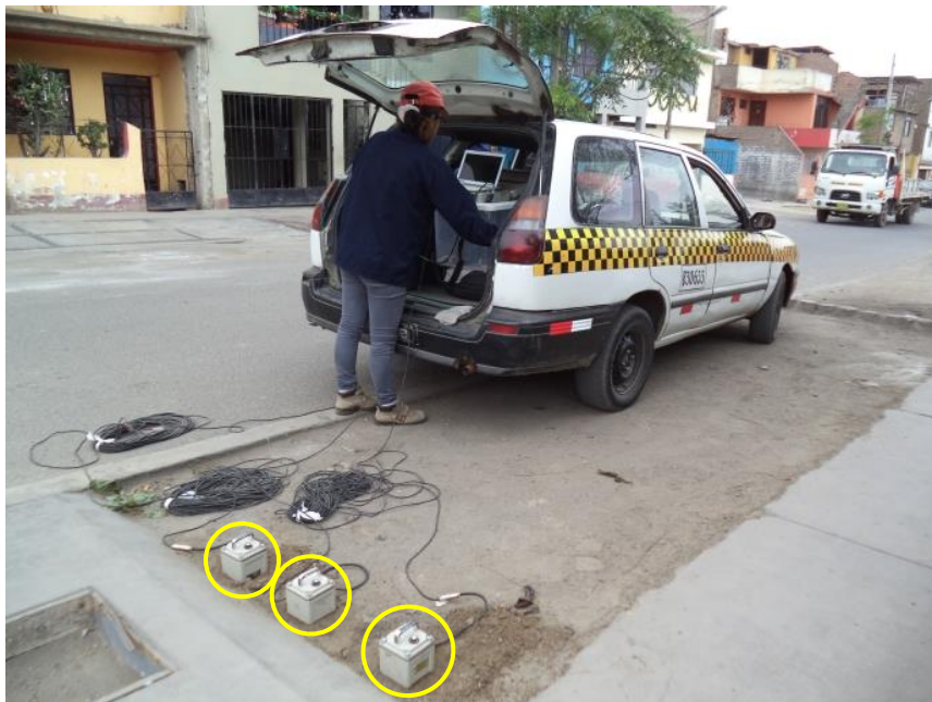
FOTO 39: M-39, se observa la ubicación de los sensores para el registro de microtemores, a pocos metros del cruce de Guadalupe Haure y la Calle Daniel Velez.
