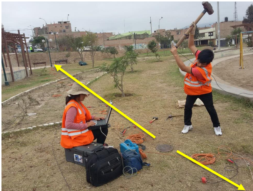
FOTO 11: LS-11, se observa el instante de la generación de ondas en el centro de la línea del ensayo de refracción sísmica. Este ensayo fue realizado en el parque Umamarca ubicado en la intersección entre la calle Los Liros y calle Huancarama.
