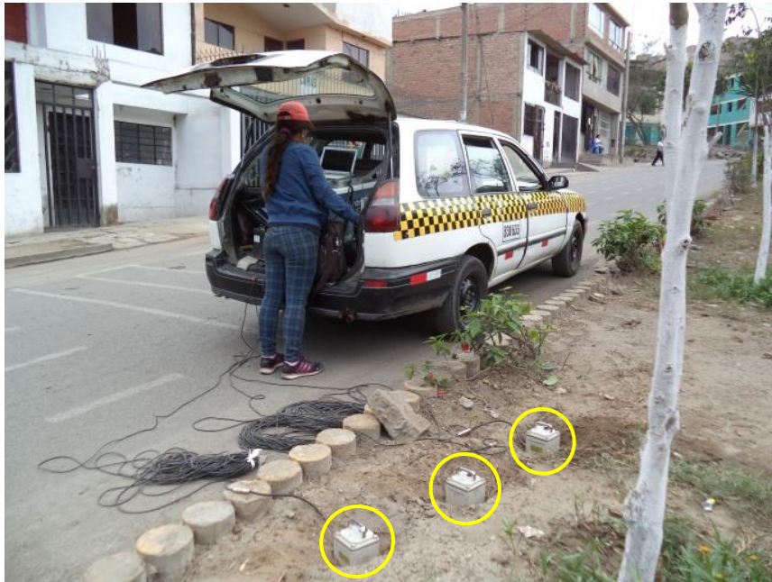
FOTO 31: M-31, se observa la ubicación de los sensores para el registro de microtemores, en el Parque Central 12 de Noviembre.
