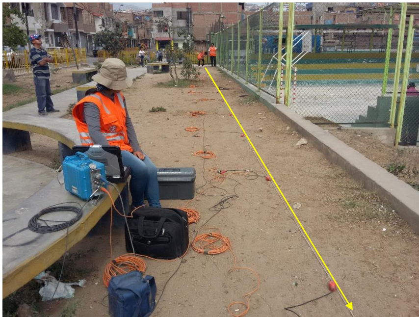
FOTO 10: MASW-10, se observa la generación de ondas superficiales en un extremo del arreglo lineal de geófonos, además del registro de ondas mediante el adquisidor de datos y una laptop. Este ensayo fue realizado al costado del Policlínico Sagrada Familia ubicado en la calle 4.
