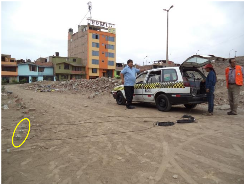
FOTO 01: M-01, se observa la toma de datos con el GEODAS y tres sensores para la medición de microtremores, realizado al frente del I.E. 7081 José María Arguedas.
