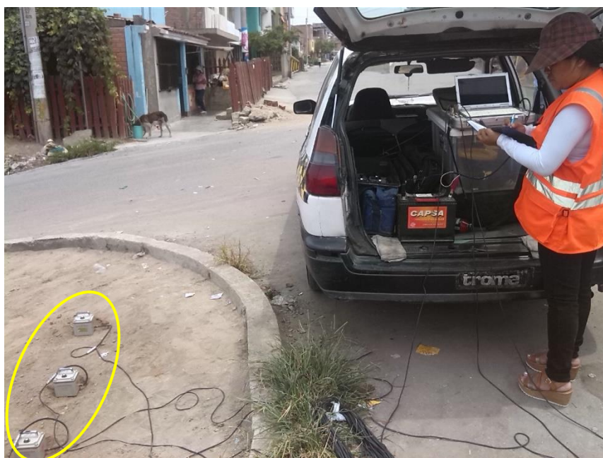
FOTO 48: M-48, se muestra la disposición del equipo de medición de microtremores (tres sensores, cables, adquisidor de datos), en el cruce de la calle Mateo Pumacahua y la Calle 17.
