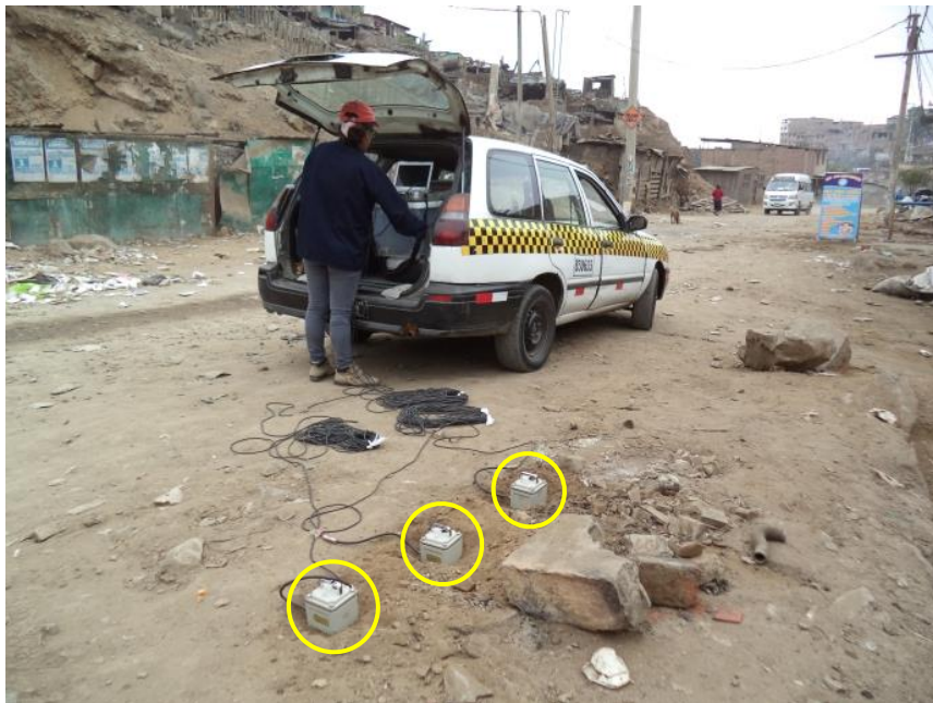
FOTO 35: M-35, se observa la ubicación de los sensores para el registro de microtemores, en Las Terrazas. En zona cercana a la Av. Edilberto Ramos.
