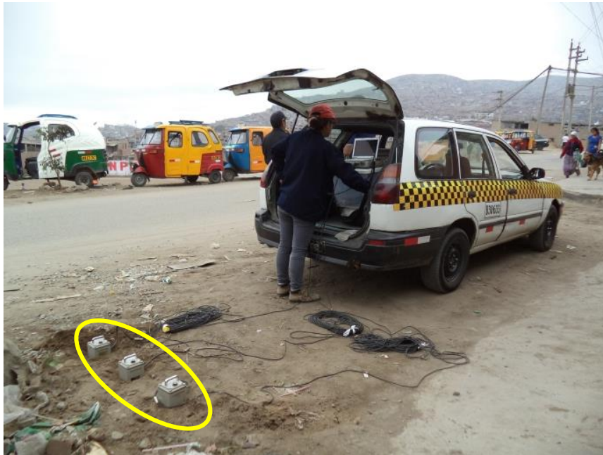
FOTO 33: M-33, se observa la ubicación de los sensores, para el registro de microtemores, cerca al cruce de Cartago y Camino Real.
