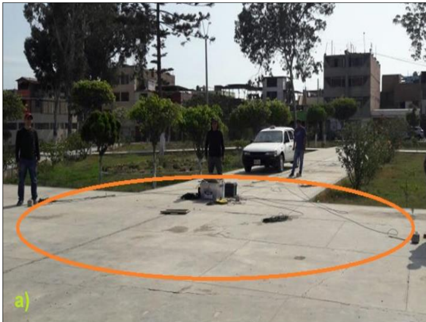
FOTO 02: A-02, se observa la disposición de sensores alrededor del arreglo circular de 5m de radio. Este ensayo fue realizado en el parque Micaela Bastidas ubicado en el parque Reducto N°4.
