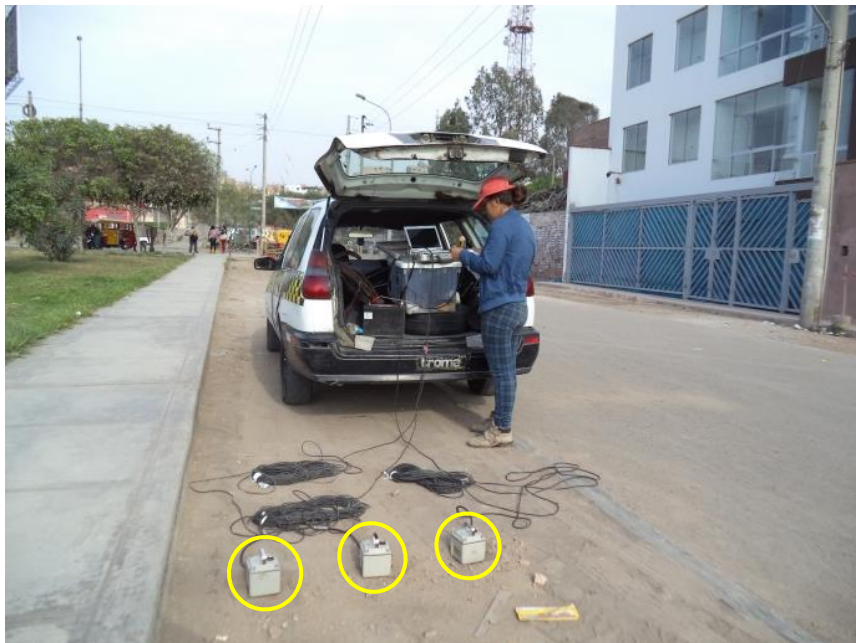
FOTO 22: M-22, se observa la ubicación de los sensores para el registro de microtemores, frente al cruce de la Av. Pedro Miotta y G. de la Vega.
