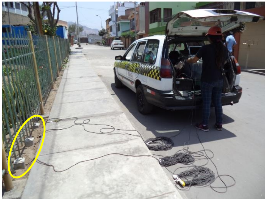
FOTO 24: M-24, se observa la ubicación de los sensores para el registro de microtemores, en el Parque 13 de Enero.
