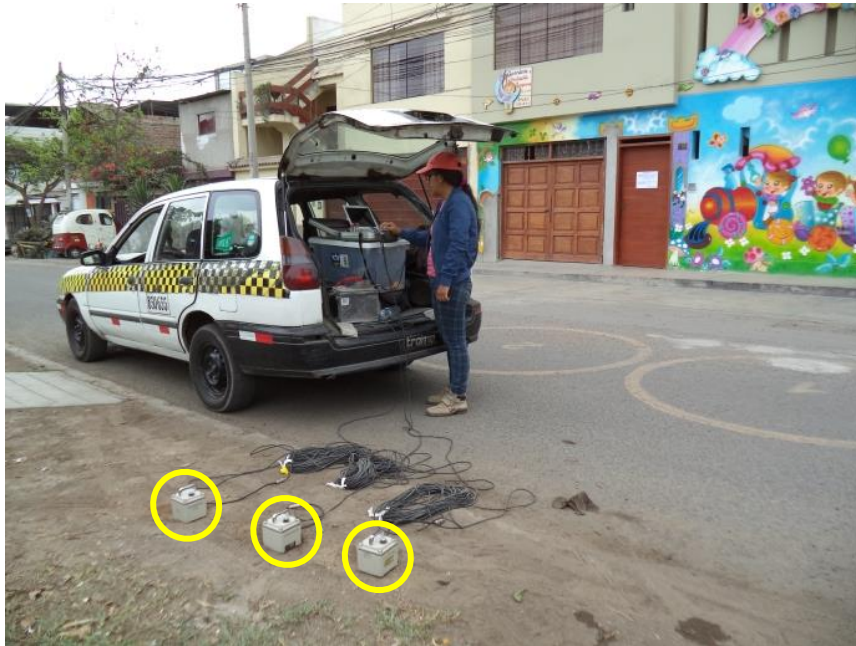
FOTO 07: M-07, se muestra la ubicación de los sensores en el proceso de medición de los microtemores, en el cruce de Los Eucaliptos y Violetas, cerca de la Av. Víctor Castro Iglesias.
