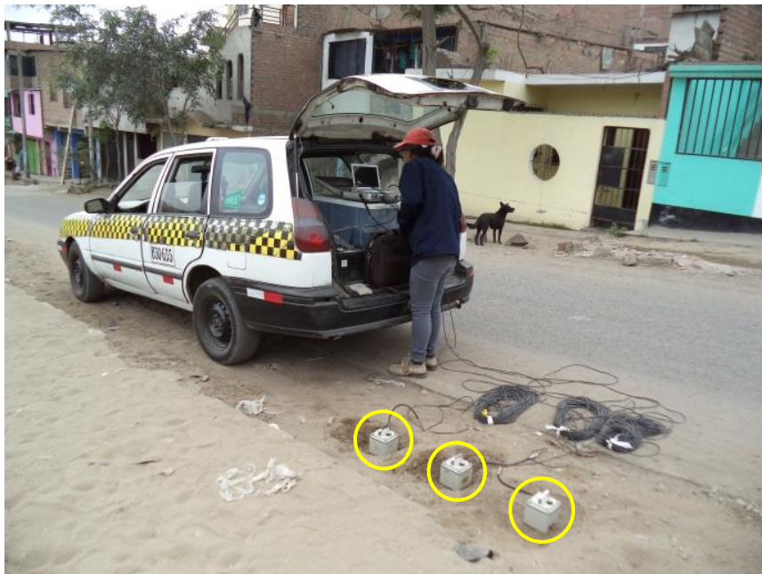
FOTO 37: M-37, se observa la ubicación de los sensores para el registro de microtemores, frente al Parque El Bosque, cerca de Andrés Avelino Cáceres.
