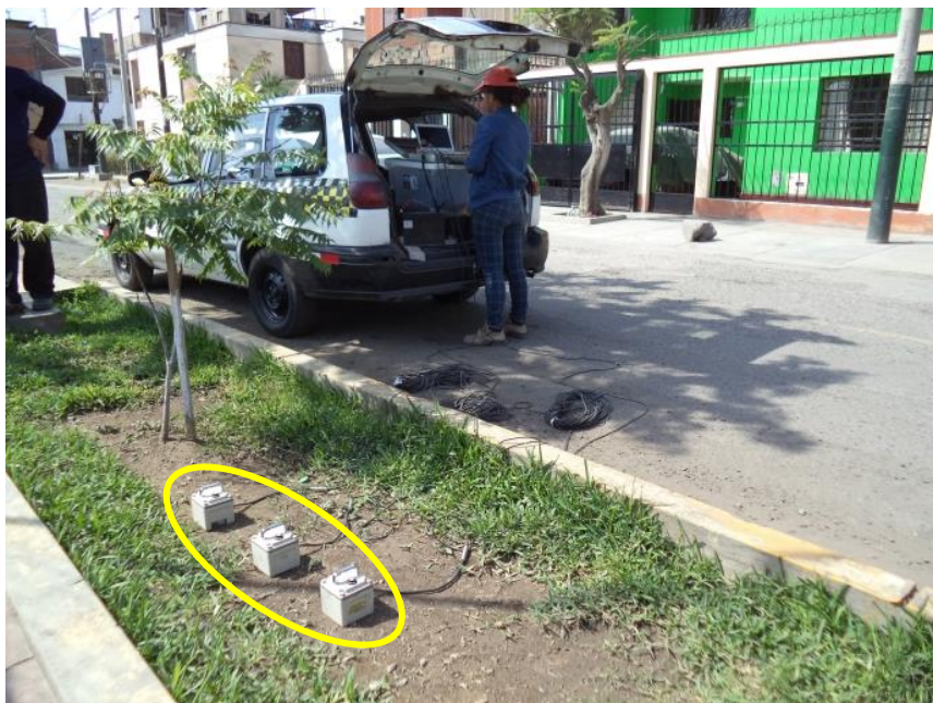
FOTO 18: M-18, se observa el instante de la toma de datos de los registros de microtemores captados mediante tres sensores ubicados en el cruce de Maximiliano Carranza y Baltazar Grados Cuadro.
