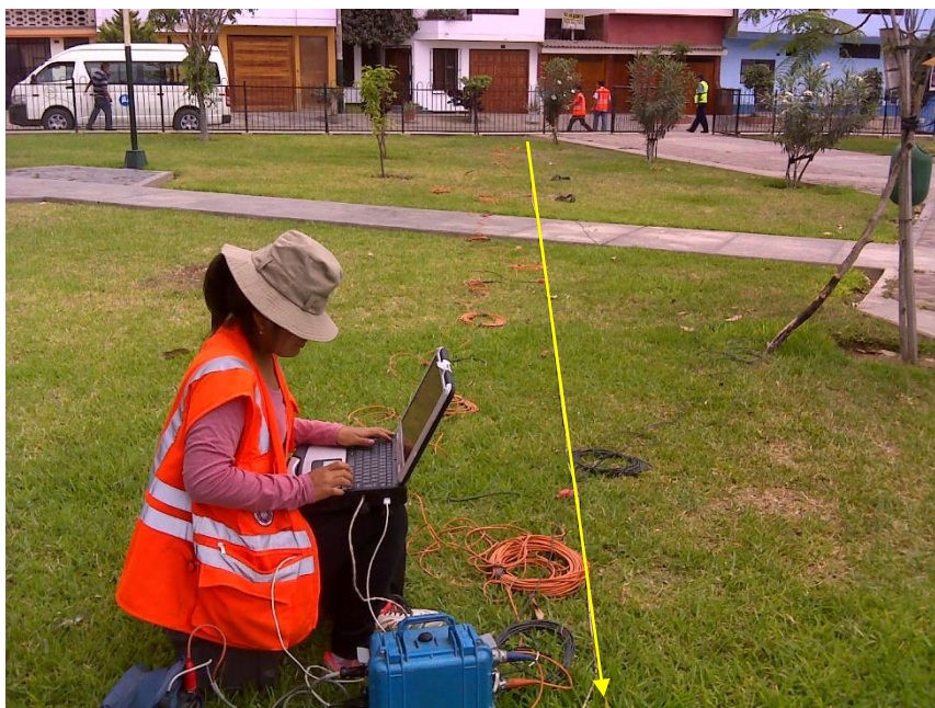
FOTO 13: MASW-13, se observa la configuración del equipo para el registro de las ondas superficiales. Este ensayo fue realizado en el parque Amistad ubicado en la intersección entre calle Las Fresas y calle Las Ciruelas.
