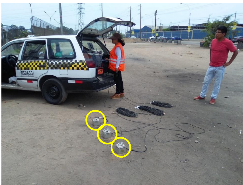
FOTO 52: M-52, se muestra la ubicación de los sensores en el proceso de medición de los microtemores, en el cruce las Av. Calango y Pedro Miotta.
