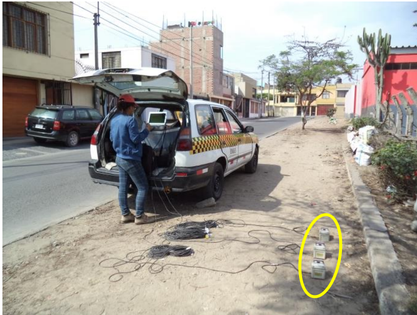
FOTO 19: M-19, se observa la ubicación de los sensores, para el registro de microtemores, en la intersección del Jr. Joaquín Bernal y Antonio Oliveira.
