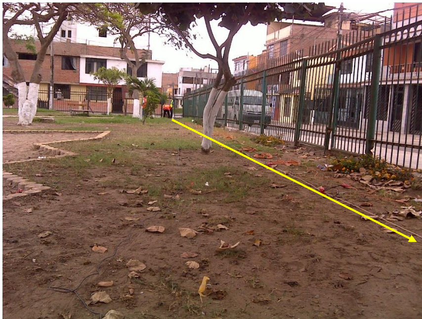
FOTO 07: LS-07, se observa el arreglo lineal de geófonos y el tendido de cables en el la ejecución del ensayo de refracción sísmica.
