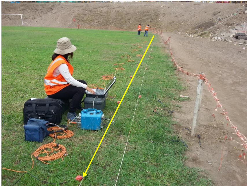
FOTO 05: LS-05, se observa el instante del registro de las ondas sísmicas con el equipo adquisidor de datos. Este ensayo fue realizado en una cancha de fútbol ubicado cerca a la intersección entre la Av. Edilberto Ramos y la calle Alfonso Ugarte.
