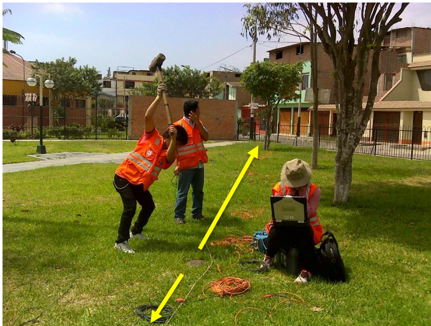
FOTO 13: LS-13, se observa el instante de la generación de ondas mediante el golpe de un martillo sobre un plato de acero. Este ensayo de refracción sísmica fue realizado en el parque Amistad ubicado en la intersección entre calle Las Fresas y calle Las Ciruelas.
