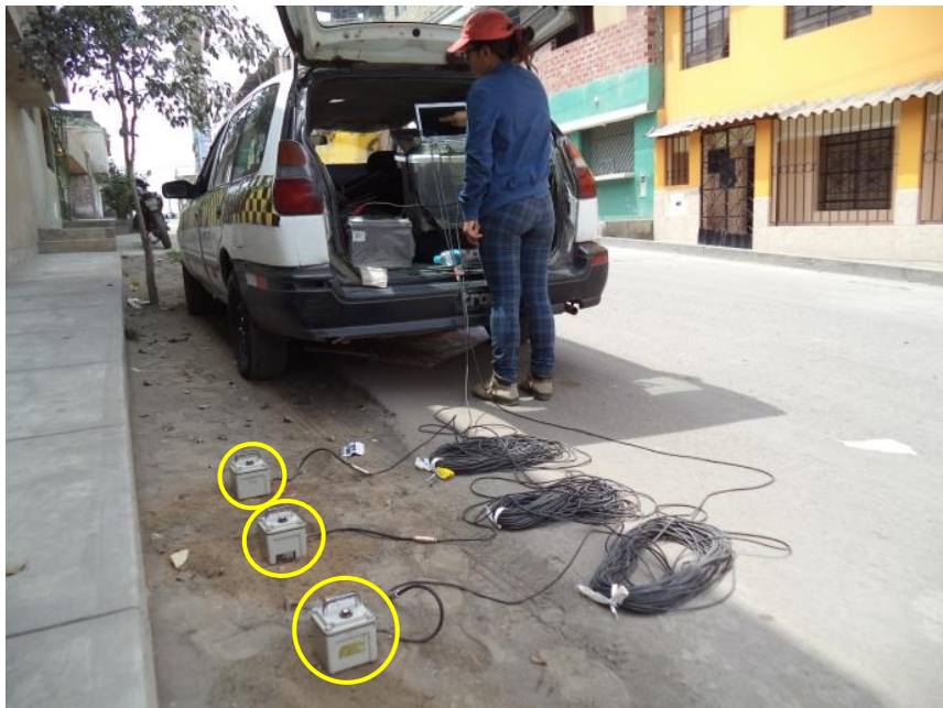
FOTO 12: M-12, se observa el instante del registro de las ondas de microtremores, en el cruce de San Francisco y la Calle I, cerca de la Av. Miguel Iglesias.
