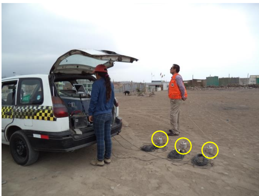
FOTO 04: M-04, se muestran los sensores del equipo de microtemores, entre el Jr. Leoncio Prado y Los Rosales.
