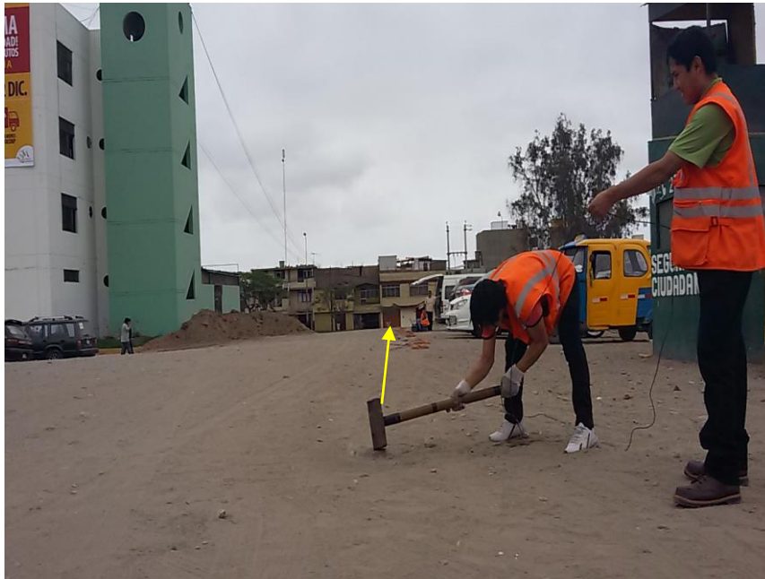
FOTO 01: LS-01, se observa la generación de ondas sísmicas mediante el golpe de un martillo sobre un plato metálico en la ejecución del ensayo de refracción sísmica. Este ensayo se realizó al costado de la Municipalidad de San Juan De Miraflores.
