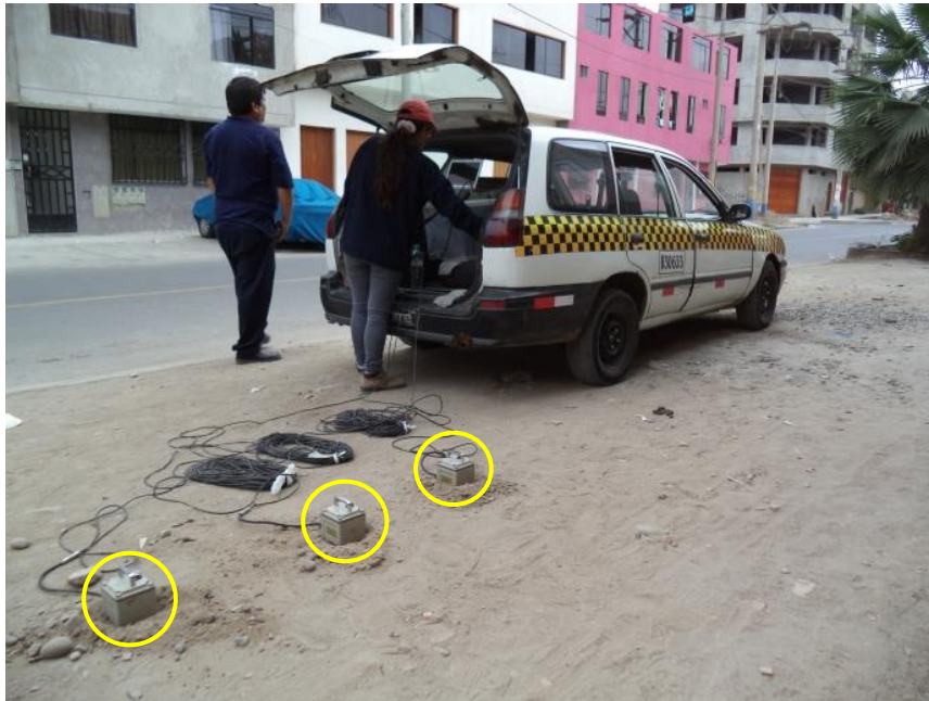
FOTO 43: M-43, se muestra la disposición del equipo de medición de microtemores (tres sensores, cables, adquirente de datos), cerca del cruce de El Bosque y Azucenas.
