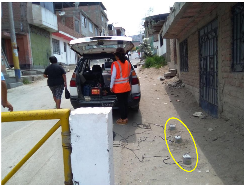
FOTO 46: M-46, se observa la toma de datos con el equipo de medición de microtemores, realizado en el cruce de las calles Ayala y Heraud, frente a un mercado pintado con el logo de MI BANCO.
