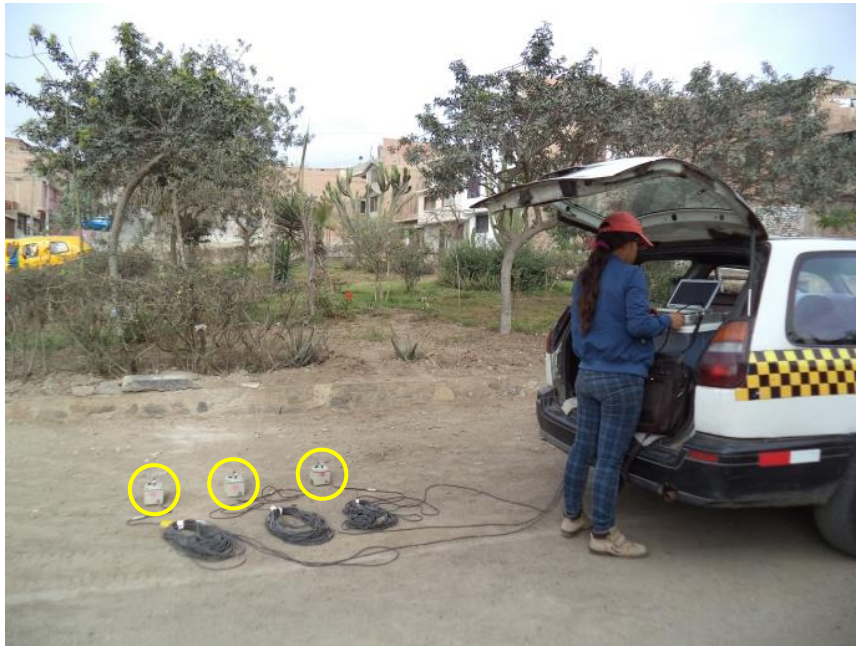
FOTO 11: M-11, se muestran los sensores y los cables usados para la medición de la vibración ambiental del suelo, en la intersección de Los Jazmines y Los Tulipanes.
