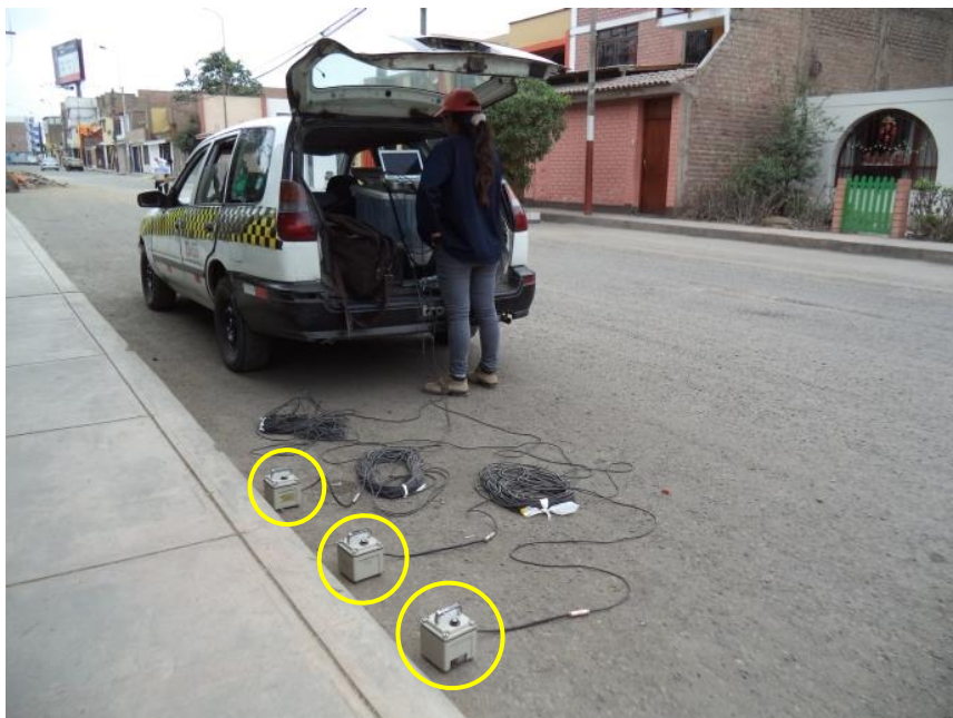
FOTO 44: M-44, se muestran los sensores del equipo de microtemores, en la Calle Carrión, frente al Parque María Auxiliadora.
