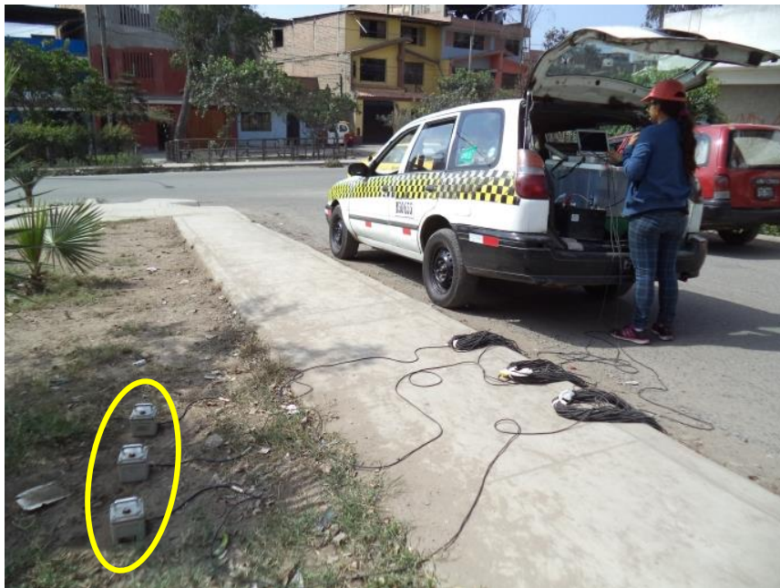
FOTO 27: M-27, se observa el instante de la toma de datos de los registros de microtemores captados mediante tres sensores ubicados en el cruce de Los Laureles y Calle P1.
