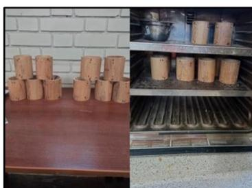
Determinar las dimensiones (4 diámetros, 4 alturas y 4 espesores), del espécimen inicial con Vernier.
