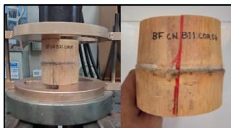
Se coloca el dispositivo de corte inferior en la máquina, teniendo en consideración que su posición se encuentre centrada con respecto a la probeta.
