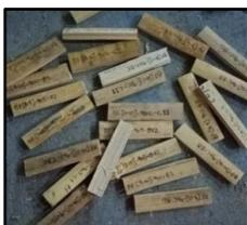
Pesar las probetas antes del secado con una balanza (error  $\pm 0.01$  gr.)
