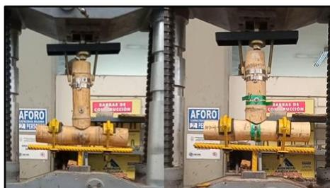
Debido a la geometría de las uniones perpendiculares se utilizó una armadura metálica para que la unión se pudiera adaptar a la máquina de ensayo.
