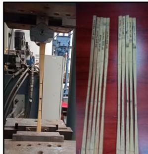
Se colocan las mordazas planas con textura y nivel de rugosidad específica para que no se presenten deslizamientos de las probetas.
