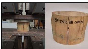
Se colocaron 2 placas metálicas, en la parte superior e inferior de la probeta para distribuir la carga uniformemente. Luego se coloca la celda de carga encima de la placa metálica superior.
