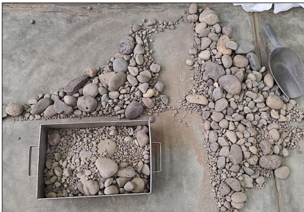
Figura 72. Fotografía del cuarteo del material gravoso retenido en el tamiz N°04 y pasante al tamiz de 3".
