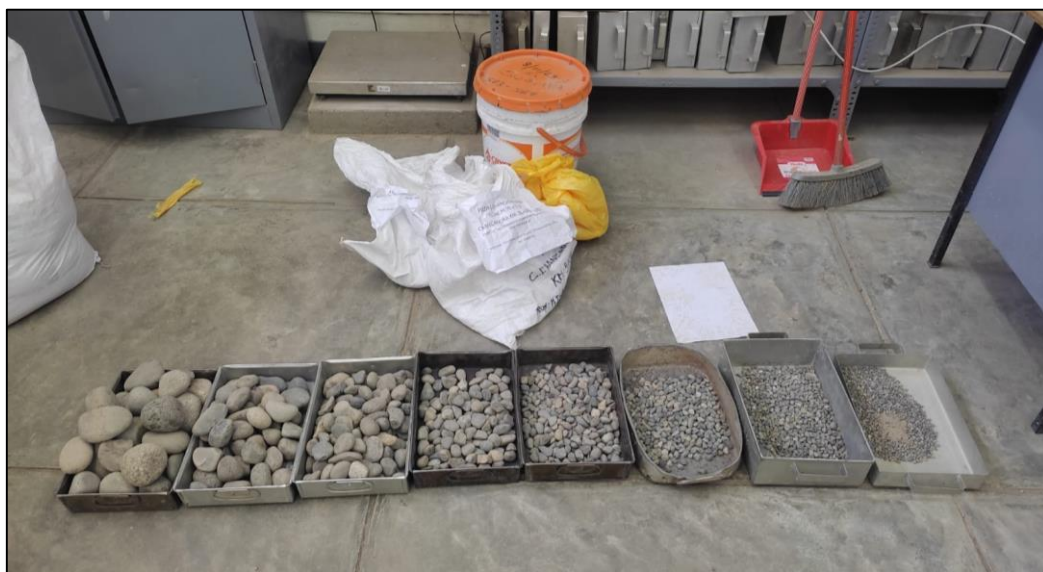
Figura 69. Fotografía del tamizado del suelo pasante por el tamiz de 3".
