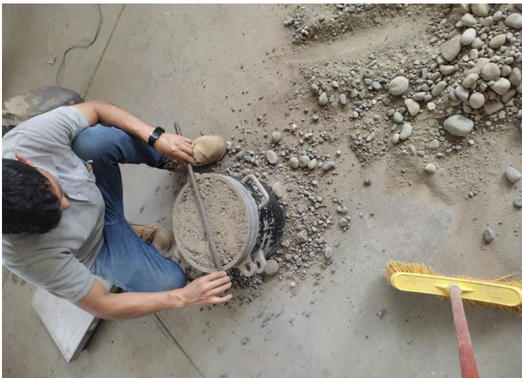
Figura 75. Fotografía del procedimiento de enrasado del material en el cilindro graduado.
