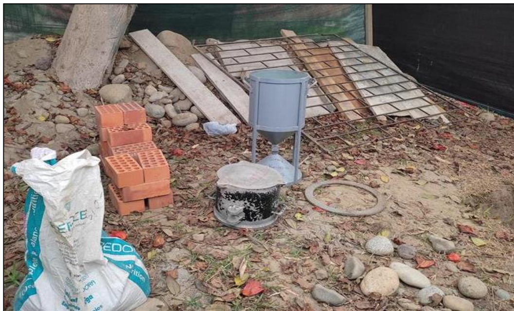
Figura 67. Fotografía de los equipos empleados para la realización del ensayo de cono arena modificado.
