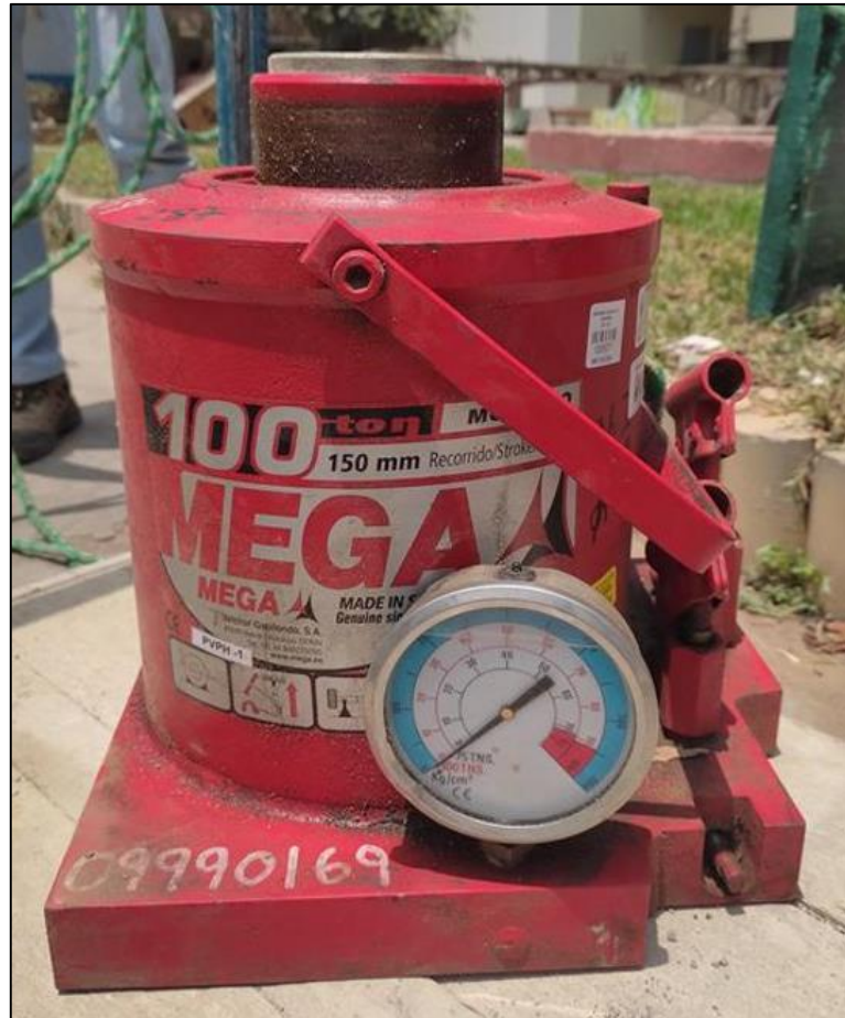
Figura 32. Fotografía de la gata hidráulica modelo MGD-100 fabricada por la compañía española MEGA
