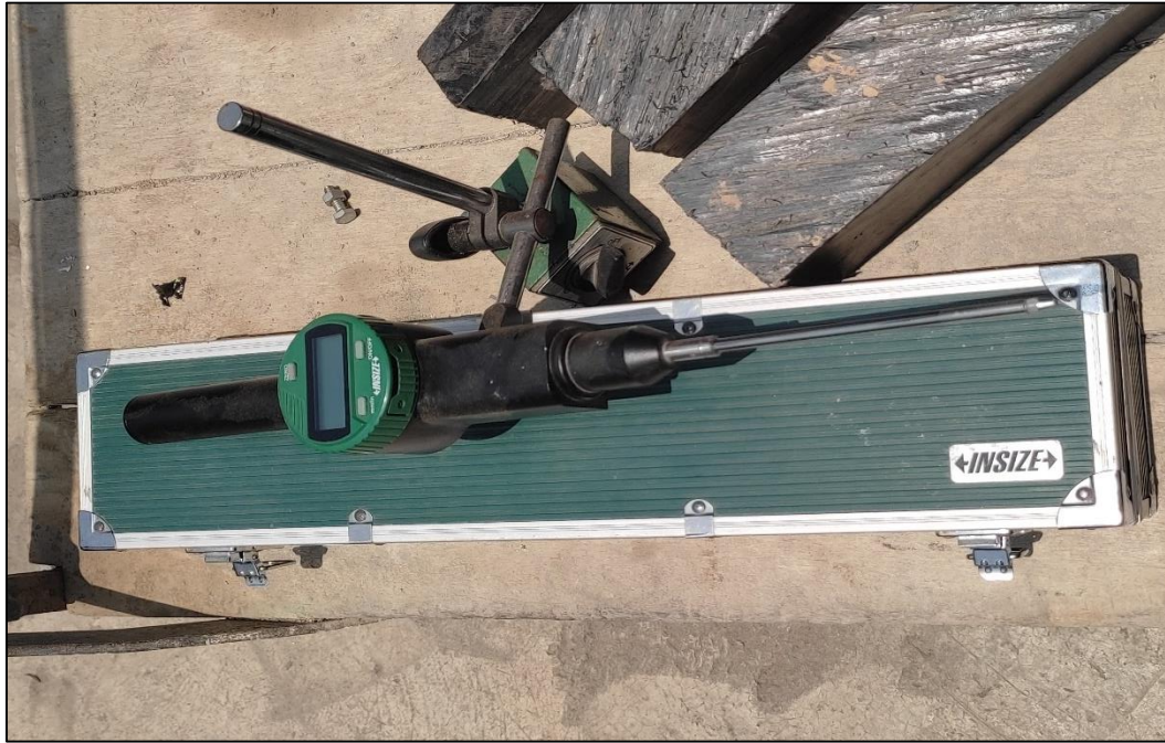
Figura 34. Fotografía del deformímetro digital modelo 2145, fabricado por la empresa china INSIZE con un soporte magnético.
