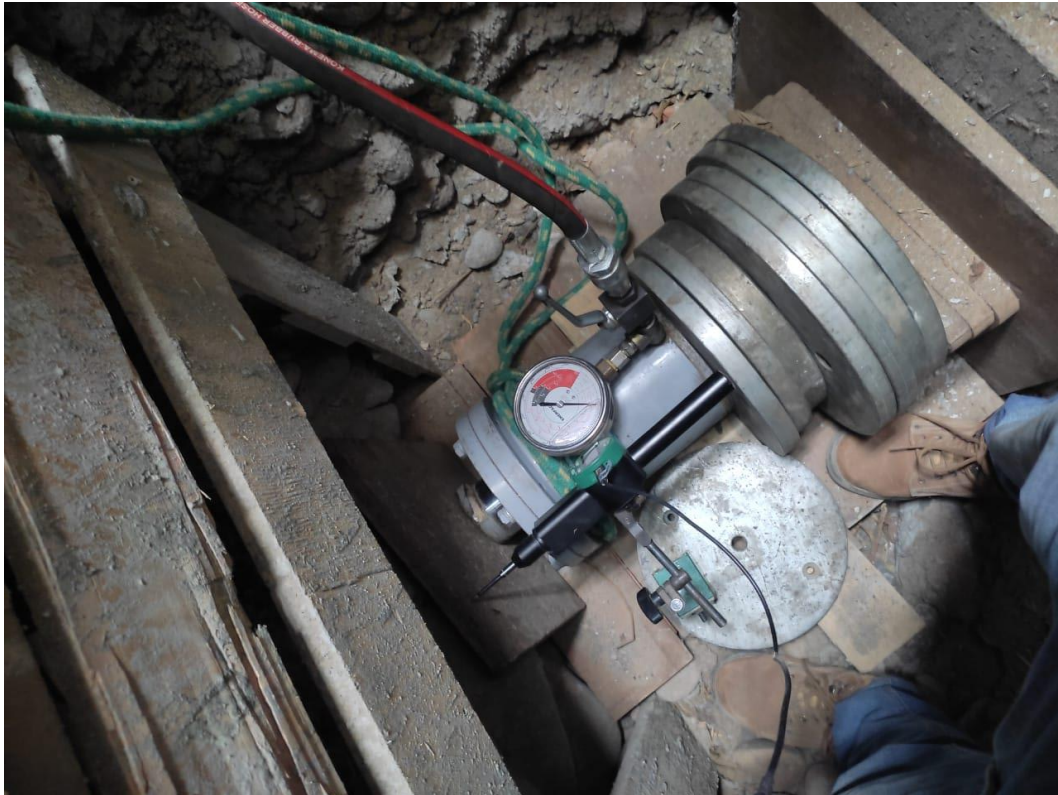
Figura 49. Fotografía del procedimiento de ejecución de la tercera prueba de carga horizontal.
