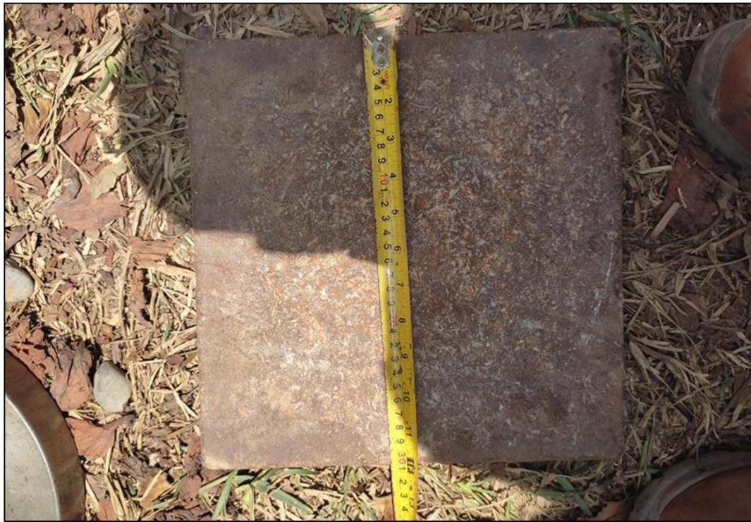
Figura 37. Fotografía de la placa cuadrada de 30cm de lado y espesor de 2 pulgadas, designada como placa de contacto
