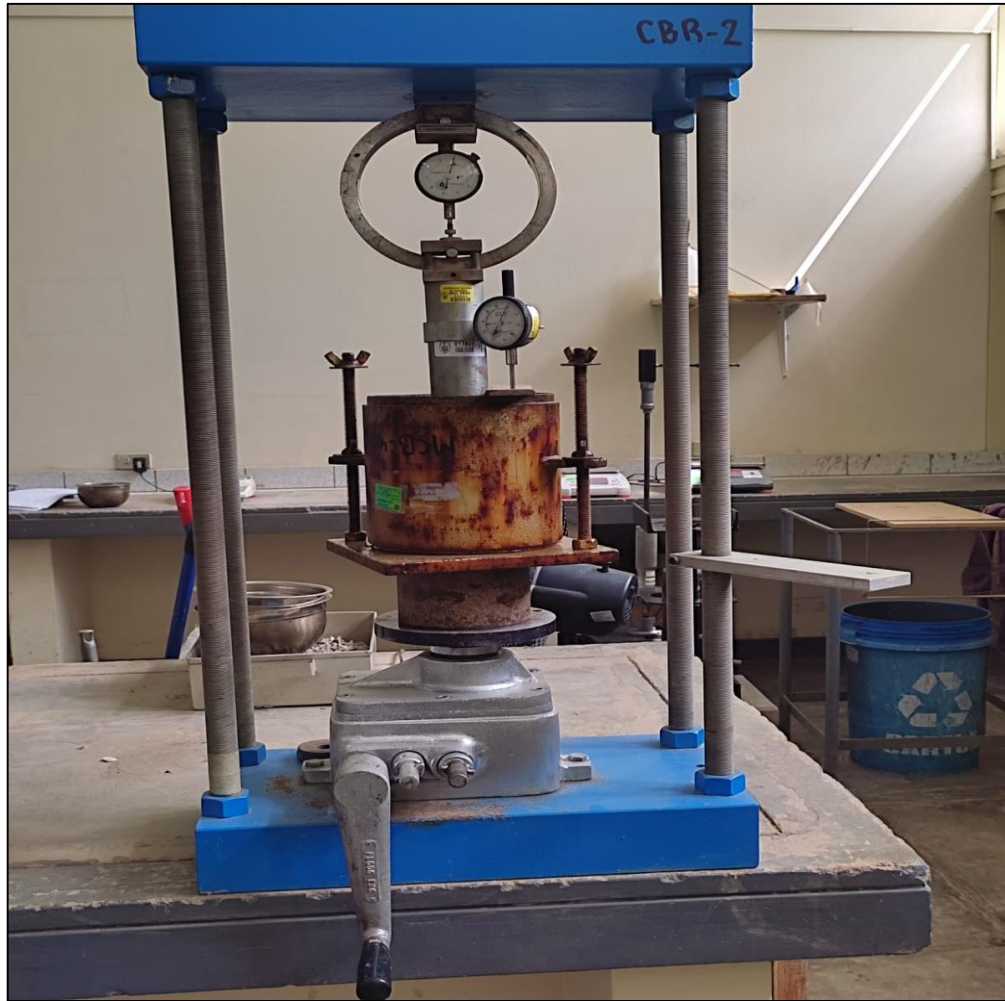
Figura 81. Fotografía del procedimiento de penetración mediante la prensa CBR.
