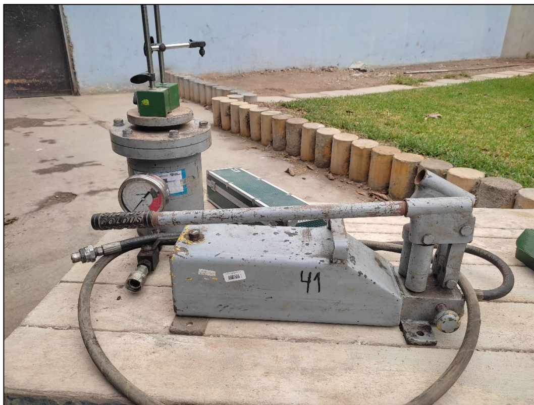
Figura 33. Fotografía de la gata hidráulica fabricada por la compañía americana ENERPAC, con una extensión de la palanca de la gata mediante una manguera hidráulica.
