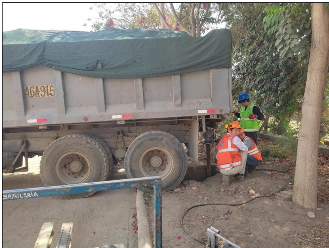
Figura 40. Fotografía del volquete cargado para restringir la deformación en el lado de reacción
