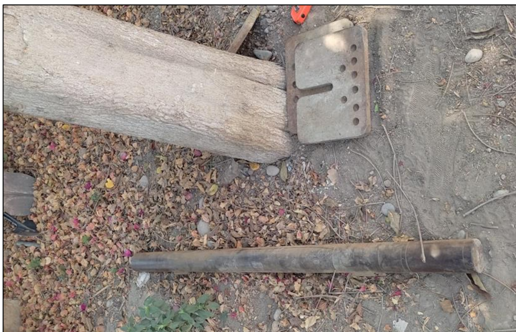
Figura 39. Fotografía de la barra maciza de 1.50m de longitud y 3 pulgadas de diámetro, para ser empleada en la prueba de carga vertical
