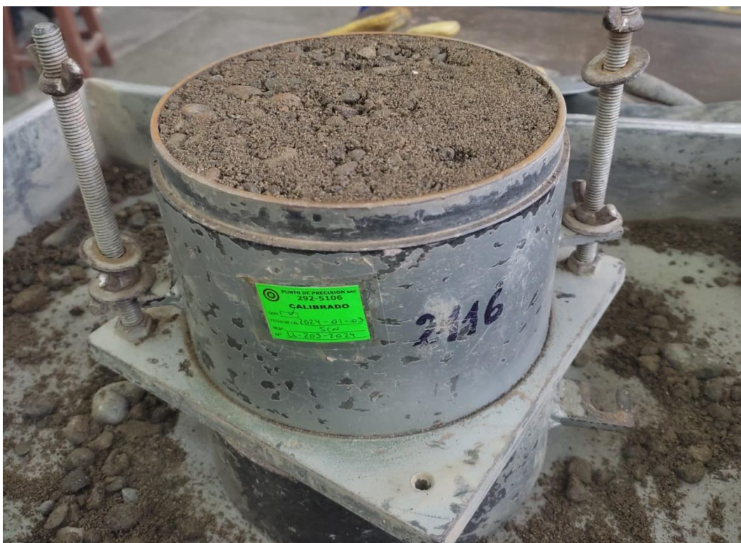
Figura 78. Fotografía del material de grava compactada y humedecido en el molde calibrado.
