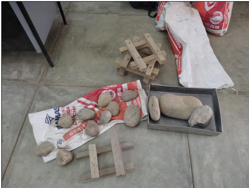
Figura 70. Fotografía del tamizado con las mallas de madera de 3", 4", 5" y 6".
