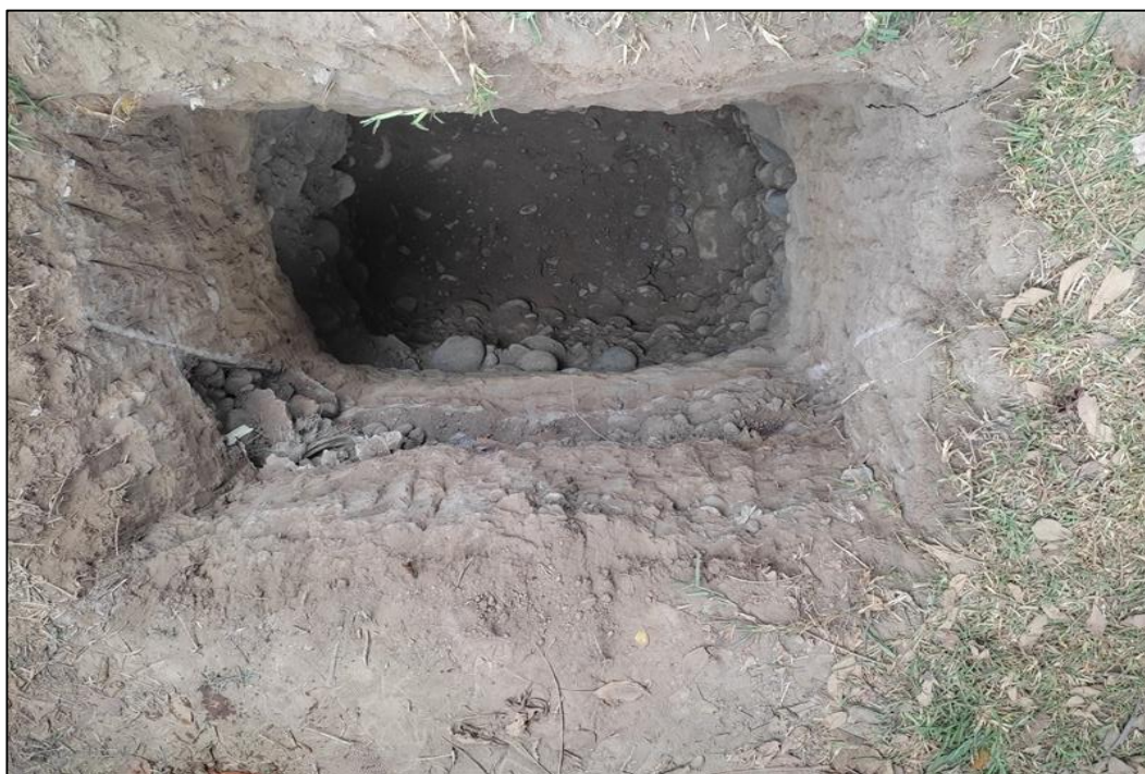
Figura 28. Fotografía de la calicata C-01 de 2.30m de profundidad, donde se observa una capa superficial de 1.30m de relleno de arcilla, continuando con suelo natural gravoso
