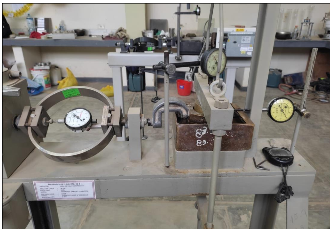
Figura 73. Fotografía del procedimiento del ensayo de corte directo de la matriz del suelo.
