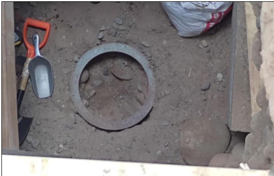
Figura 68. Fotografía del procedimiento del ensayo de cono de arena modificado.
