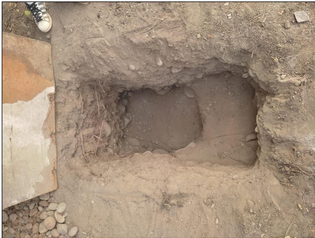
Figura 31. Fotografía de la calicata C-02 de 1.00m de profundidad, donde se observa una capa superficial de 0.80m de relleno de arcilla, continuando con suelo natural gravoso
