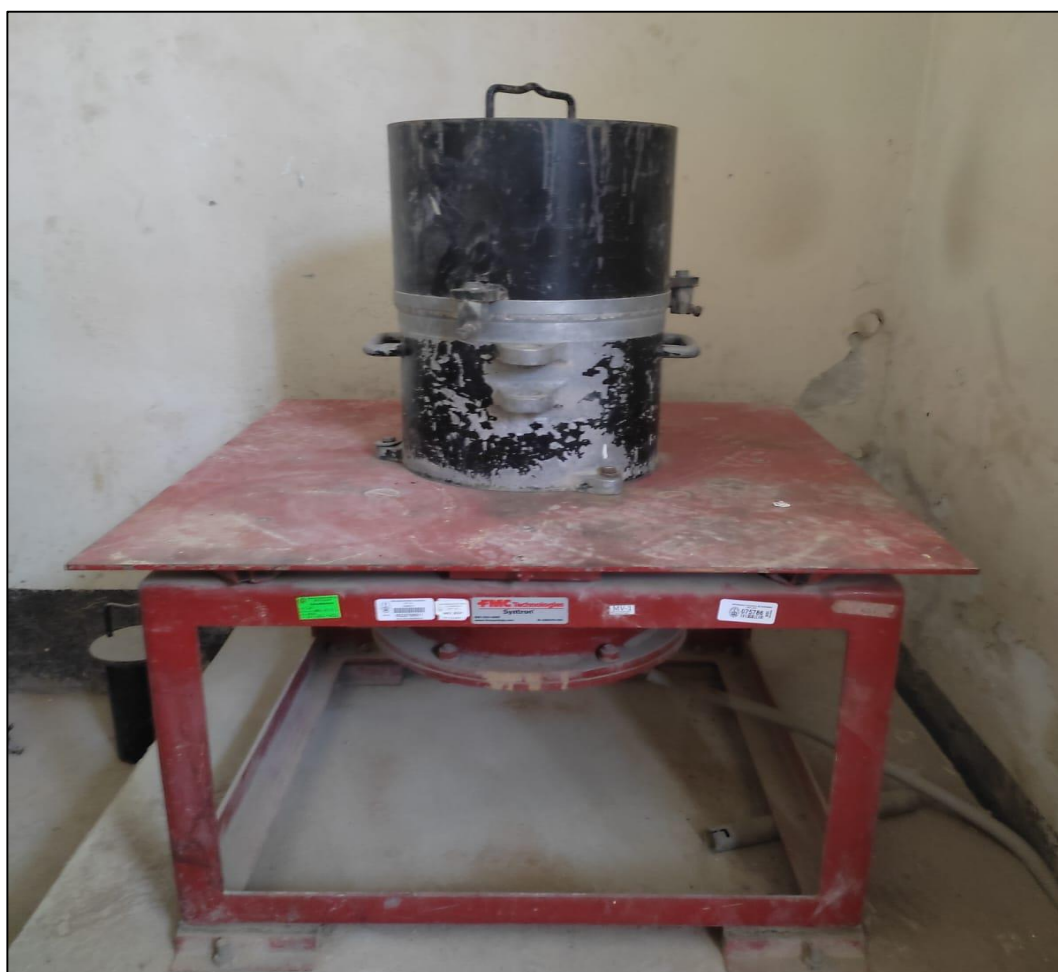
Figura 76. Fotografía del cilindro graduado sobre la mesa vibratoria.
