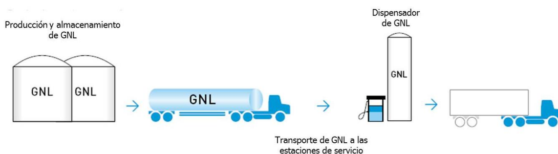
Figura 54 Suministro de Gas Natural Licuado
