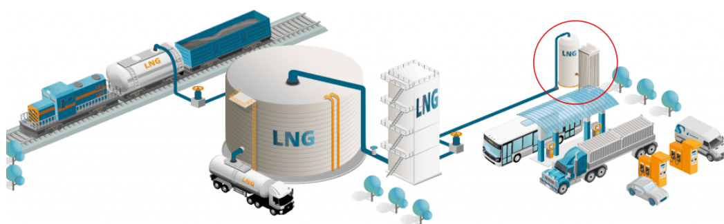
Figura 58 Tanque o depósito de almacenamiento de GNL
