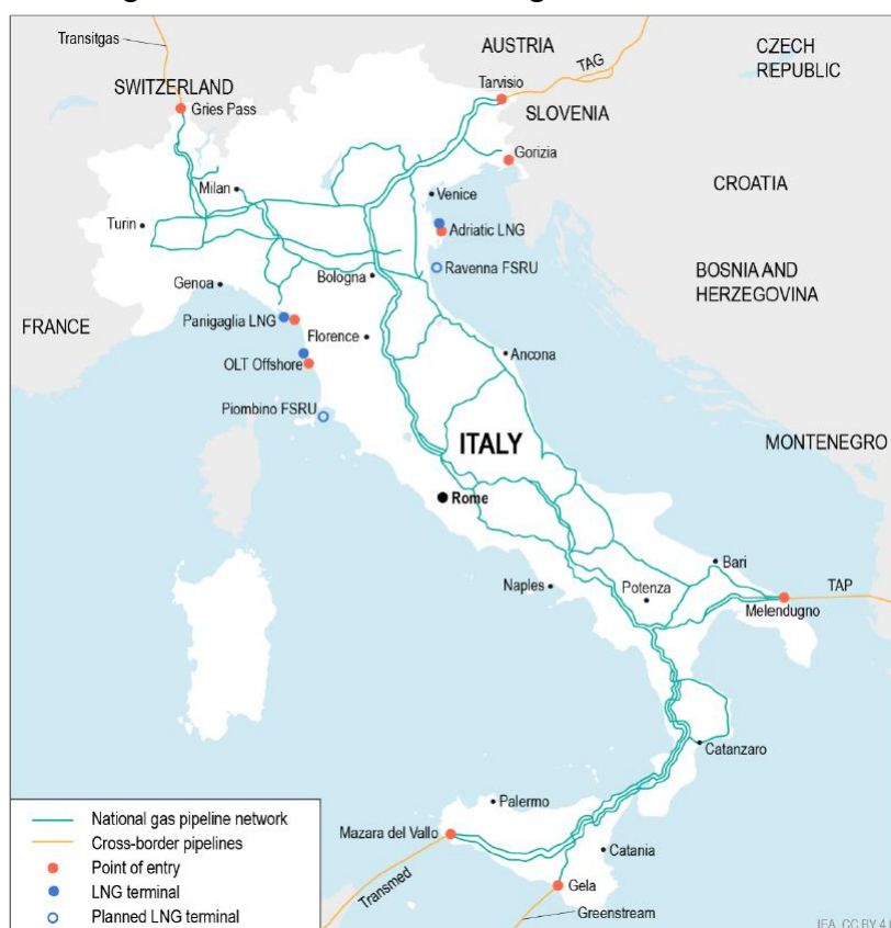
Figura 35 Infraestructura de gas natural
