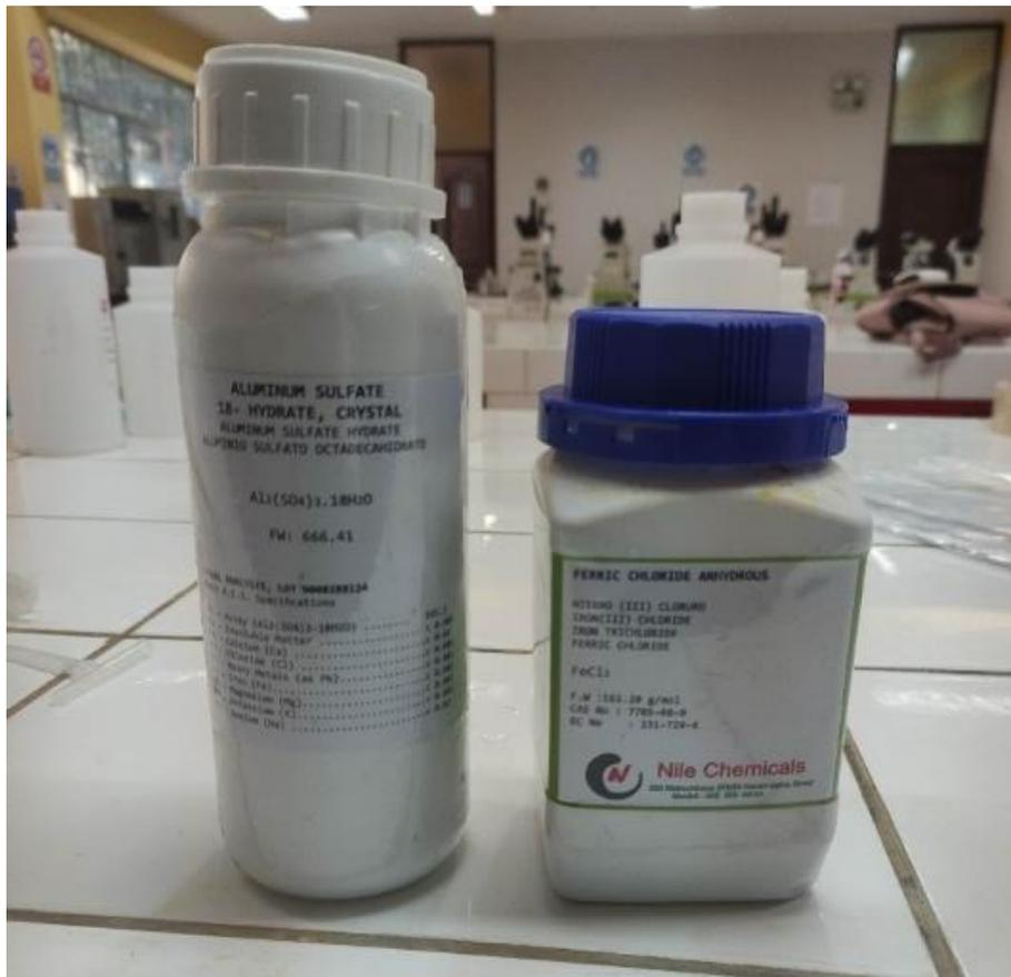
*Fotografía 9: Preparación de coagulantes y floculante*
