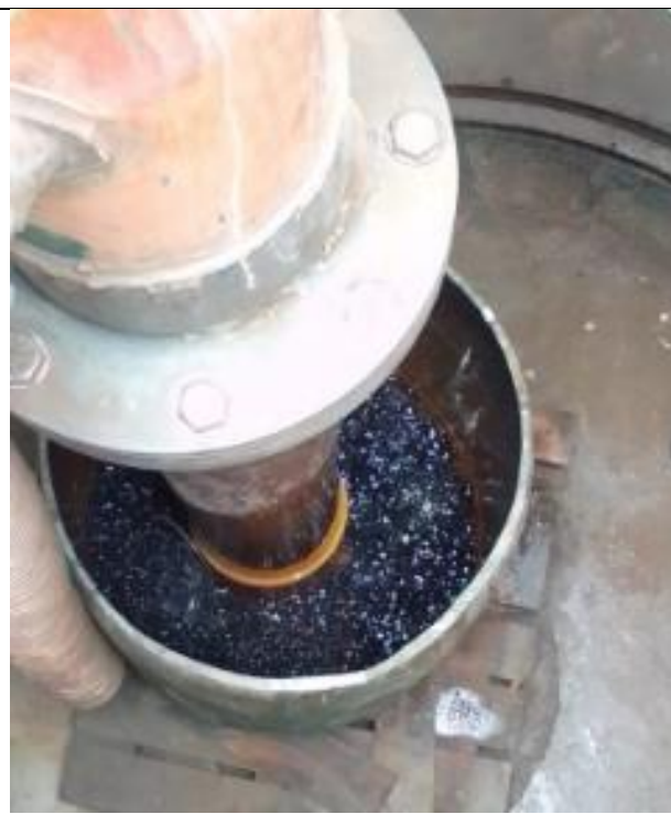
Fig. 02. Suministro de viruta metálica
