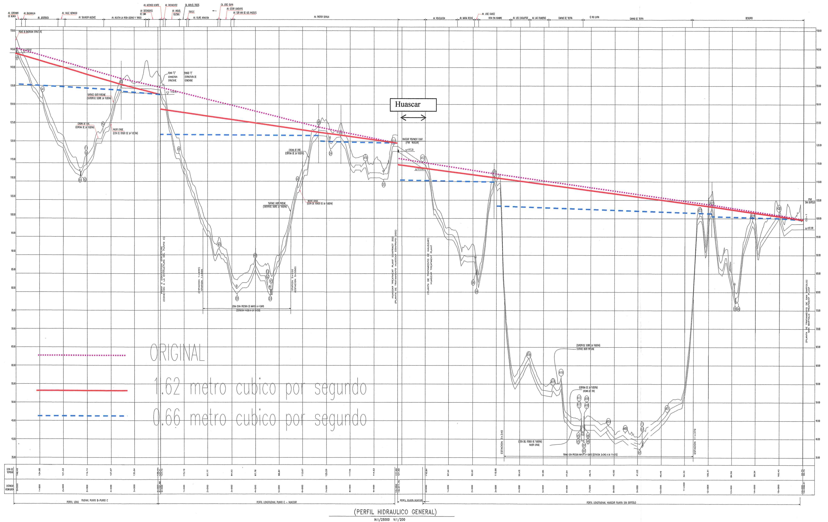
Fig. 2.2 Perfil Longitudinal de la Línea de Conducción
