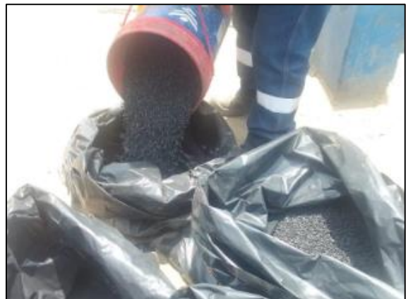
Nota2: Eliminación de carbón activado gastado
